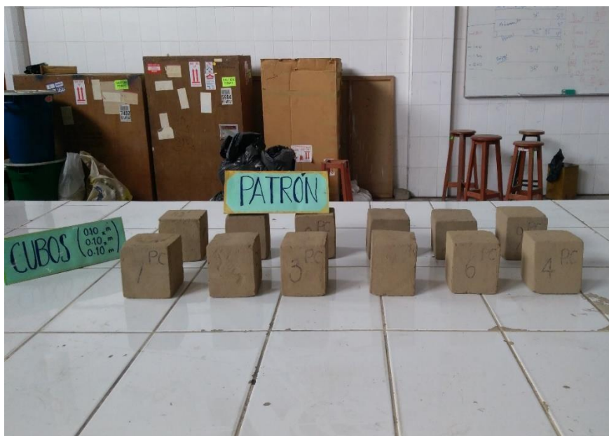
Imagen 29: Cubos de adobe de 10x10x10 cm para ensayo a compresión.
