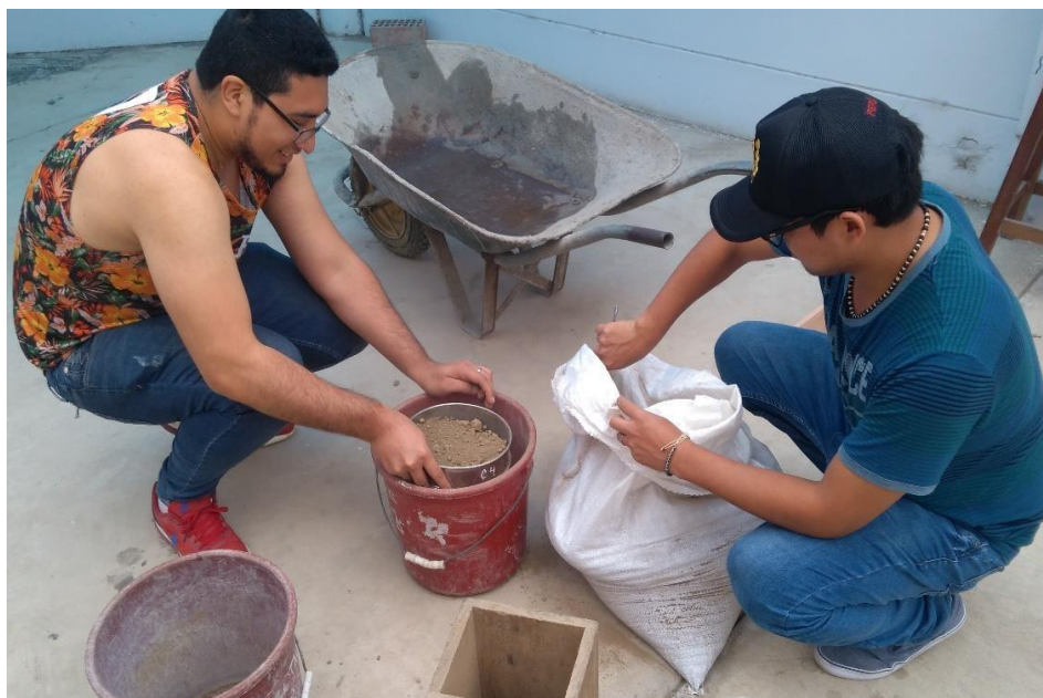
Imagen 11: Proceso del zarandeo de la tierra por el Tamiz N°10.
