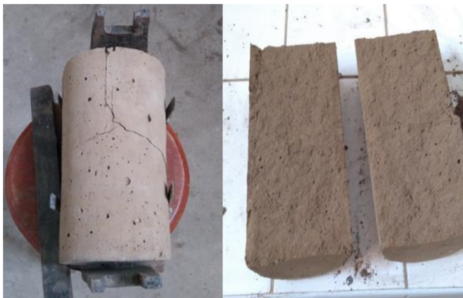
Imagen 36: Ensayo a la tracción de probetas “patrón” (15x30 cm).
