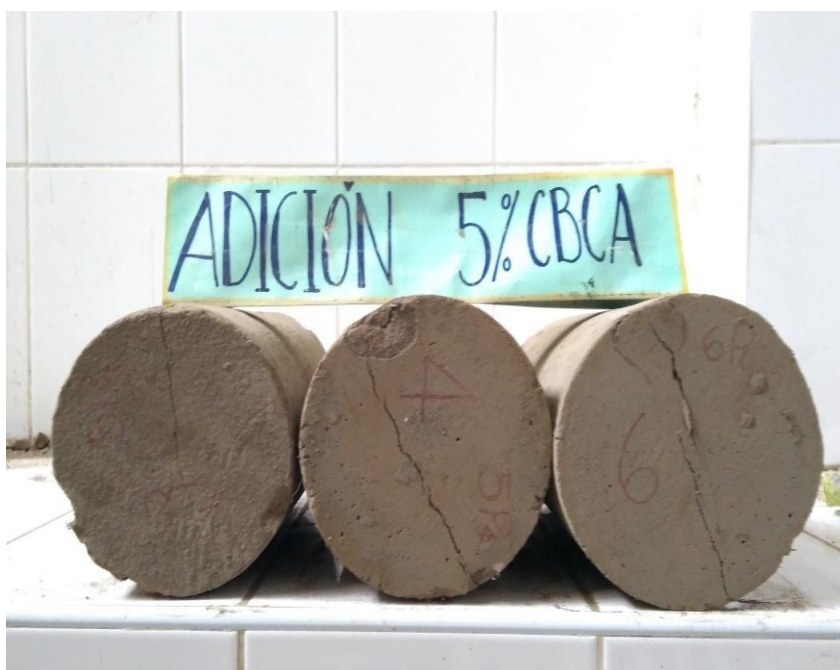
Imagen 37: Ensayo a la tracción de probetas (15x30 cm) con 5% de CBCA.
