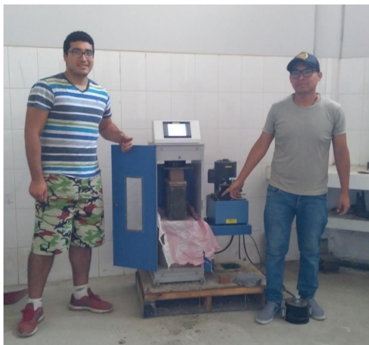
Imagen 30: Prensa utilizada para los ensayos a compresión y tracción.
