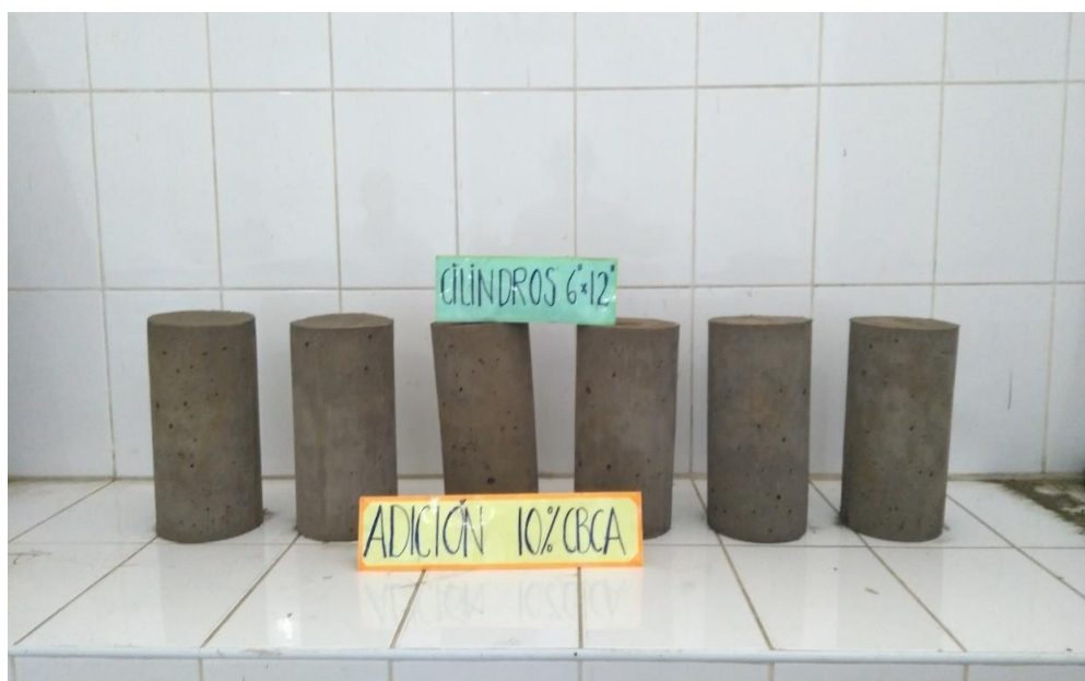
Imagen 28: Probetas de adobe de 15x30cm con adición de 10% de CBCA.
