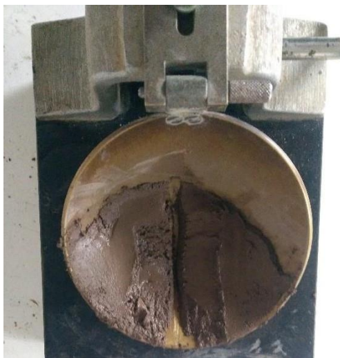
Figura 10. Cálculo del Limite Liquido con la Copa de Casagrande.
