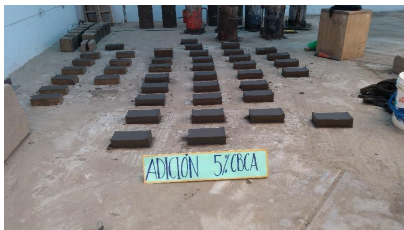
Figura 28: Secado de las unidades de adobe con 5% de CBCA
