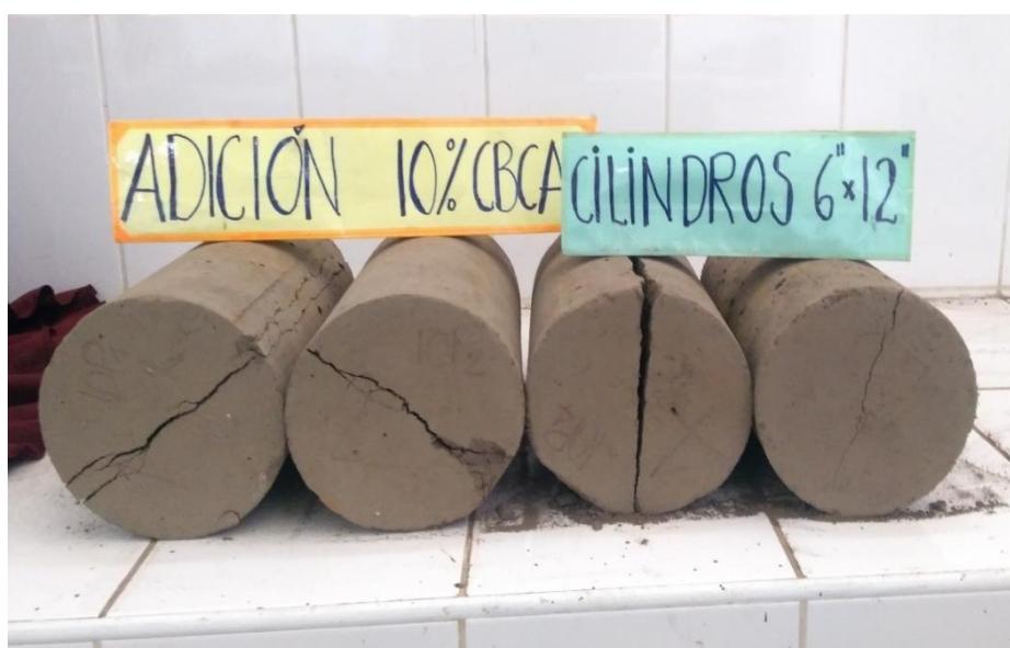
Imagen 38: Ensayo a la tracción de probetas (15x30 cm) con 10% de CBCA.
