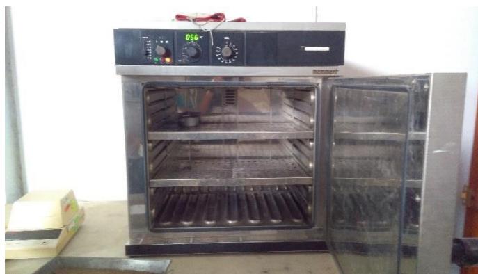
Figura 8. Muestra colocada en el horno para prueba de contenido de humedad.
