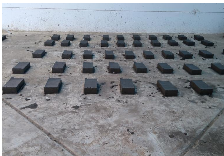
Figura 15: Secado de los bloques de adobe.
