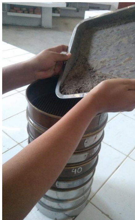
Figura 9. Proceso de tamizado para el ensayo de granulometría.
