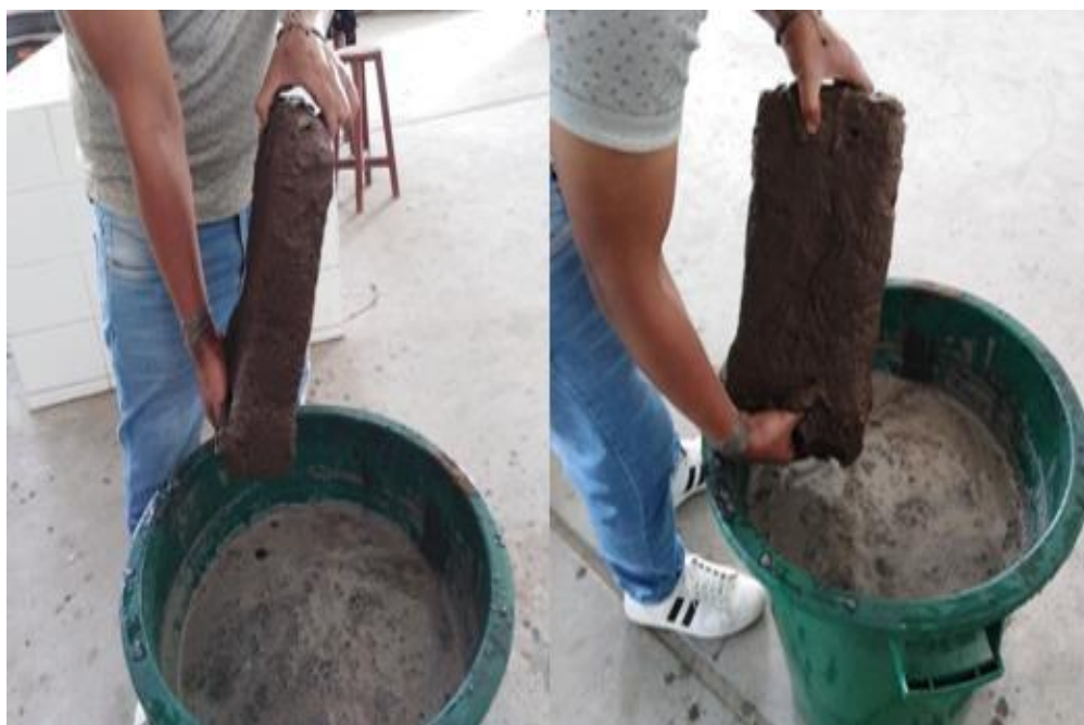
Imagen 43: Estado del bloque de adobe “patrón” luego de 30 minutos sumergido en agua.
