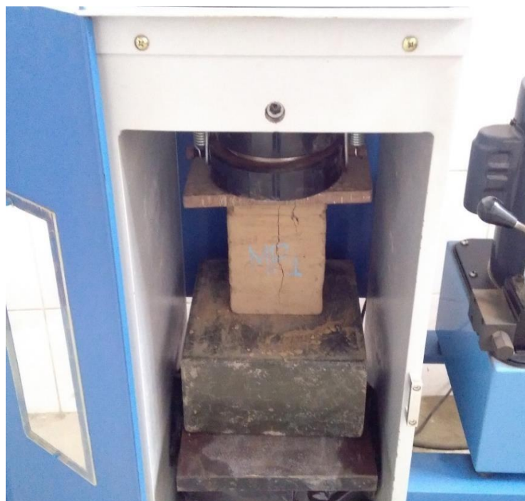
Imagen 39: Ensayo a la compresión de muretes.
