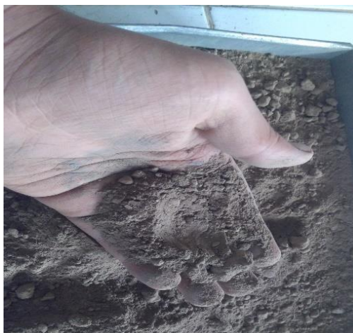
Figura 3. Realizando la prueba de color del suelo
