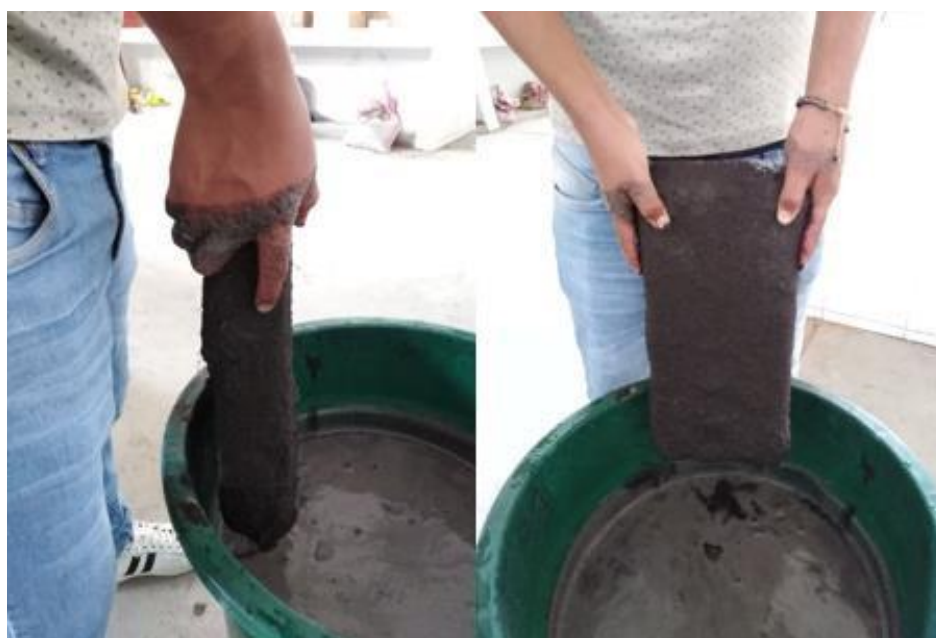
Imagen 44: Estado del bloque de adobe con 15% de CBCA luego de 30 minutos sumergido en agua.
