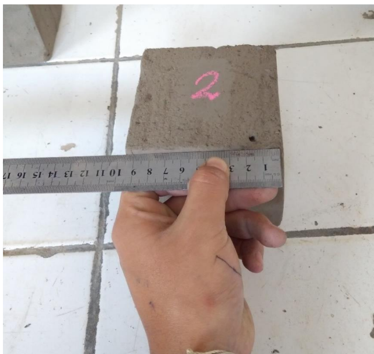
Imagen 25: Medida de las longitudes para variación dimensional.
