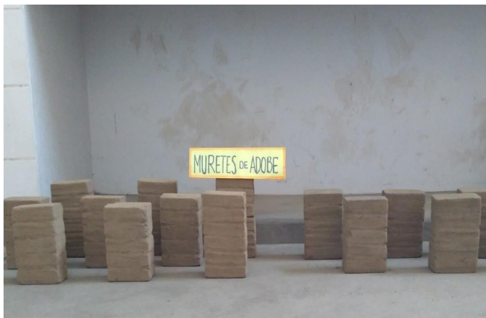
Imagen 26: Muretes de adobe para ensayo a compresión.
