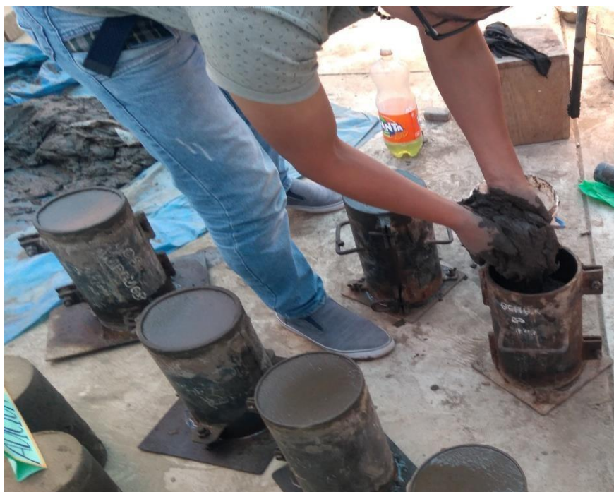
Imagen 21: Moldeo y desmoldeo de probetas de adobe.
