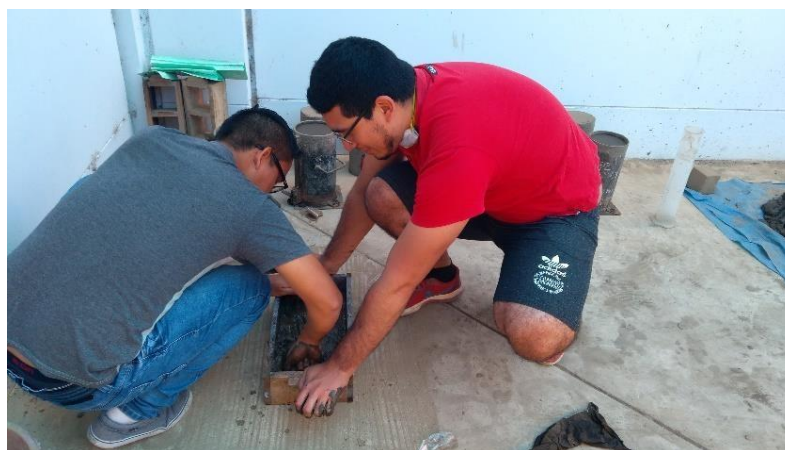
Figura 14: Moldeado de los bloques de Adobe
