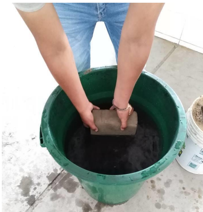
Figura 32: Inmersión en agua del Adobe Patrón .
