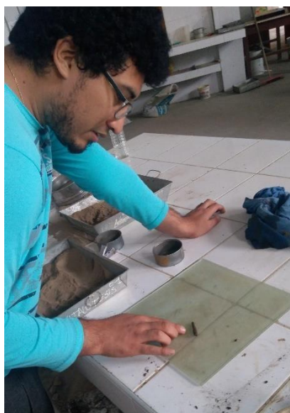
Figura 11. Elaboración de rollitos para cálculo de Limite Plástico
