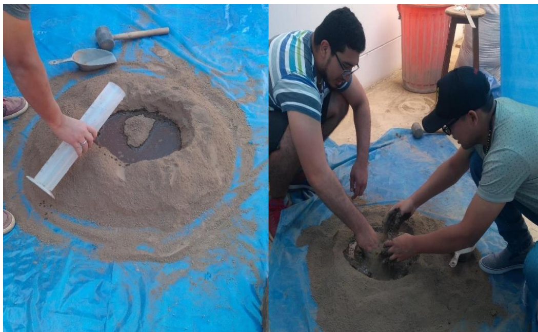
Imagen 12: Hidratación y mezclado de la tierra para la elaboración de la mezcla.
