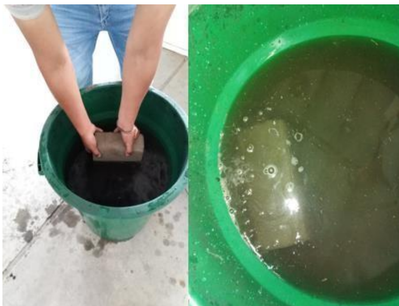
Imagen 42: Ensayo de absorción a los bloques de adobe.
