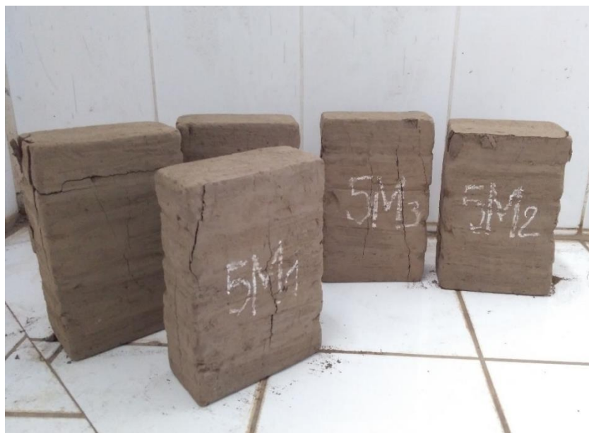
Imagen 40: Falla de muretes después del ensayo a la compresión.
