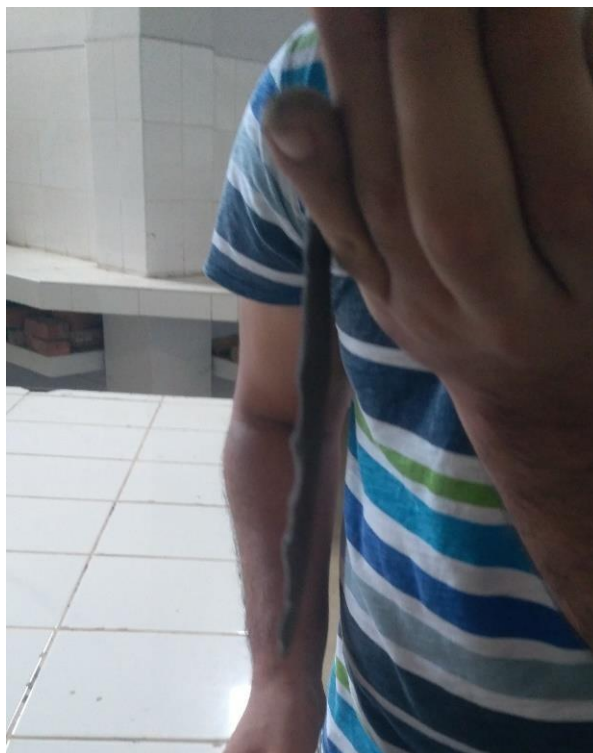
Imagen 08: Prueba de cinta de barro.
