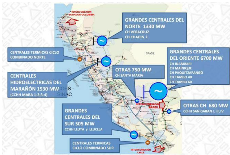
FIGURA N°2: Proyectos de Generación a Largo Plazo
