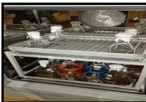
Figura 15. Agitador Shaker con Matraces. Se observa los matraces de 500 mL con el medio y el agua de curtiembre ya preparados.
