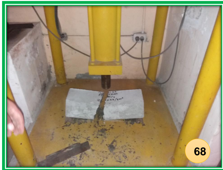
FOTO N°68: vigas rotas por la mitad
