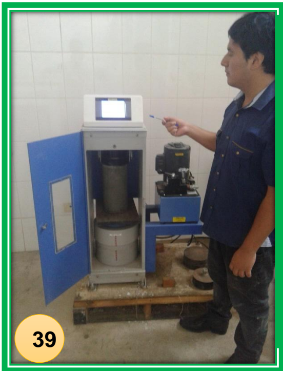
FOTO N°37 y 38: Ensayo de compresión de del concreto patrón a los 7 días de curado
