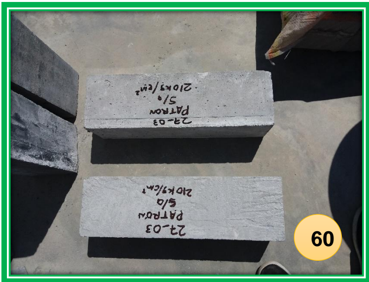
FOTO N°60 y 61: Vigas fuera de la poza listo para ser ensayados a los 28 días.
