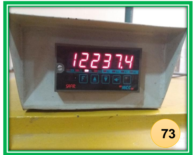
FOTO N°72 y 73: Ensayo a la flexión con la sustitución del 5% del cemento por ceniza de bagazo de caña de azúcar a los 28 días de curado
