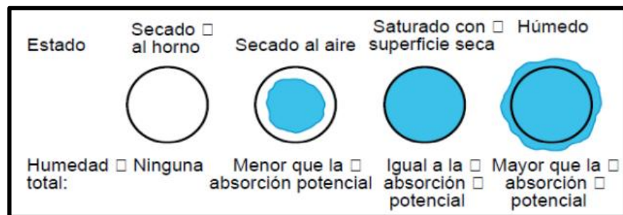
Figura 10: Condiciones de humedad de los agregados.
