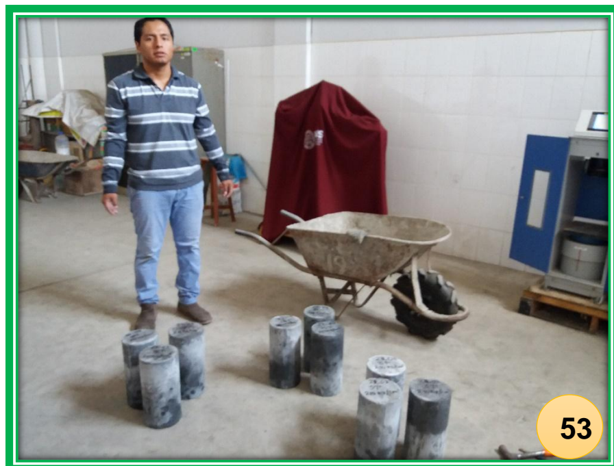
FOTO N°53: Probetas fuera de la poza para realizar la prueba de compresión
