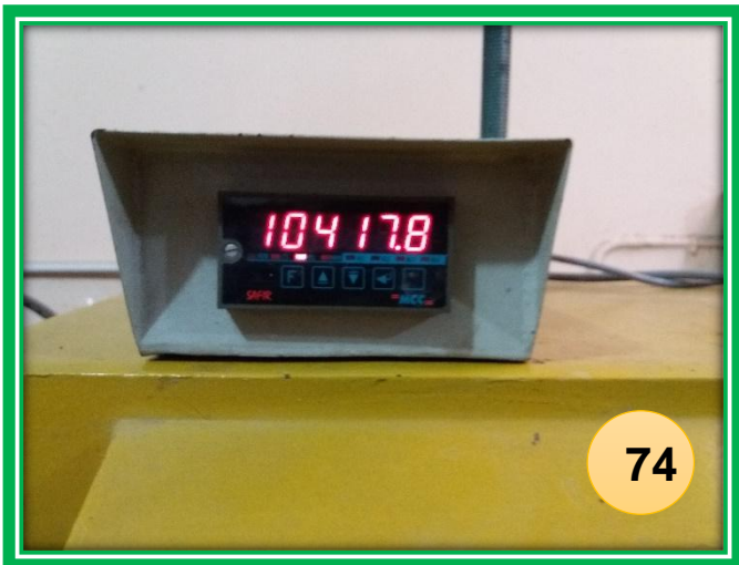
FOTO N°74 y 75: Ensayo a la flexión con la sustitución del 10% del cemento por ceniza de bagazo de caña de azúcar a los 28 días de curado
