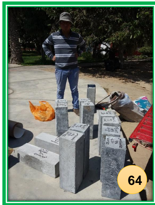
FOTO N°64: Vigas fuera de la poza listo para ser ensayados a los 28 días
