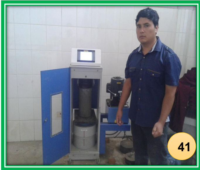
FOTO N°41 y 42: Ensayo de compresión de la sustitución del 5% del cemento por ceniza de bagazo de caña de azúcar a los 7 días de curado
