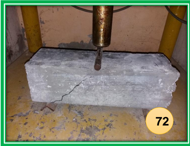
FOTO N°72 y 73: Ensayo a la flexión con la sustitución del 5% del cemento por ceniza de bagazo de caña de azúcar a los 28 días de curado
