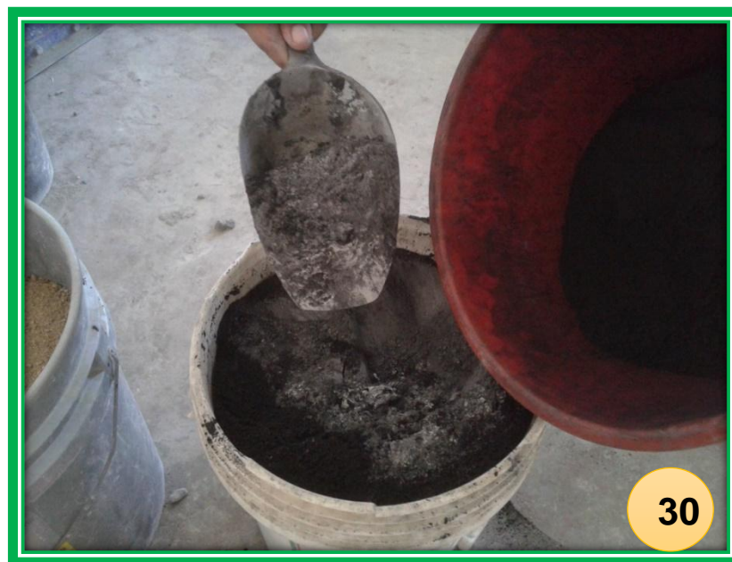
FOTO N°30: Unión del cemento y ceniza de bagazo de caña de azúcar según las dosificaciones del tipo de concreto
