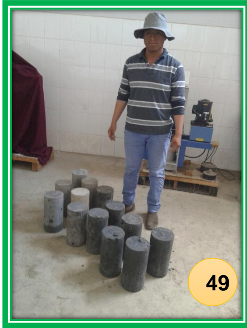
FOTO N°49: Probetas luego de haber realizado la rotura
