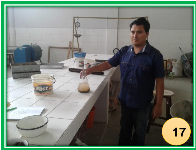
FOTO N°17 y 18: Peso del frasco volumétrico con agua y agregado fino
