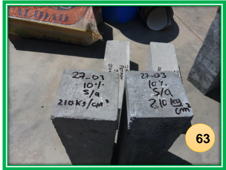
FOTO N°62 y 63: Vigas fuera de la poza listo para ser ensayados a los 28 días
