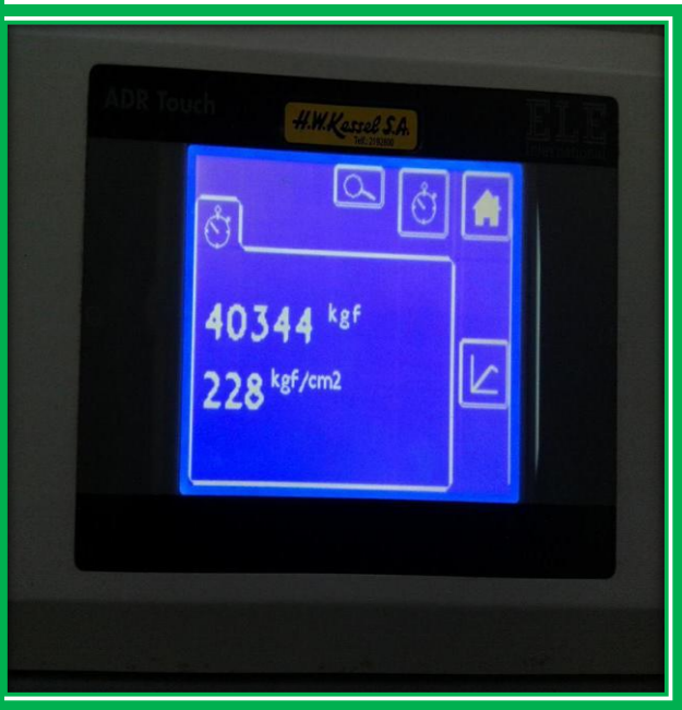
FOTO N°37 y 38: Ensayo de compresión de del concreto patrón a los 7 días de curado
