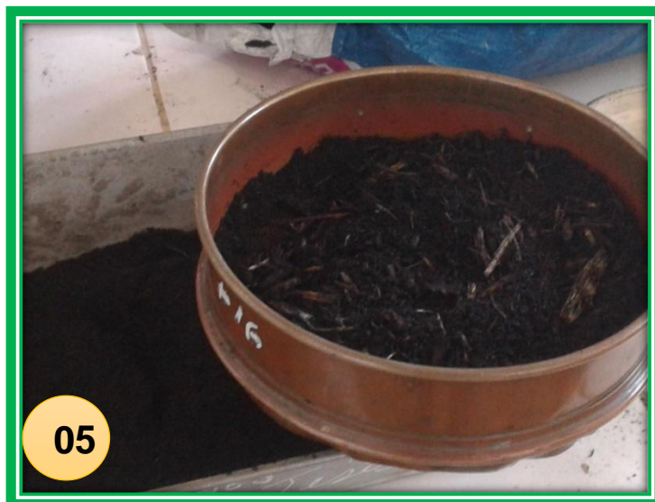
FOTO N°05: En un inicio se tamizó por la malla N° 10, para eliminar todo tipo de paja
