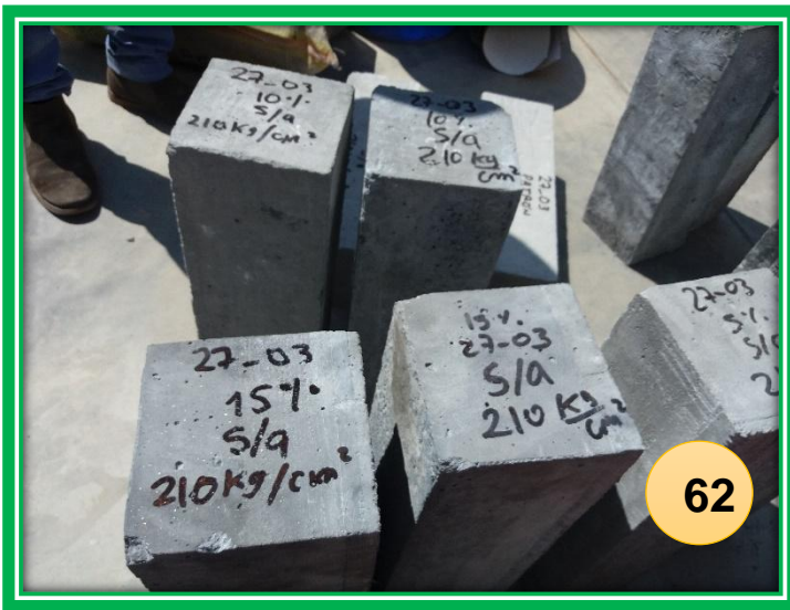
FOTO N°62 y 63: Vigas fuera de la poza listo para ser ensayados a los 28 días
