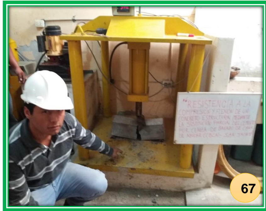
FOTO N°67: Ensayo a la flexión con la sustitución del 10% del cemento por ceniza de bagazo de caña de azúcar a los 28 días de curado
