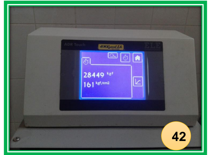
FOTO N°41 y 42: Ensayo de compresión de la sustitución del 5% del cemento por ceniza de bagazo de caña de azúcar a los 7 días de curado
