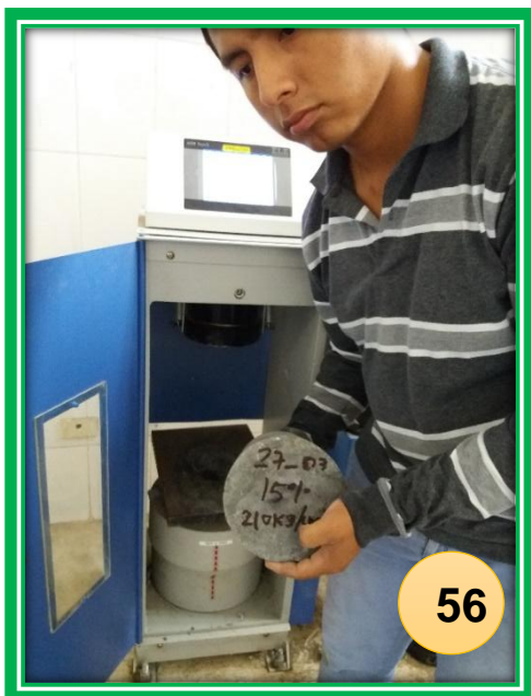
FOTO N°56 y 57: Ensayo de compresión de la sustitución del 15% del cemento por ceniza de bagazo de caña de azúcar a los 28 días de curado
