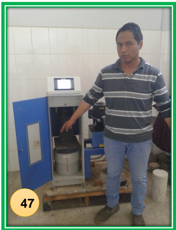
FOTO N°45 y 46: Ensayo de compresión de la sustitución del 10% del cemento por ceniza de bagazo de caña de azúcar a los 7 días de curado
