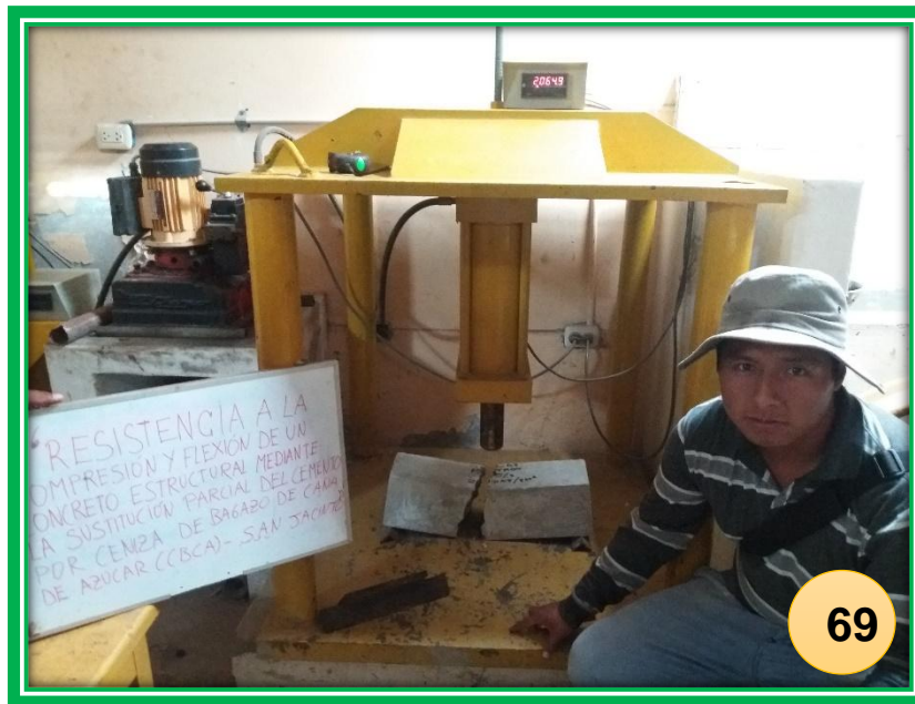
FOTO N°69: Ensayo a la flexión con la sustitución del 15% del cemento por ceniza de bagazo de caña de azúcar a los 28 días de curado
