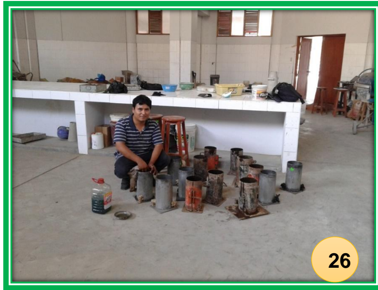
FOTO N°26: Limpieza de las probetas para realizar el vaciado
