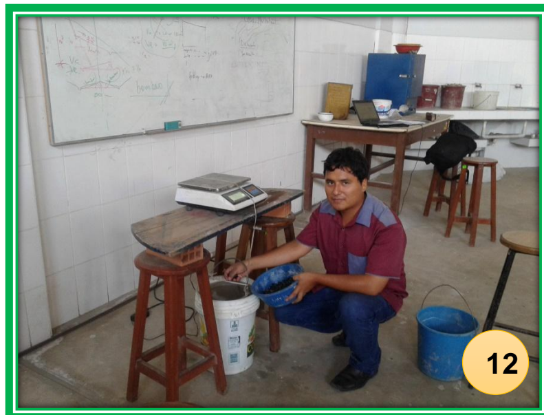
FOTO N°12: Se halló el peso específico del agregado grueso
