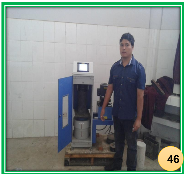
FOTO N°45 y 46: Ensayo de compresión de la sustitución del 10% del cemento por ceniza de bagazo de caña de azúcar a los 7 días de curado
