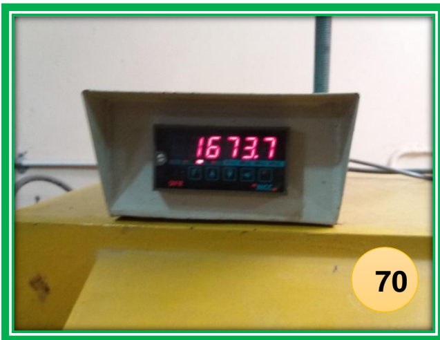
FOTO N°70 y 71: Ensayo a la flexión con la sustitución del 15% del cemento por ceniza de bagazo de caña de azúcar a los 28 días de curado
