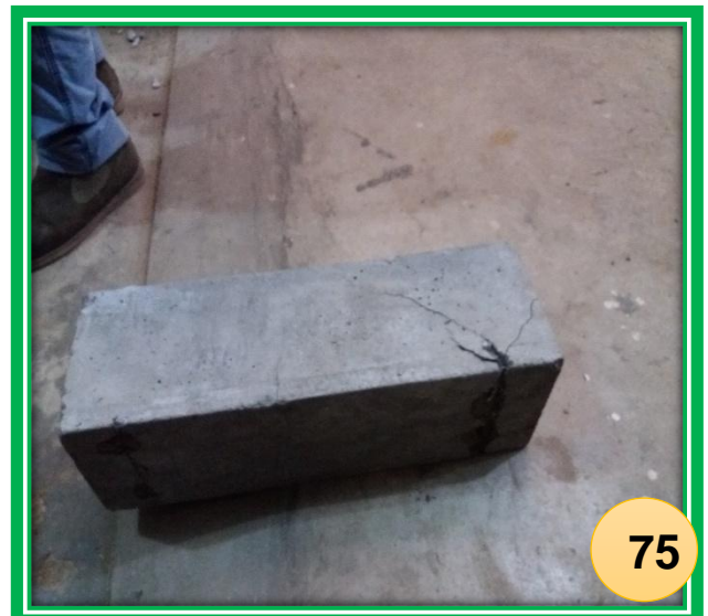
FOTO N°74 y 75: Ensayo a la flexión con la sustitución del 10% del cemento por ceniza de bagazo de caña de azúcar a los 28 días de curado
