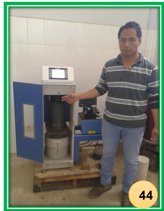
FOTO N°41 y 42: Ensayo de compresión de la sustitución del 5% del cemento por ceniza de bagazo de caña de azúcar a los 7 días de curado
