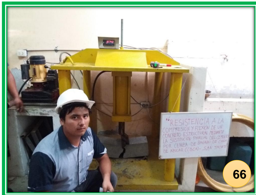
FOTO N°66: Ensayo a la flexión con la sustitución del 5% del cemento por ceniza de bagazo de caña de azúcar a los 28 días de curado
