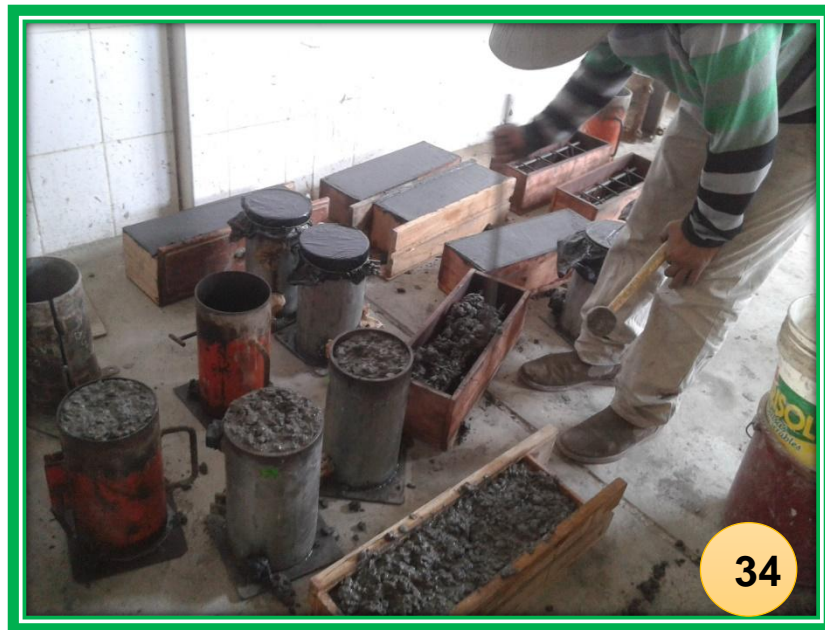
FOTO N°34: Chuseo respectivo de las probetas y vigas
