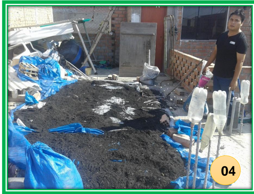
FOTO N°04: Secamos al aire seco la ceniza de bagazo de caña de azúcar, para poder fácilmente eliminar los restos orgánicos que contenía la caña.
