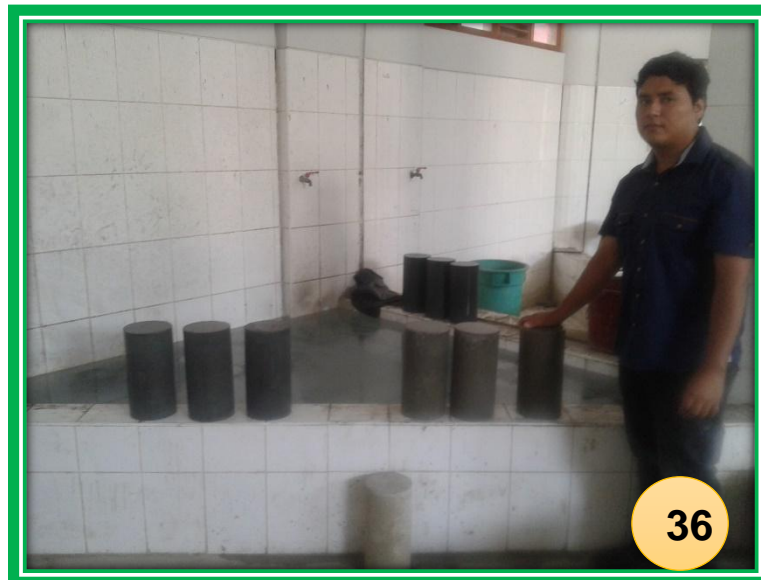
FOTO N°36: Retiro de las probetas de la poza para poder realizar las roturas a los 7, 14, y 28 días respectivamente
