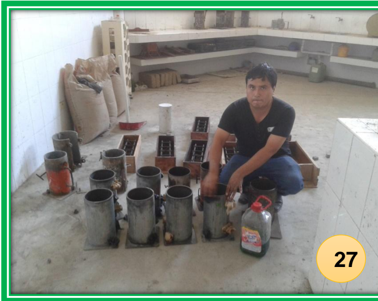
FOTO N°27 y 28: vigas y probetas aptas para el vaciado
