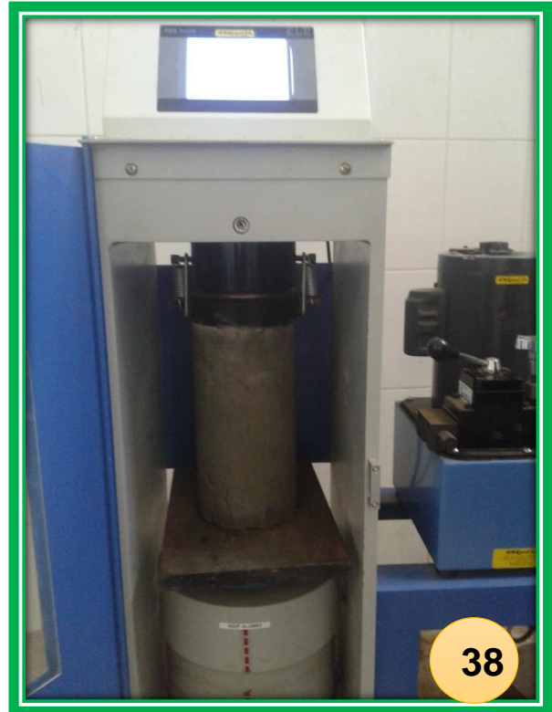
FOTO N°37 y 38: Ensayo de compresión de del concreto patrón a los 7 días de curado
