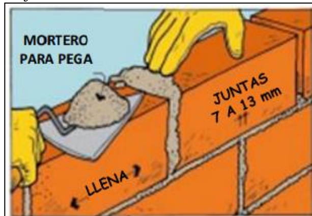
Figura 17. V. Baja. Calidad de las Juntas de Mezcla en Mortero
