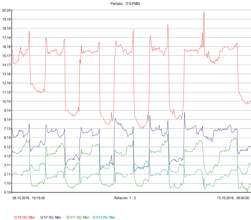
Grafico N° 15, Medición de la tasa de distorsión armónica individual de corriente (THDi I h5, h7, h11, h13) en %.
