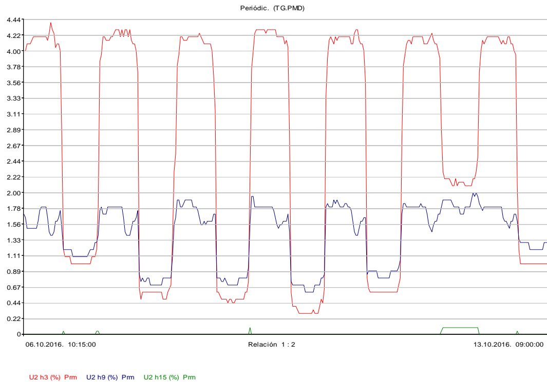
Figura N° 09 Medición de la tasa de distorsión armónica individual de tensión triplen (THDi U h3, h9, h15) en %.
