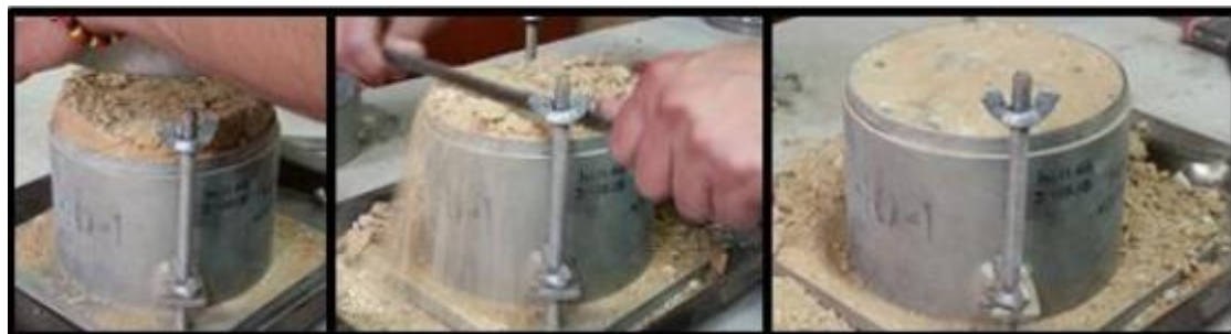
Figura 26: Enrasado de Muestras compactadas.
