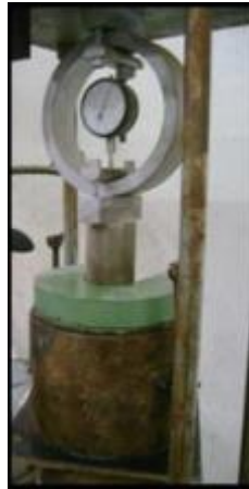
Figura 30: Penetración de CBR.
