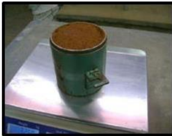
Figura 28: Peso de molde más suelo compactado.
