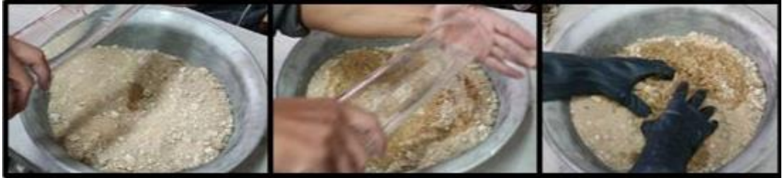
Figura 24: Amasado para encontrar humedad específica.
