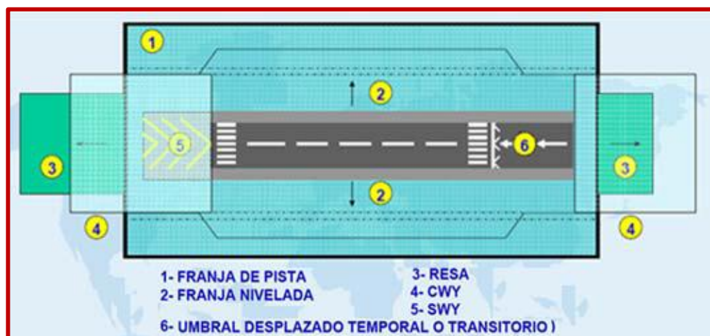
Figura 8. Componentes físicos de una Pista de Aterrizaje
