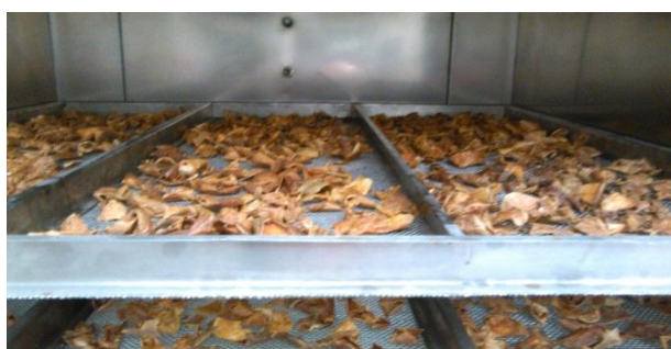
Figura 3: Secado de la cascara de Maracuyá.
