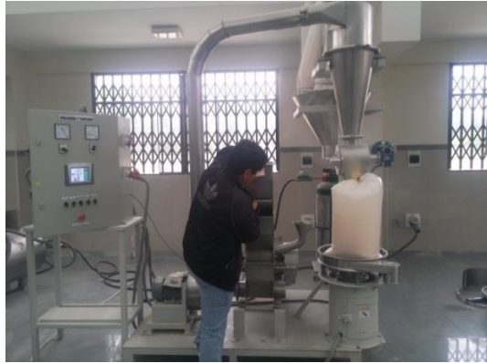
Figura 4: Molienda de la cascara de Maracuyá secada
