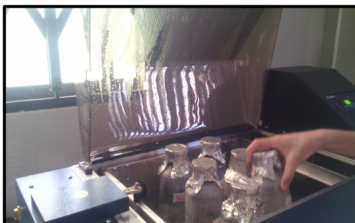
Figura 12. Muestras ingresando al baño maría para incubar a 95°C y evaluar la acción de la enzima amilasa.
