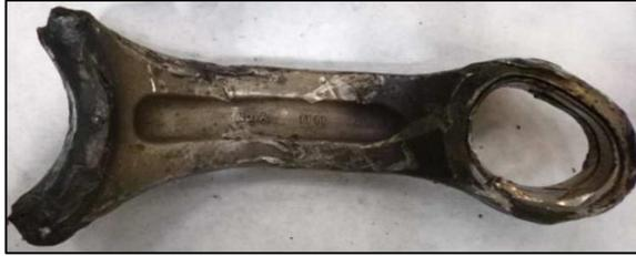
**Figura 4.16:** Cuerpo de biela 1R roto y sin la tapa severamente sobrecalentado.
