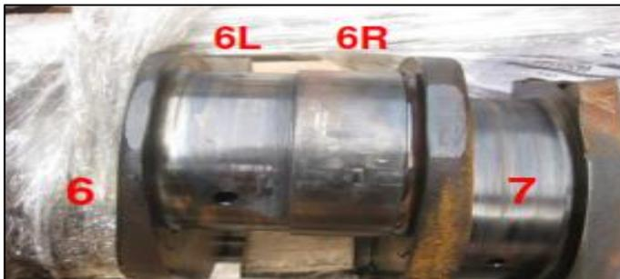
**Figura 4.18:** Los metales 6L y 6R se giraron, el metal 6L se muestra fundido en el puño del cigüeñal
