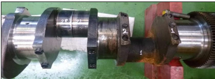
**Figura 4.15:** Puño de biela fundidos en la posición N°1, puño de bancada N°1 con poco daño y puño de bancada N°2 afectado
