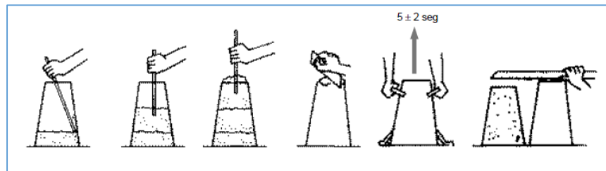
Figura 02. Procedimiento para el asentamiento del concreto fresco
