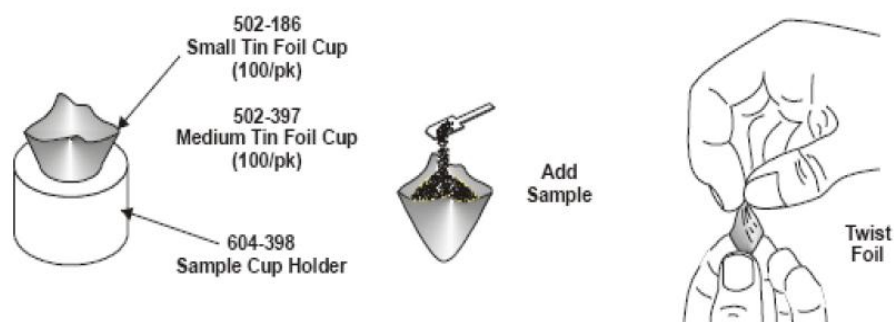
Figura 6. Pesado de la muestra en una lámina de estaño, LECO Corporation.
