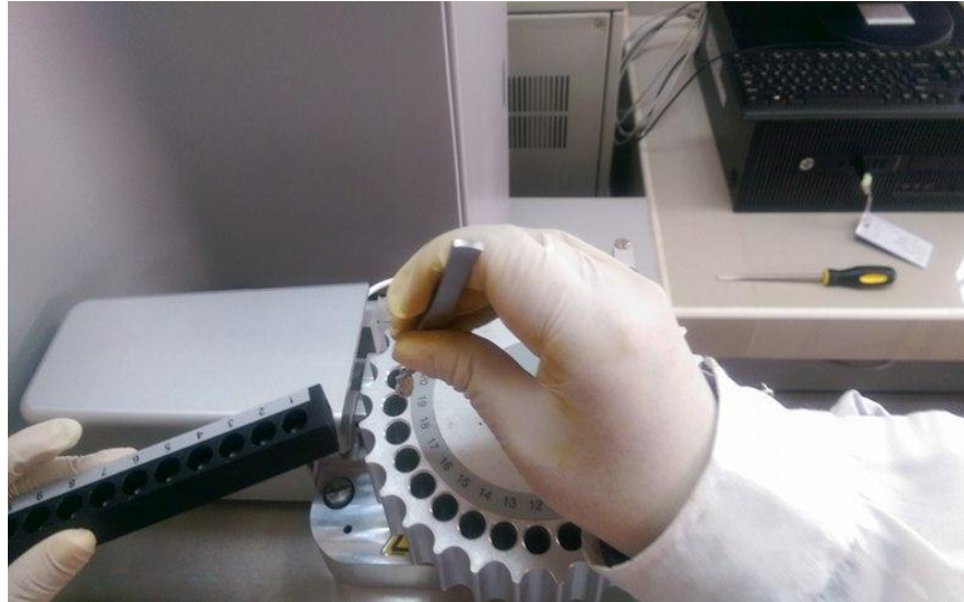
Figura 27. Carga de muestra en el cabezal del Analizador CHNS628.
