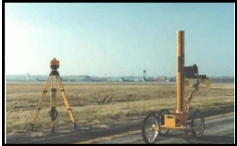
FIGURA 2. 17. EQUIPO DE ALTA PRECISIÓN MIRA Y NIVEL Y TRRL BEAM.
