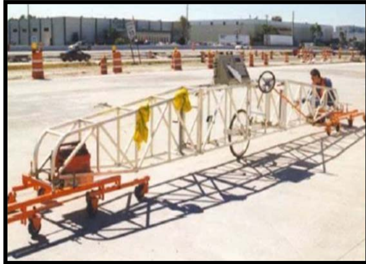
FIGURA 2. 18. PERFILÓMETROS DE ALTA VELOCIDAD SON EL APL TRÁILER Y GMR TYPE INERTIAL PROFILOMETER.
