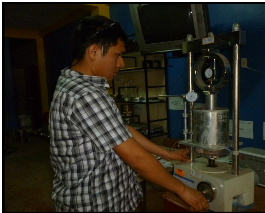
FOTO N°06: Determinación de la resistencia a la penetración mediante el uso de la prensa C.B.R.
