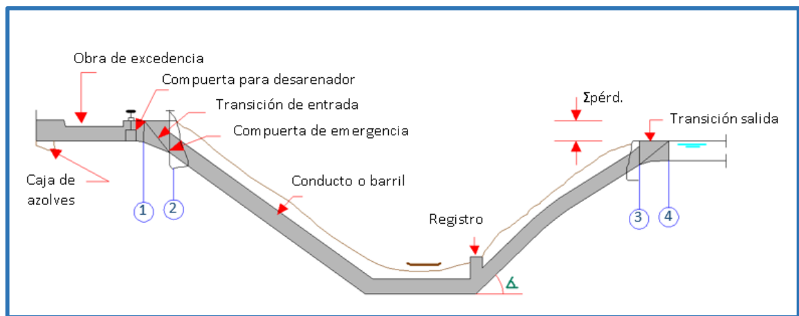
Figura 14: Elementos de un sifón invertido.
