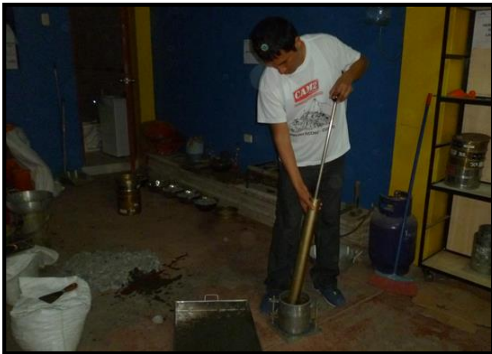
FOTO N° 02: Ensayo de proctor modificado.
