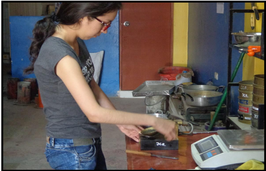
FOTO N° 05: Ensayo de Límite Líquido
