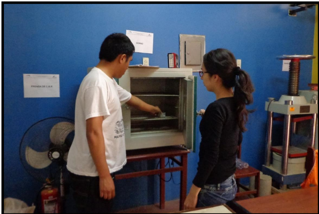
FOTO N°04: Colocación de muestra en horno eléctrico.
