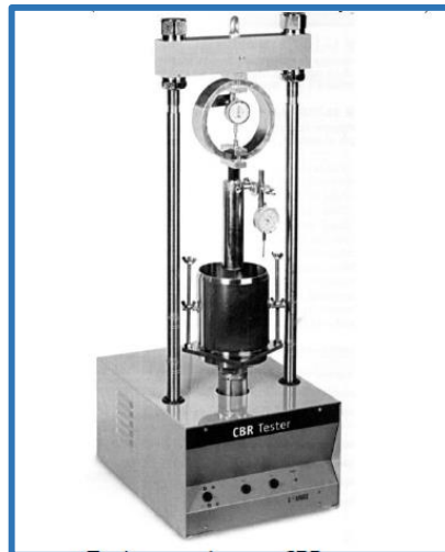
Figura 7: Equipo para el ensayo CBR
