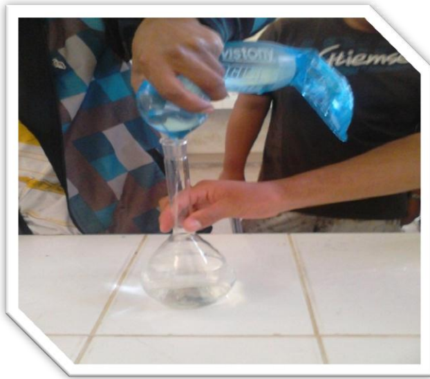
Foto 5: Agregando agua destilada a la fiola para el procedimiento de la densidad relativa del agregado fino.
