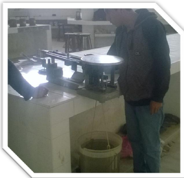
Foto 10: Procedimiento para determinar la densidad relativa del agregado (NTP 400 021)
