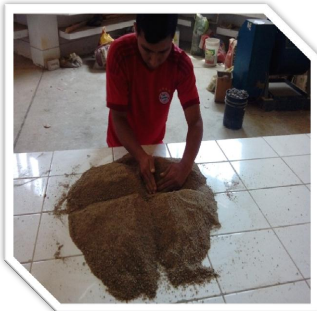
Foto 2: Realización de la práctica estándar de reducción de muestras para el agregado fino.
