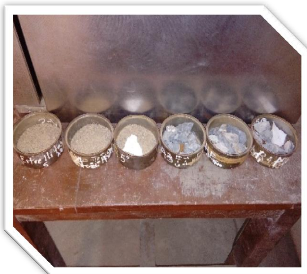
Foto 6: Muestras previa colocación en el horno para el método estándar para hallar el contenido de humedad en agregado grueso.
