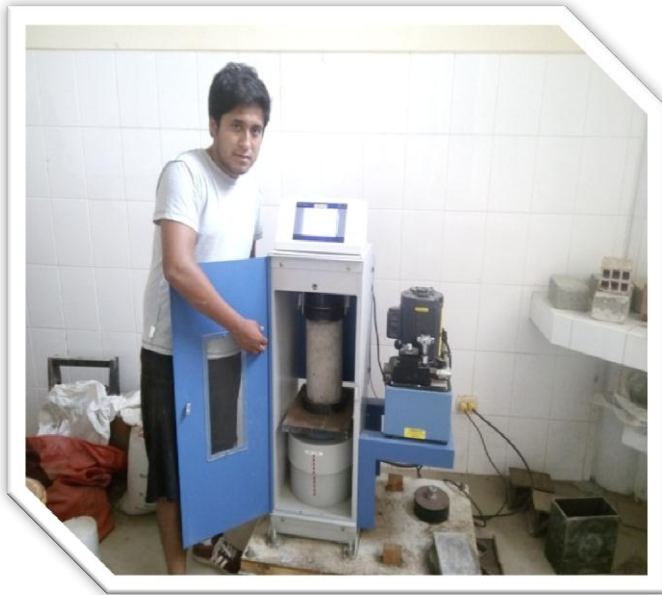
Foto 18: Realización del ensayo de la rotura a la compresión.
