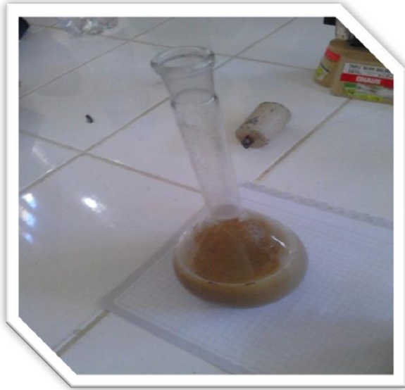
Foto 7: Peso de fiola + agua + arena para determinar la densidad relativa del agregado fino.
