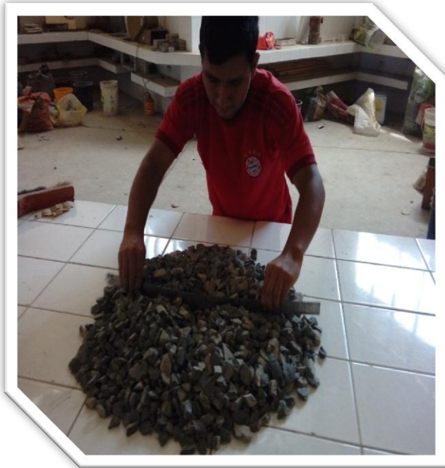
Foto 1: Realización de la práctica estándar de reducción de muestras para el agregado grueso.
