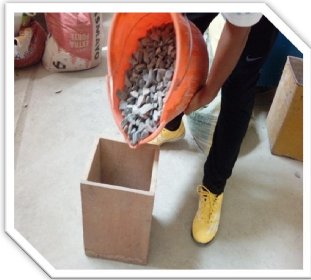
Foto 9: Uso del molde de madera para el ensayo donde se determina el peso unitario del agregado grueso, estado suelto y compactado.
