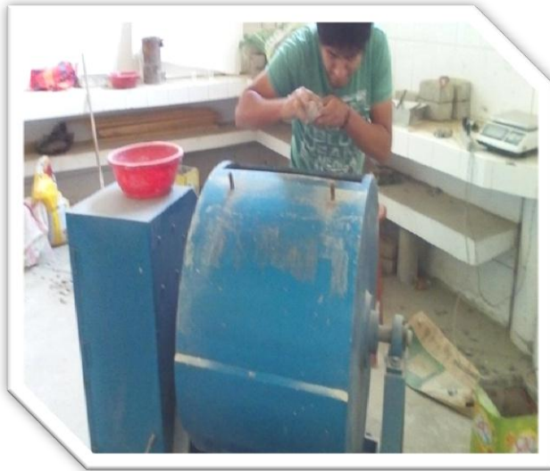
Foto 11: Realización de la prueba normal para la resistencia al desgaste por abrasión del agregado grueso.
