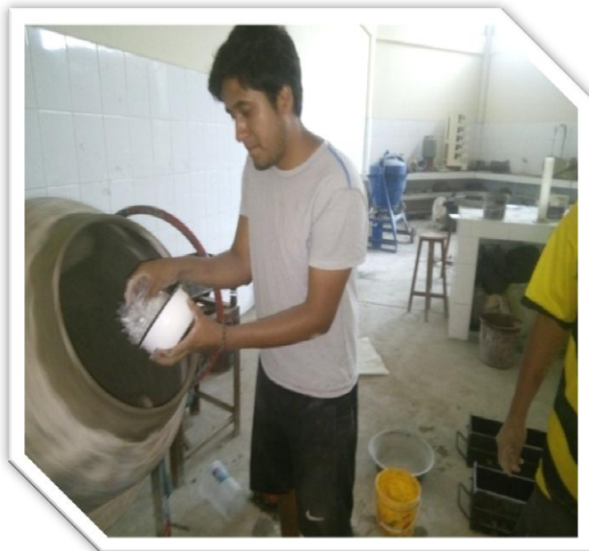
Foto 21: Siempre Adicionando la fibra al final de todos los elementos.
