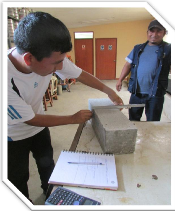
Foto 26: Medición de dimensiones para llenado de la hoja de cálculos.
