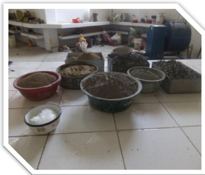
Foto 12: Alistando la dosificación en peso de los componentes del concreto previo mezclado en trompo.
