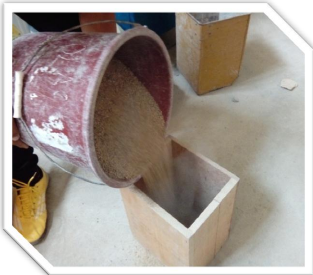
Foto 8: Uso del molde de madera para el ensayo donde se determina el peso unitario del agregado fino, estado suelto y compactado.
