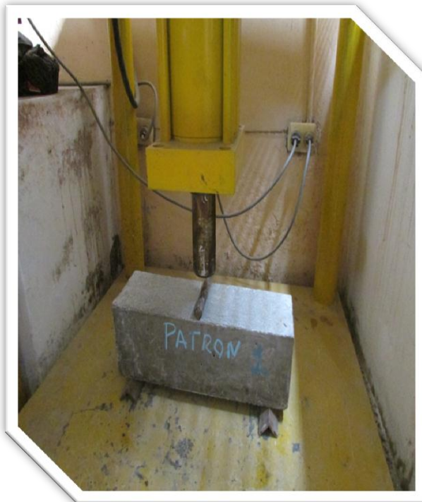
Foto 27: Colocación de viga para rotura mediante Metodo de la Viga Simple Cargada en el Punto Central.
