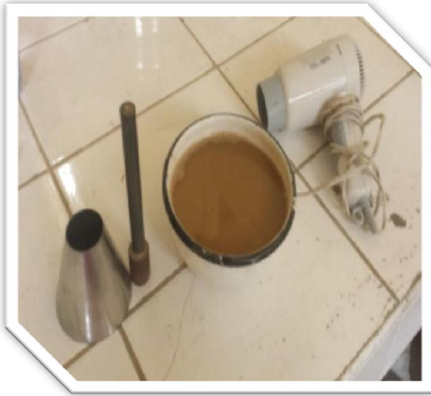
Foto 3: Alistado de materiales para el ensayo de la densidad relativa del agregado fino.
