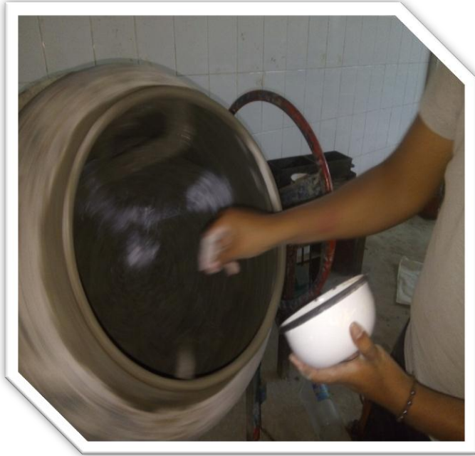
Foto 15: La fibra se agrega al último, y se espera 5 minutos antes de su colocación (recomendación del fabricante)
