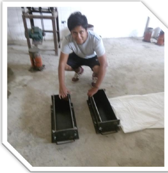
Foto 22: Los moldes de vigas deben estar limpios, además de pasarle por petróleo para evitar adherencia del concreto con el molde.
