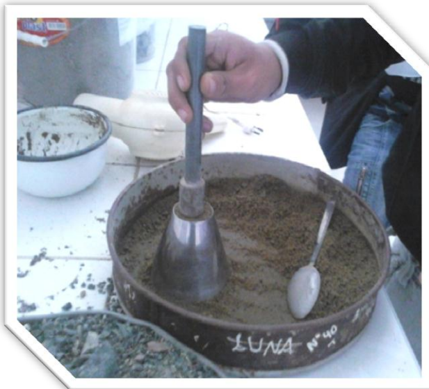
Foto 4: Procedimiento (NTP 400 022), para densidad relativa de agregado fino
