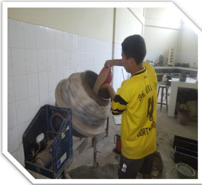
Foto 20: Realizando el mismo procedimiento de mezclado, ahora para la vigas.
