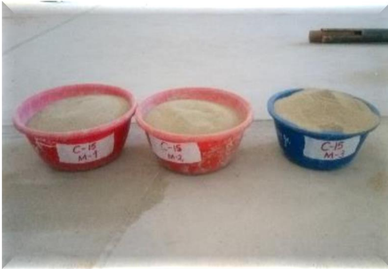
Foto N° 21: Se Observa las muestras para realizar el ensayo de Proctor Modificado
