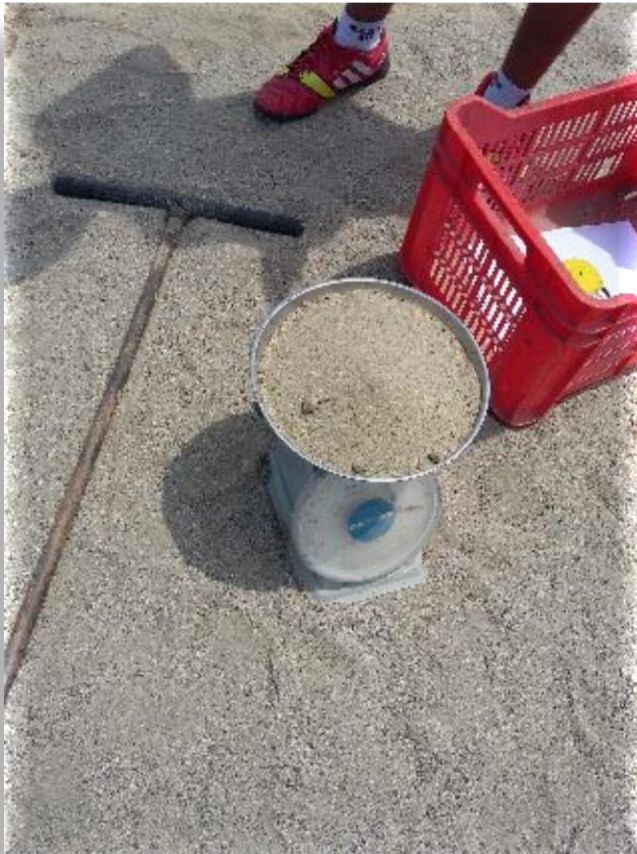
Foto N° 05: Pesado del Material natural como parte del ensayo de Densidad de Campo
