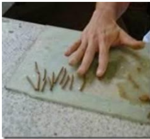
Figura N°17: Límite plástico. Límite de plasticidad. Civil Labs. (2010).
