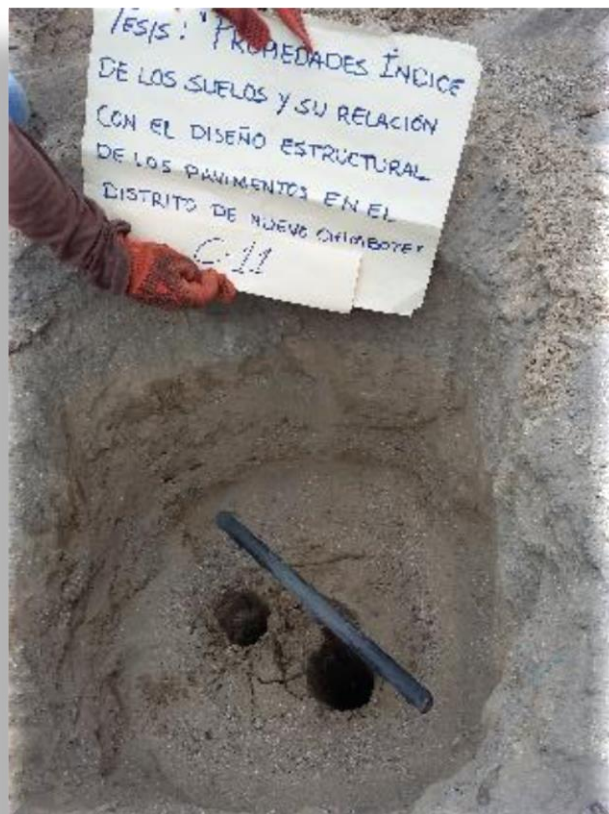
Foto N° 14: Toma de muestras mediante el uso del Barreno, para análisis y clasificación del suelo
