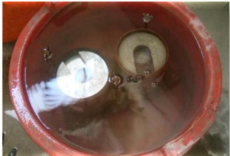
Foto N° 34: Muestras de CBR en saturación, para su posterior Penetración
