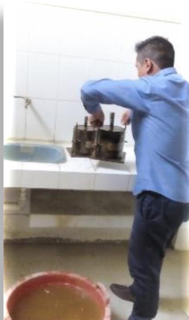
Foto N° 35: Se Observa a extracción de los moldes para someterlos a Penetración En la prensa de CBR
