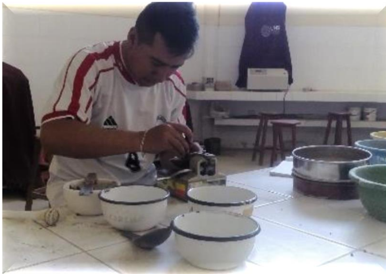
Foto N° 19: Imágenes realizando el Ensayo de Limite Liquido del terreno de Fundación de la zona de estudio
