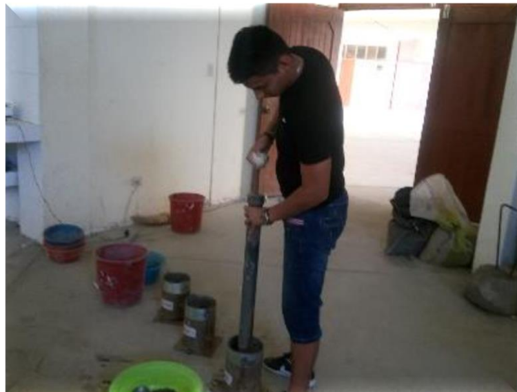
Foto N° 22: En la Imagen se observa realizando el ensayo de Proctor Modificado
