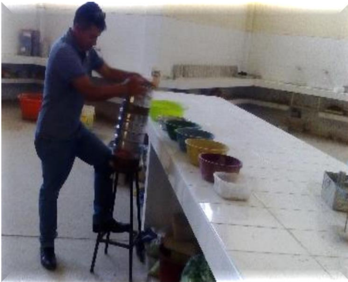
Foto N° 17: Se muestra el Ensayo Granulométrico por Tamizado en el Laboratorio
