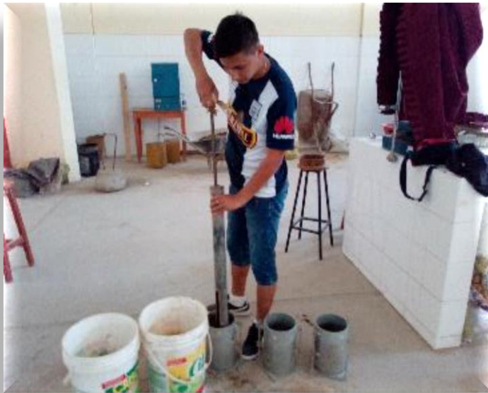
Foto N° 29: Ensayo CBR, 12 25 56 golpes.
