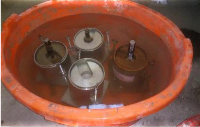
Foto N° 33: Muestras de CBR en saturación, para su posterior Penetración
