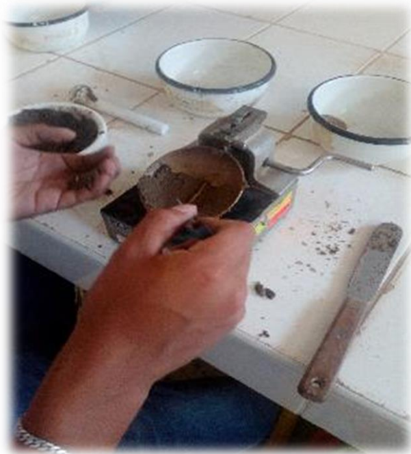
Figura N°16: Ensayo de Casagrande para determinar el Límite Líquido.
