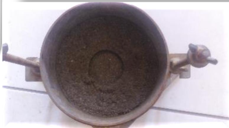
Foto N° 38: Moldes después del Ensayo de penetración en la Maquina de CBR
