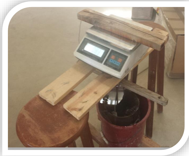
Foto13: Realizando el ensayo para determinar la densidad relativa del agregado grueso según la NTP 400.021.
