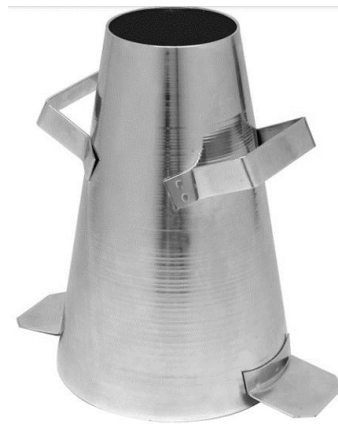
Figura 2.4. Cono de Abrams, material para el ensayo del asentamiento del concreto
