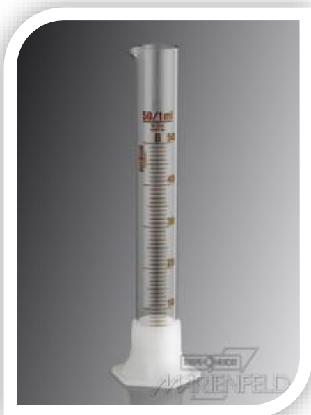
Foto12: Se muestra en la fotografía la probeta de 50 ml para el ensayo de densidad de los granos de caucho.
