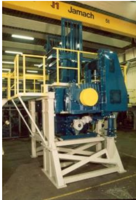
Figura 2.29. Máquina Jmach de 5 toneladas métricas por hora de capacidad de entrada.
