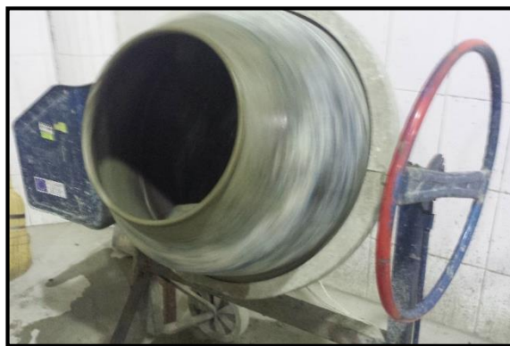
Figura 3.9. Concretera para la mezcla de concreto con FCR.
