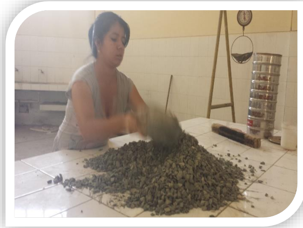
Foto1: Realizando la práctica estándar de reducción de muestras para el agregado grueso.
