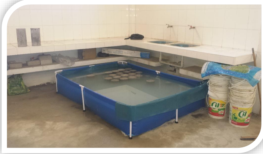
Foto18: Curado de las probetas en una piscina de agua con 2gr/lt de cal.
