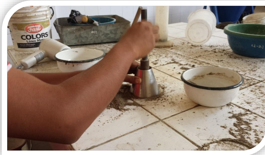
Foto5: Siguiendo el procedimiento del manual (NTP 400.022) para determinar la densidad relativa del agregado fino.
