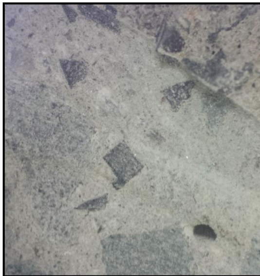
Fotografía 4.2. Interface entre FCR-F y la pasta de cemento.
