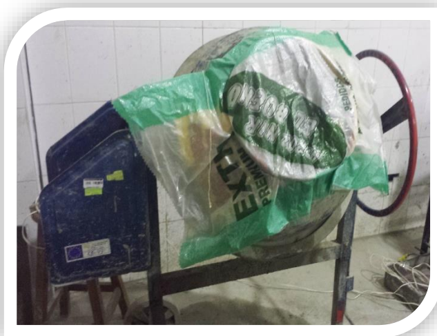
Foto15: Concretera eléctrica para realizar el mezclado de los áridos, agua y cemento.
