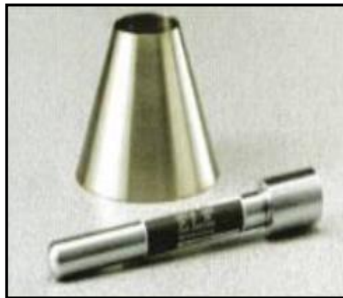
Figura 3.8. Cono y pisón para determinar la absorción de la arena
