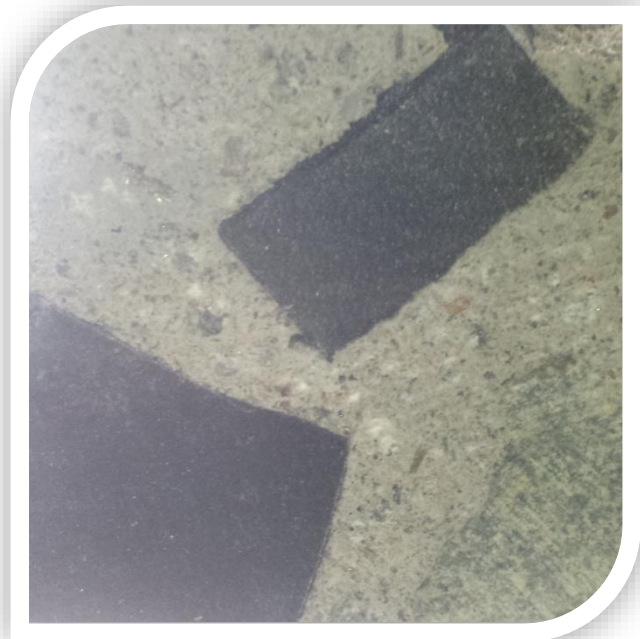
Foto25: Fotografía del concreto con fibras de caucho reciclado grueso, visto desde el estereoscopio.
