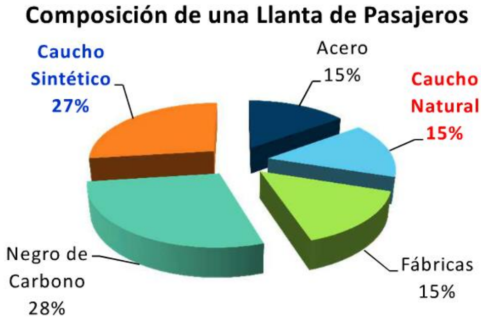
Figura 2.20. Composición de una llanta de pasajeros.
