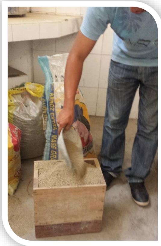
Foto8: Realizando el ensayo para determinar el peso unitario del agregado fino en estado suelto y compactado.
