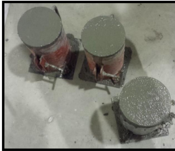
Figura 3.11. Vertido y compactación del concreto
