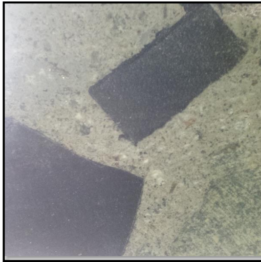
Fotografía 4.1. Interface entre FCR-G y la pasta de cemento.
