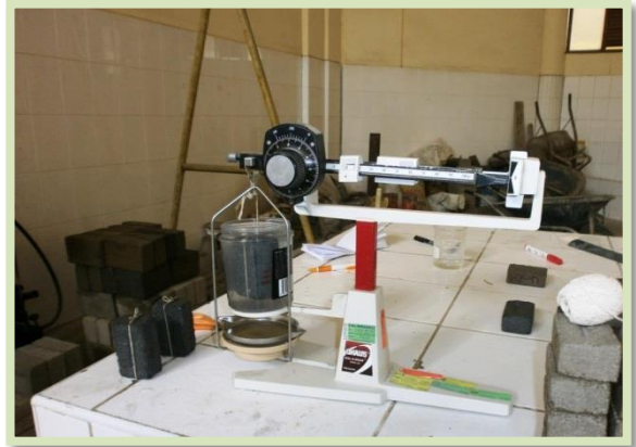
Foto N°43: Los ladrillos a escala también fueron pesados sumergidos, para obtener su densidad.
