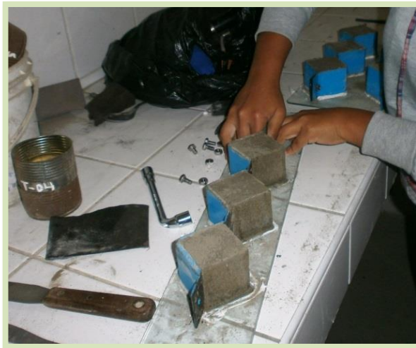
Foto N°09: Desencofrado de cubos de mortero. Después de 24 horas de su llenado. (Ensayo de Índice de Actividad Puzolanica)
