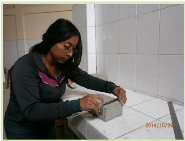
Foto N°32: El ensayo de variación dimensional se realizó a 10 unidades. Se realizó con un vernier y una regla metálica.
