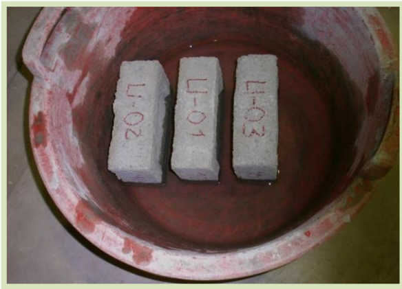
Foto N°44: Para la realización de la prueba de eflorescencia se empelaron 6 unidades, de las cuales 3 fueron colocadas en un recipiente con 2.5 cm de agua.
