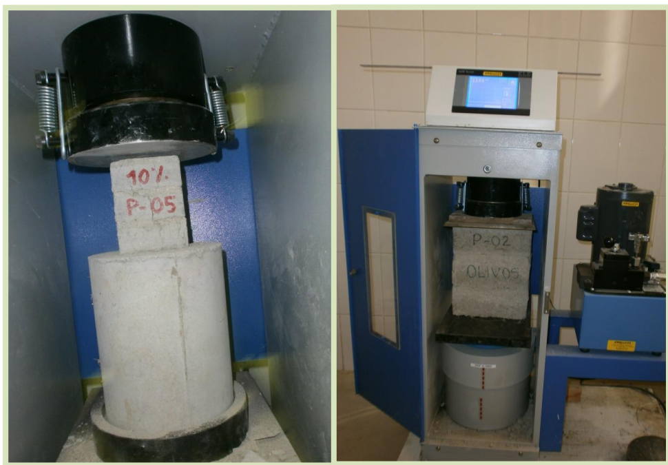
Foto N°48: Se ensayaron las pilas a escala y a tamaño natural para obtener el esfuerzo a la compresión axial de la albañilería, estas fueron rotas a los 28 días de su elaboración.
