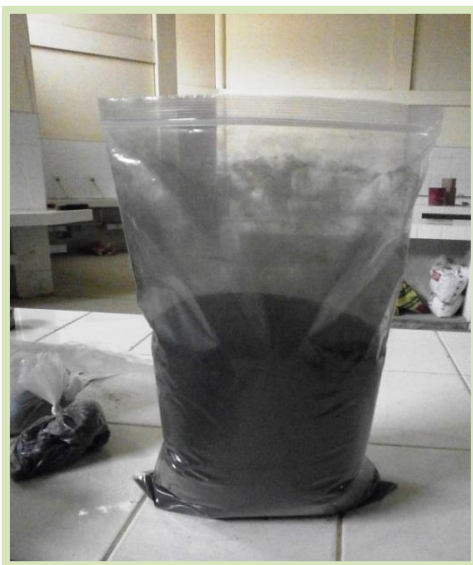
Foto N°05: Ceniza de Bagazo de Caña de Azúcar (CBCA) después del proceso de secado y molienda, lista para la realización de los ensayos respectivos.
