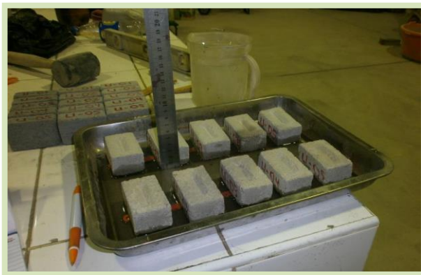
Foto N°40: Los ladrillos escalados también fueron sometidos a la prueba de succión.
