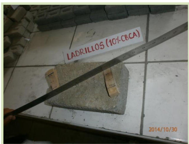
Foto N°34: Se realizó la prueba de alabeo a los ladrillos de escala natural. Los ladrillos a escala no presentarn alabeo.
