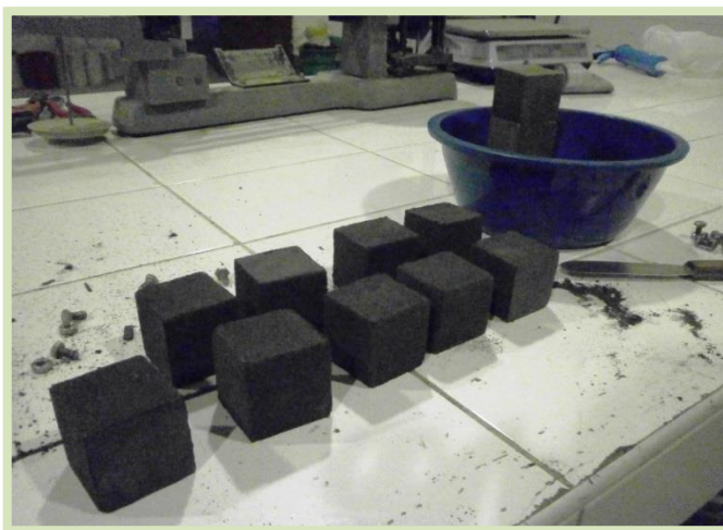
Foto N°11: se elaboraron 3 tandas de cubos de mortero, cada tanda estaba constituida por tres cubos de mortero patrón y tres cubos de mortero con CBCA.
