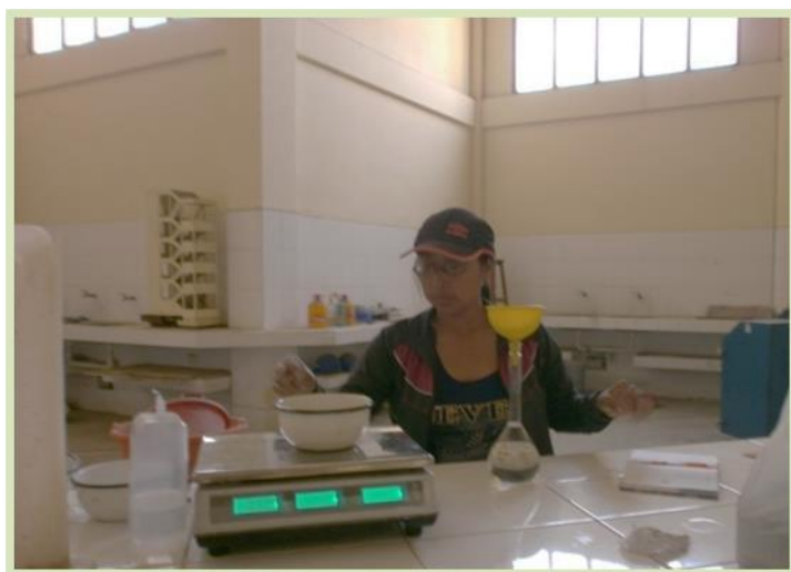
Foto N°17: se calculó el peso especifico del los agregados de ambas ladrilleras y de la arena empleada para el mortero.
