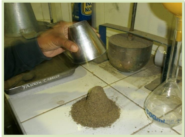
Foto N°16: El porcentaje de Absorción fue calculado con el material que paso la malla N° 4 en el caso del agregado global.
