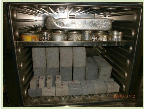
Foto N°38: Se calculó el contenido de humedad de los ladrillos a tamaño natural así como los escalados.
