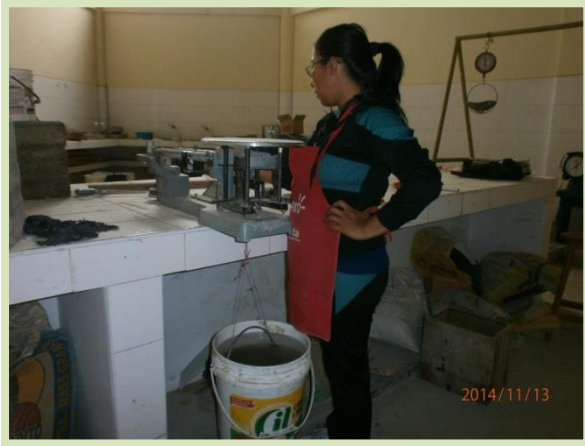
Foto N°42: Se realizó el pesaje de las unidades sumergidas para obtención de la densidad.
