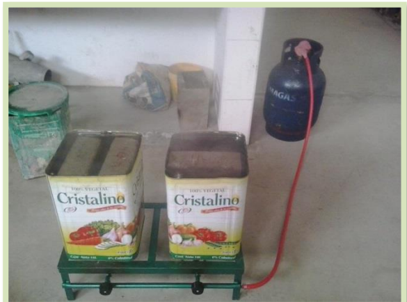
Foto N°45: Cinco ladrillos fueron hervidos por 5 horas para poder calcular la Absorción Máxima.
