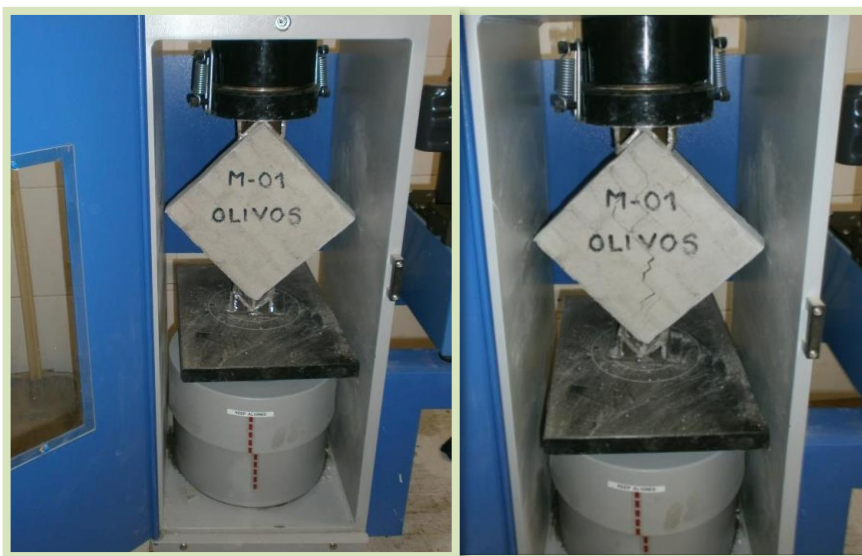
Foto N°49: Se ensayaron los a escala con unas dimensiones de 20x20 cm aproximadamente, con el fin de hallar la resistencia al corte de la albañilería, estas fueron rotas a los 28 días de su elaboración.
