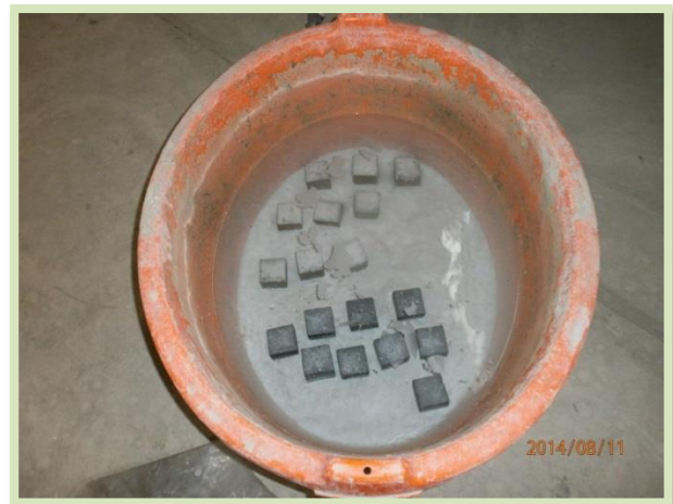
Foto N°10: Curado de cubos de mortero, después de 24 horas de su llenado. Se mantuvieron en curado hasta el día de su respectiva roturas.
