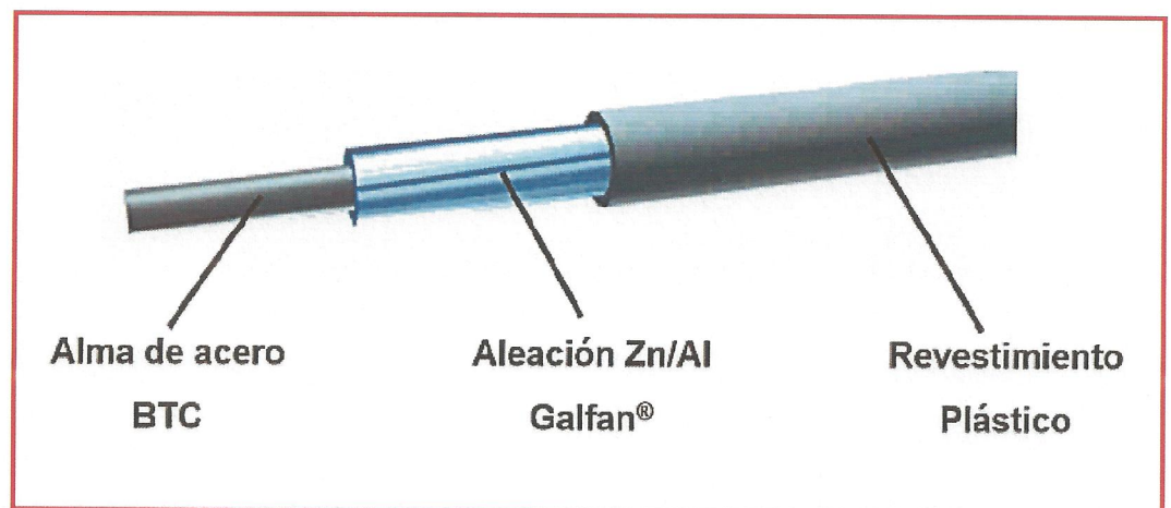
Figura 26: Características del alambre de la Malla Hexagonal. Fuente: Manual de Diseño de Geosintéticos - Víctor Chiari.
