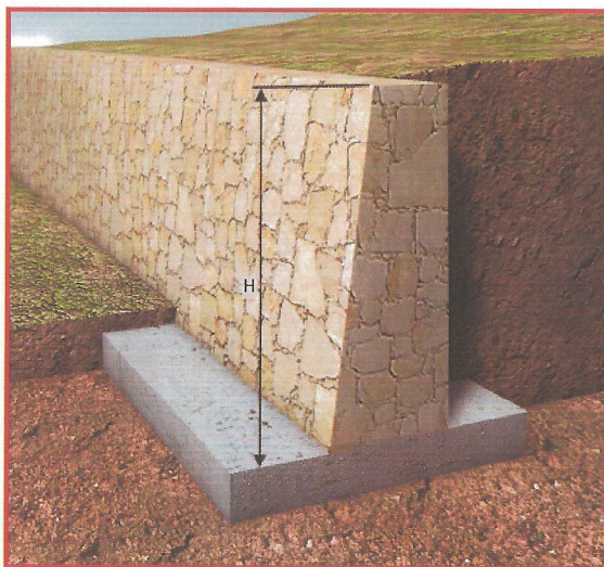
Figura 05: Muro de Mampostería. Fuente: Elaboración de los Tesistas.
