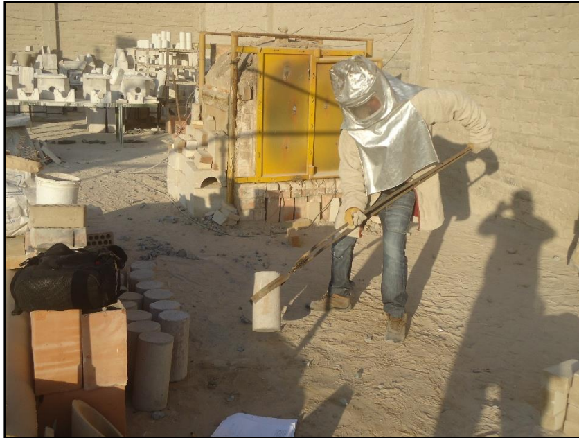
FOTO N° 15: SE OBSERVA SACANDO LAS PROBETAS DE CONCRETO QUEMADAS DEL HORNO.
