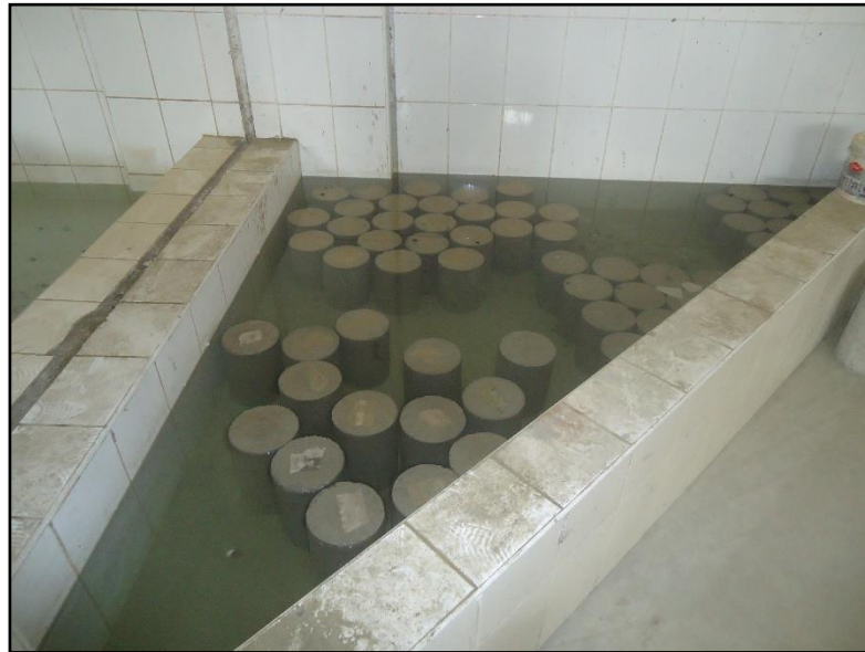
FOTO Nº 09: PROCESO DE HIDRATACION DE LAS PROBETAS DE CONCRETO
