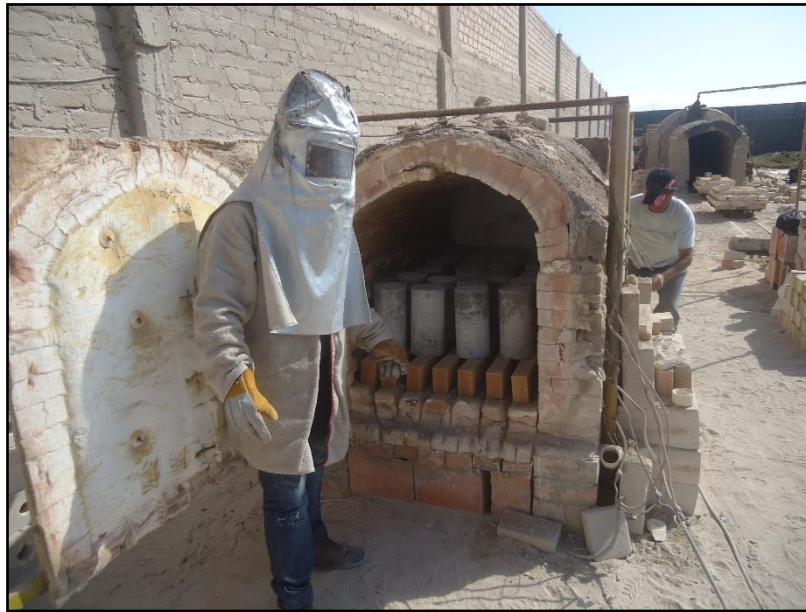
FOTO N° 13: COLOCACION DE LAS PROBETAS EN EL HORNO PARA SU RESPECTIVO PROCESO DE QUEMADO.
