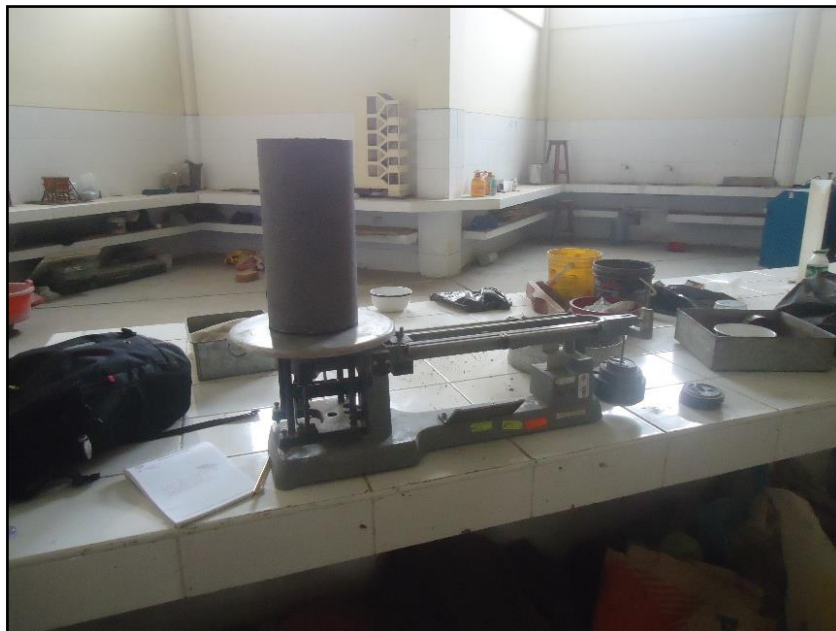
FOTO N° 16: HALLANDO LA VARIACION DEL PESO UNITARIO, DIMENSION Y ALTURA DE LA PROBETA SALIDA DEL HORNO.
