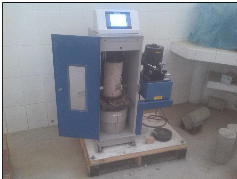
FOTO N° 18: ENSAYO A LA COMPRESION DE LAS PROBETAS SALIDAS DEL HORNO.
