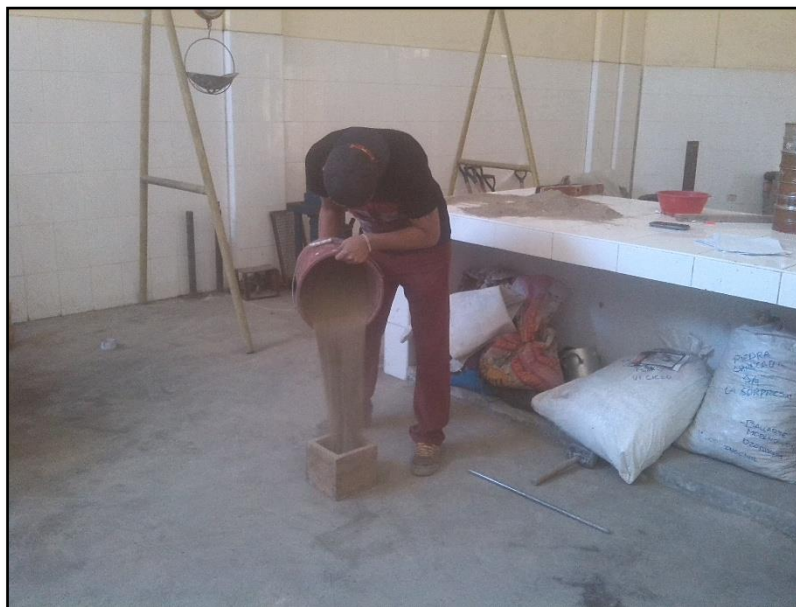
FOTO N° 06: ECHANDO EL AGREGADO FINO EN LA GAVETA.
