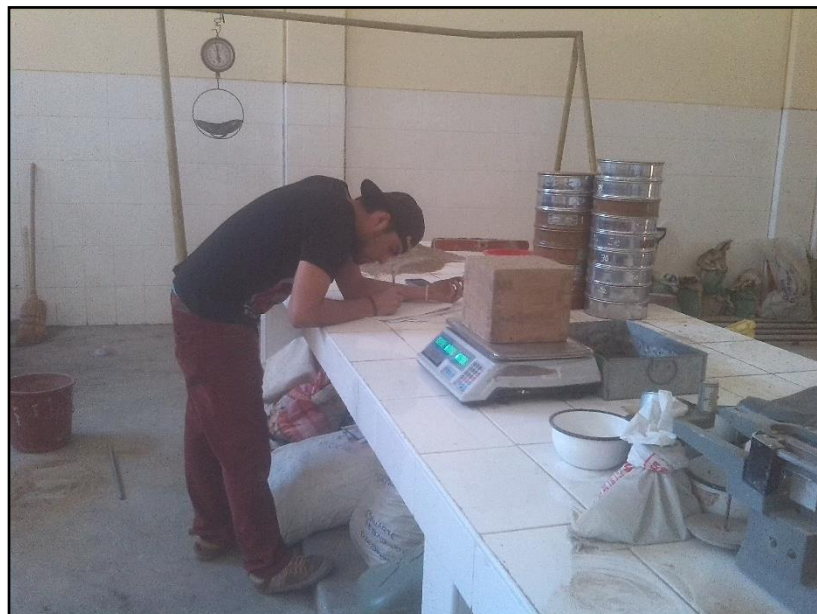
FOTO N° 08: PESANDO EL AGREGADO FINO
