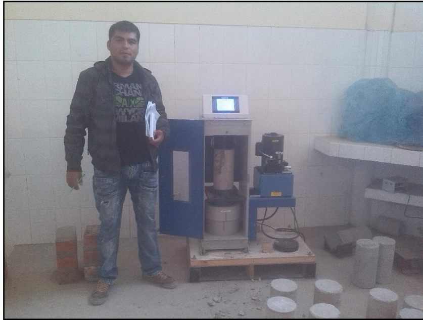
FOTO N° 17: PROCESO DE ENSAYO A LA COMPRESION DE LAS PROBETAS DEL CONCRETO PATRON
