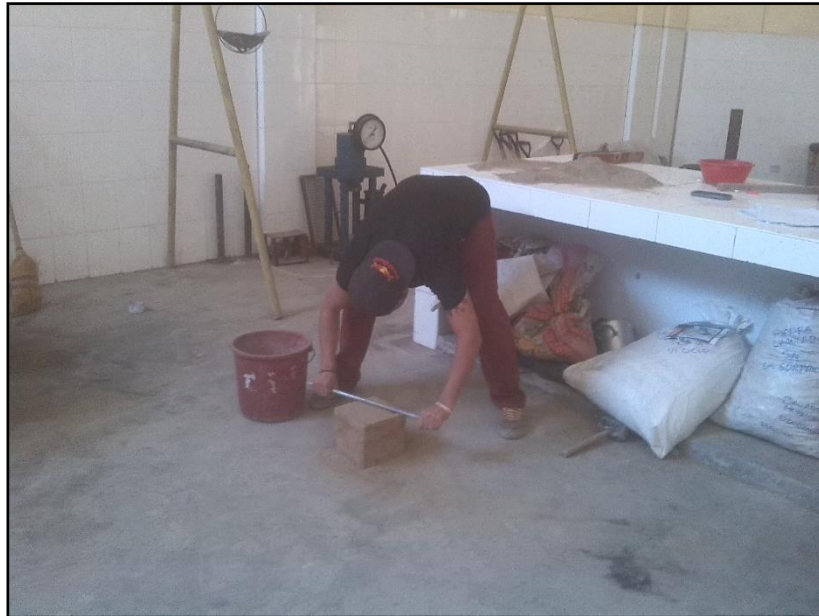
FOTO N° 07: ENRASANDO EL AGREGADO FINO EN LA GAVETA.
