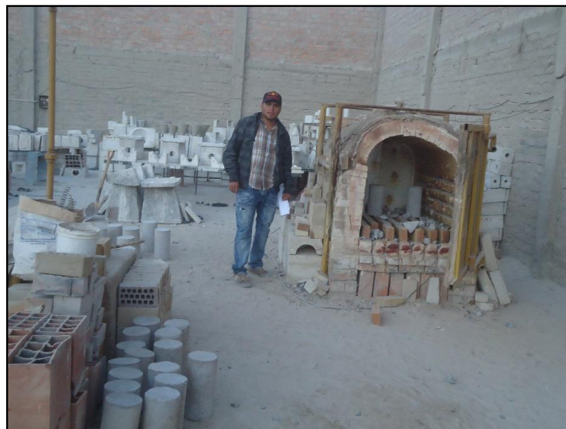
FOTO N° 14: VISTA EN FRENTE DEL HORNO EMPLEADO PARA EL PROCESO DE QUEMADO DEL LAS PROBETAS.
