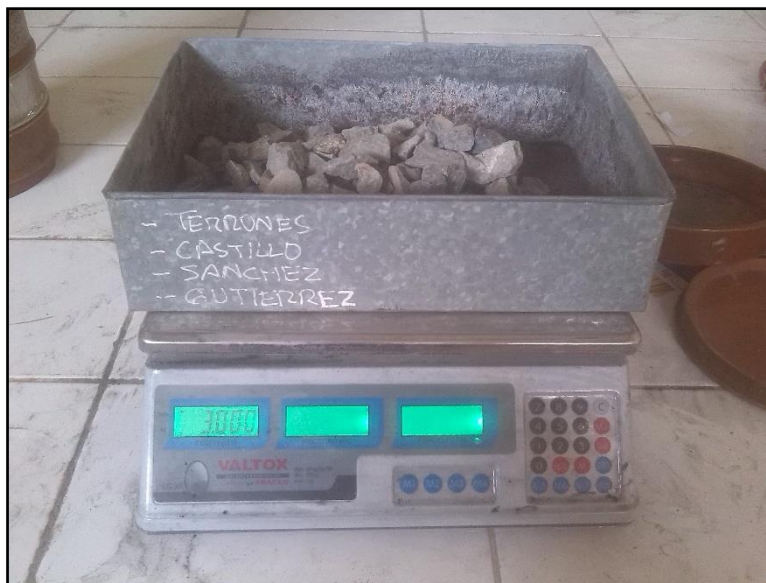
FOTO N° 04: PESANDO EL AGREGADO GRUESO.
