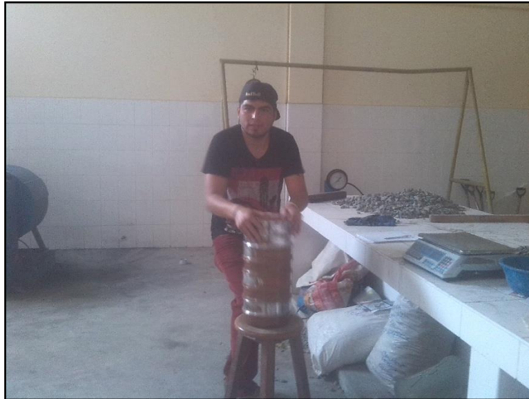
FOTO N° 03: SE OBSERVA EL PROCESO DE TAMIZADO DEL AGREGADO GRUESO CON LAS RESPECTIVAS MALLAS ESTANDARES.
