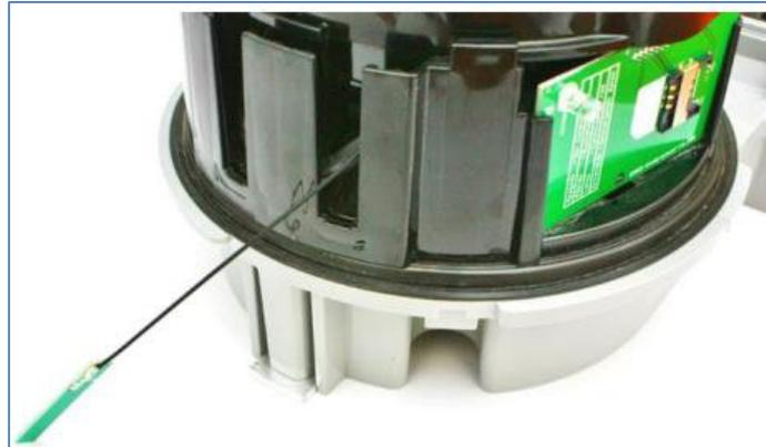
**Figura N° 4.18. Correcta colocación de la antena.**
