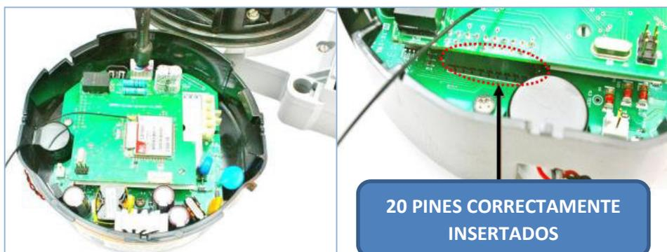
**Figura N° 4.13. Correcta colocación del módems GPRS en los medidores.**
