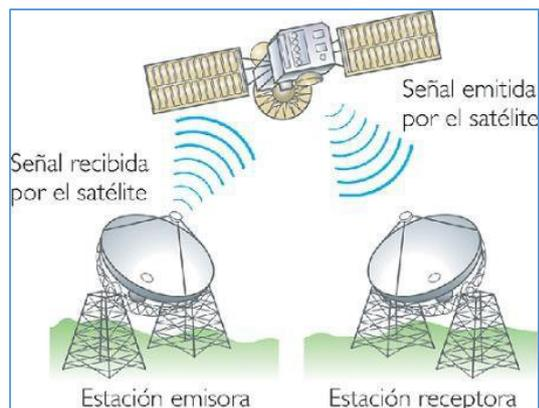
**Figura N° 2.16. Esquema de la comunicación vía microondas**
