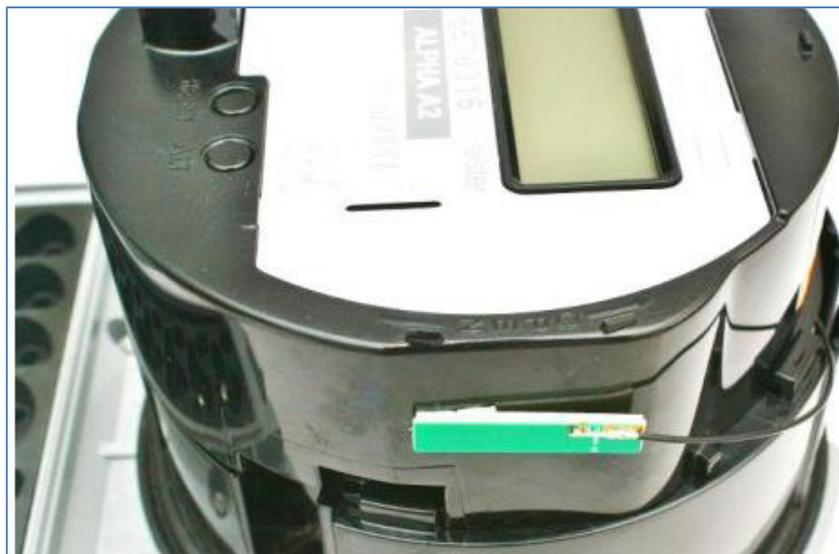
**Figura N° 4.19. Aseguramiento de la antena a la carcasa del medidor**
