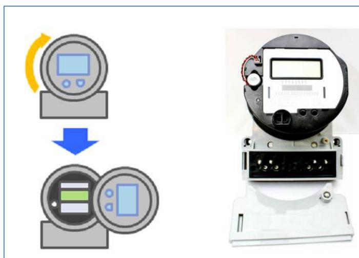
**Figura N° 4.7.** Apertura del medidor ELSTER A3RAL
