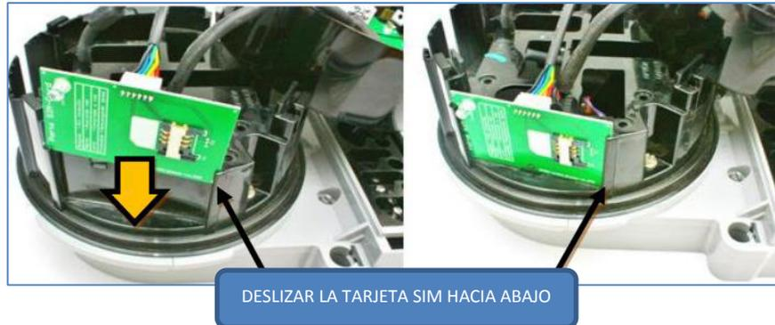
**Figura N° 4.15. Introducción de la porta SIM – Card al medidor.**
