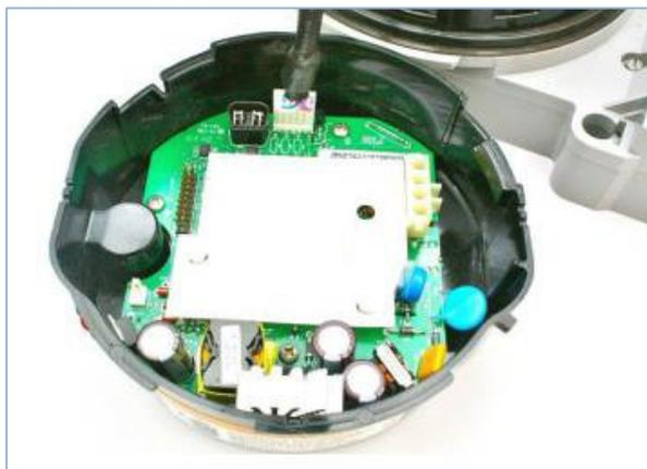
**Figura N° 4.12. Inserción de lámina aislante para evitar interferencia**
