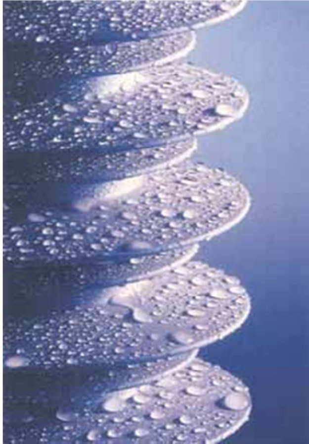
Figura 16. Efecto hidrofóbico de la superficie del aislador polimérico sin contaminación
