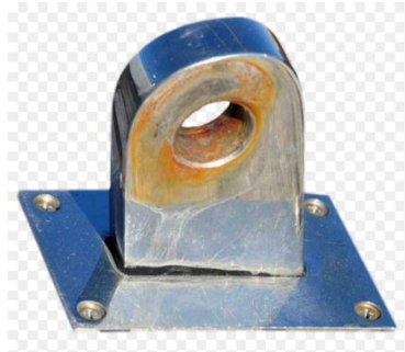
Figura 3.4 : Representación de la corrosión por cavidades
