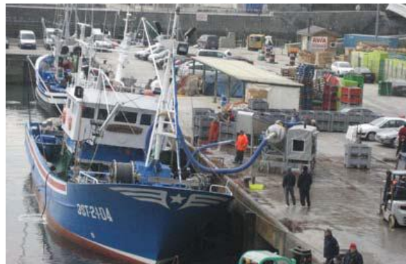
Figura 2.5: Utilización de la bomba de succión para la extracción de la materia prima.
