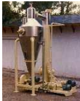
Figura 18. Tanque de expansión flash Fuente: Goalco Perú SAC.
