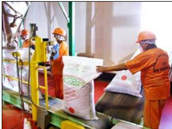
Figura 07. Sistema de ensaque y pesado de harina de pescado. Fuente: Delprex Perú Company SAC.
