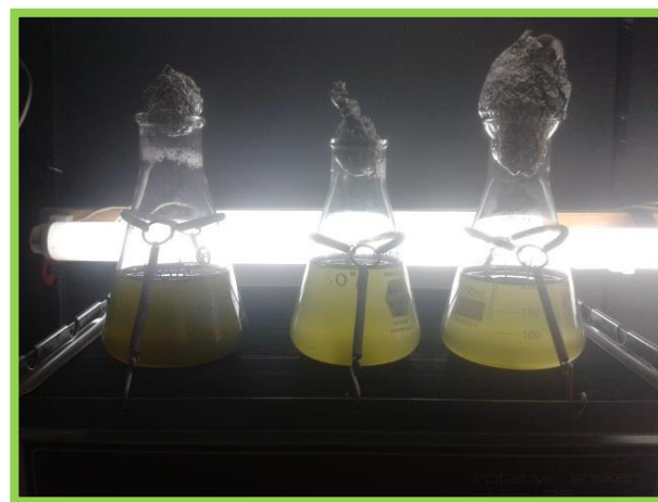
Fig. 4. Matraces con medio HM con contenido de antibióticos (Tetraciclina 100 \text{ mg.L}^{-1} ) y con cultivo de Scenedesmus sp.
