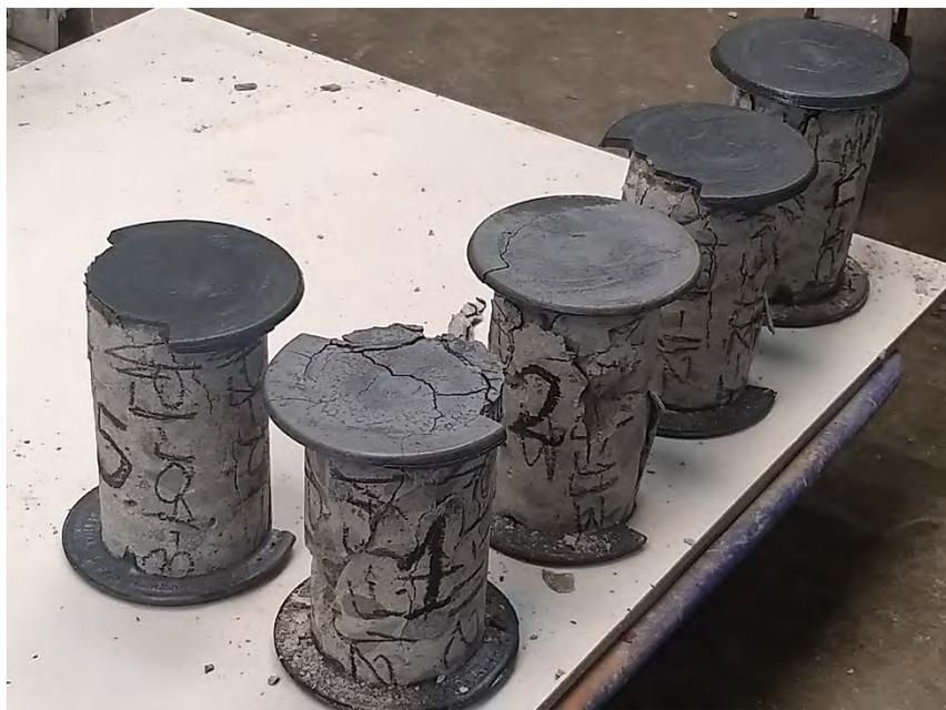
**FOTO N° 36.** En la imagen se observan las muestras M1, M2, M3, M4 y M5 después de la realización del ensayo de resistencia a la compresión.
