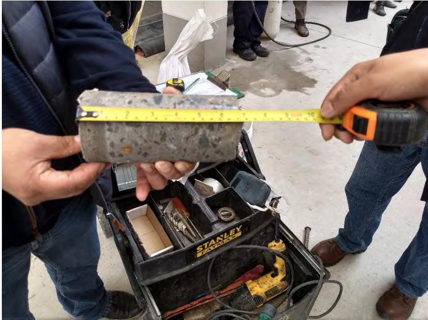
**FOTO N° 15.** En la fotografía se observa la toma de medidas de la muestra, para los cálculos posteriores propios del ensayo. Muestra M2 (elemento C-6 – D).
