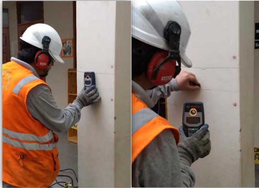
**FOTO N° 11.** En la imagen se puede observar al personal de laboratorio, ubicando el acero de refuerzo de la columna, a fin de poder realizar el ensayo en el Elemento C-6 – D (Muestra M2) con normalidad.
