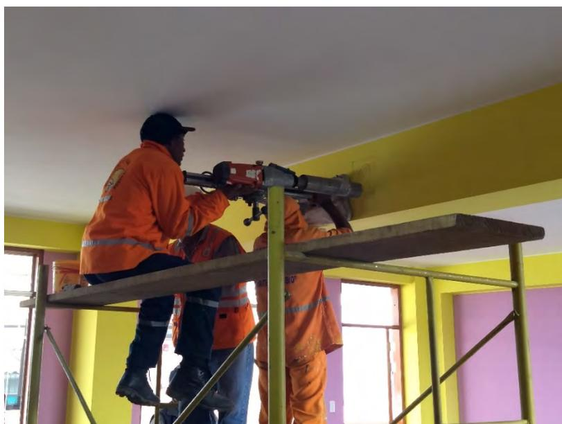
**FOTO N° 22.** Personal de Laboratorio FIC UNI realizando la extracción de prisma diamantino, muestra M1.
