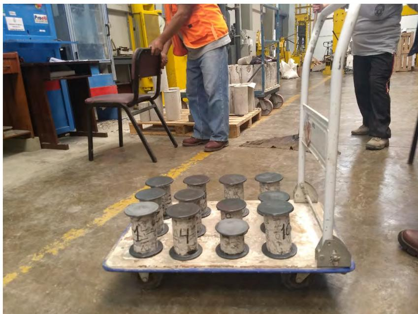
**FOTO N° 33.** En la Fotografía se muestran las muestras obtenidas de la extracción de prismas diamantinos durante el segundo proceso de extracción (Días 1 y 2).
