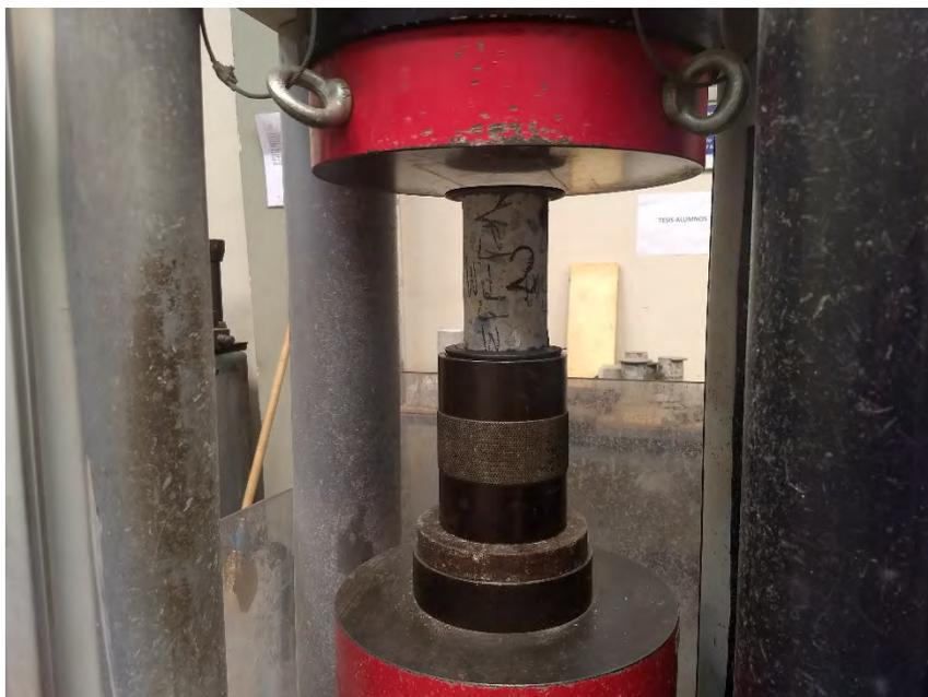
**FOTO N° 34.** En la imagen se muestra el prisma diamantino correspondiente a la muestra M2, antes del ensayo de rotura.
