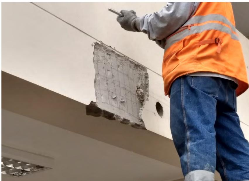
**FOTO N° 17.** En la imagen se observa el ensayo de esclerometría con el equipo que el operador sostiene en manos. Muestra M1.
