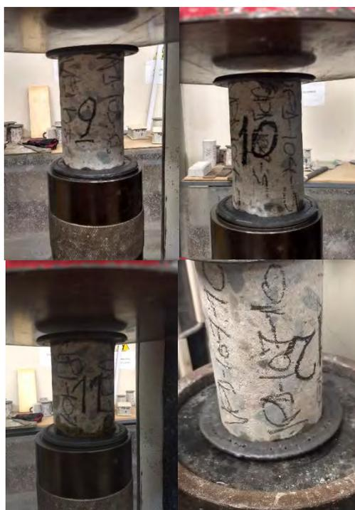
**FOTO N° 37.** En la imagen se muestra el prisma diamantino correspondiente a la muestra M9, M10, M11 y M12, antes del ensayo de rotura.
