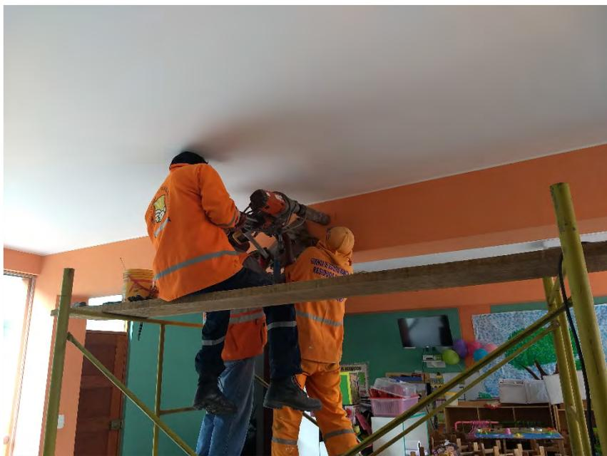
**FOTO N° 25.** En la imagen se muestra el proceso de extracción del prisma diamantino, muestra M9.
