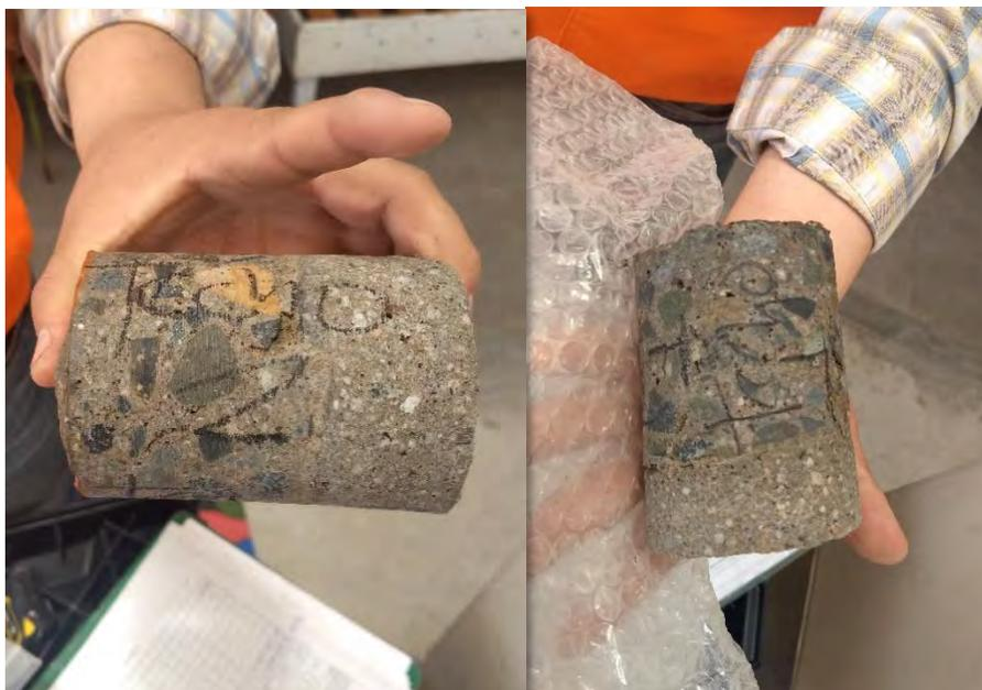
**FOTO N° 30.** En la imagen se muestra el prisma diamantino obtenido de la extracción de la muestra M7 y M8.
