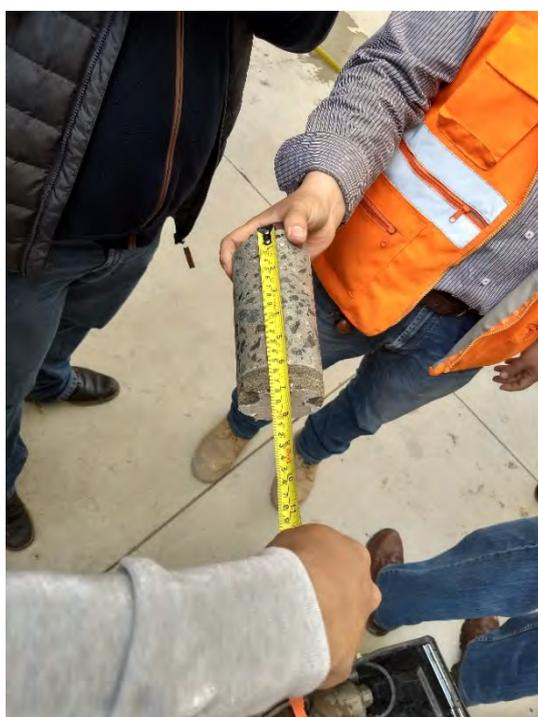
**FOTO N° 10.** En la imagen se muestra la toma de información (medidas) para los cálculos propios del ensayo; esto para la muestra M3 correspondiente al elemento C-6 – I.
