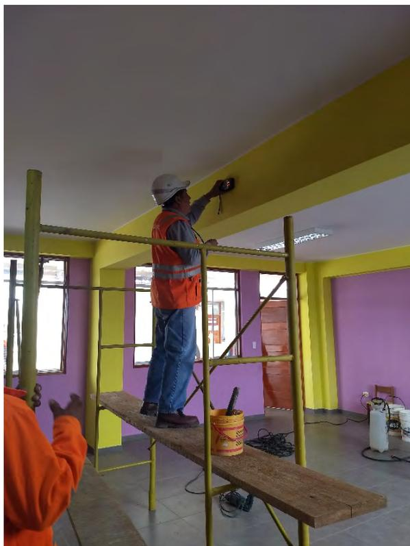
**FOTO N° 21.** Identificación de acero de refuerzo previa extracción de la muestra M1.
