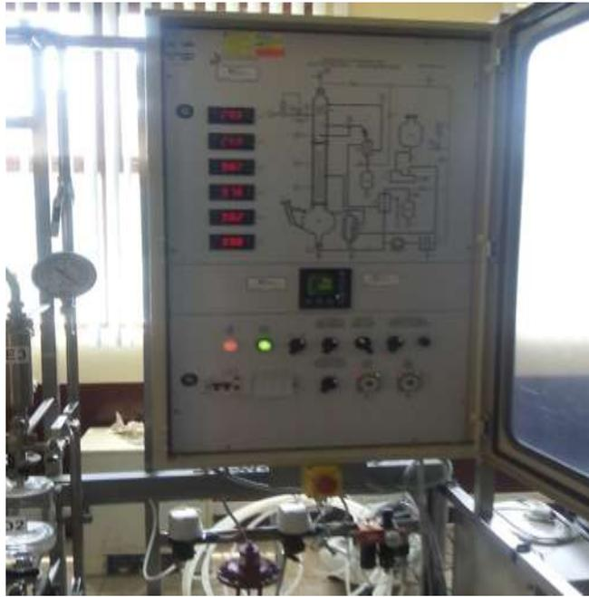
**Figura 24.** Panel de control del equipo de destilación, equipo destilador continuo.
