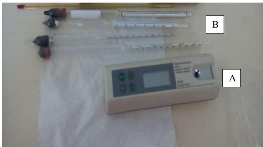
**Figura 26.** Los instrumentos para la medición de densidad, grados alcohólicos, índice de refracción. A: refractómetro; B: Densímetros.
