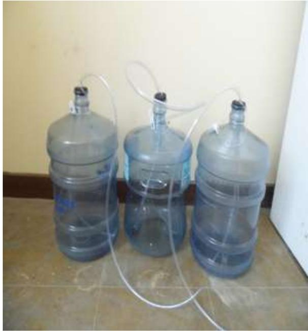
**Figura 15.** Construcción de los biodigestores para elaboración de las unidades experimentales (bidones de plástico).
