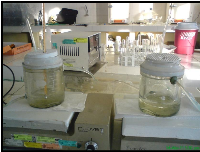
Figura 9. Sistema experimental para determinar los parámetros cinéticos de la inulinasa.
