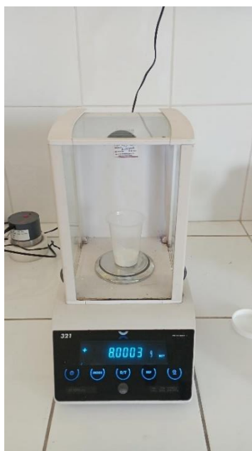
Fig. 19: Pesado de almidón de yuca Blanca y Amarilla; Volumen total de 200 ml (4%)
