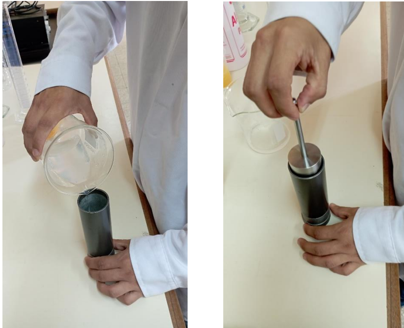
Fig. 22: Preparación del gel de almidón de yuca Blanca y Amarilla en el porta muestra del Reómetro
