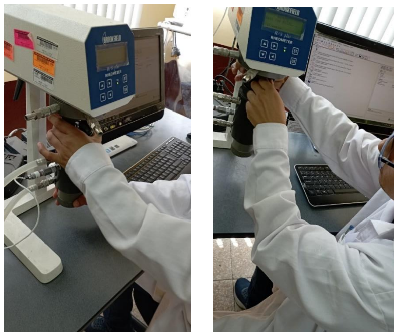
Fig. 22: Preparación del gel de almidón de yuca Blanca y Amarilla en el porta muestra del Reómetro
