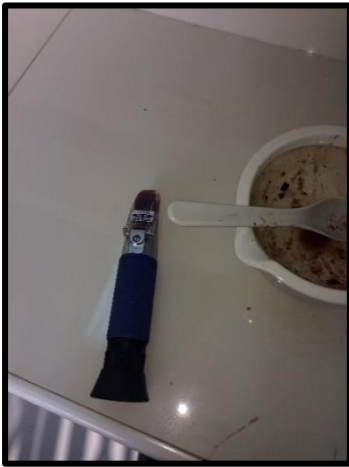
a) Determinamos los grados brix mediante el refractómetro
