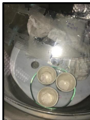
b) Muestras en la estufa y posterior pesado luego del secado
