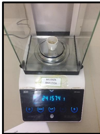
b) Muestras en la estufa y posterior pesado luego del secado
