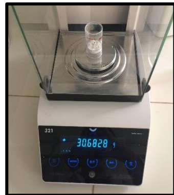
h) Seguidamente llevamos a la mufla y posteriormente pesamos la ceniza que quedo
