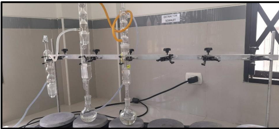
b) Muestras en el equipo de extracción soxhlet
