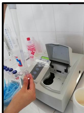
f) Lectura de muestras en el espectrofotómetro UV - Visible
