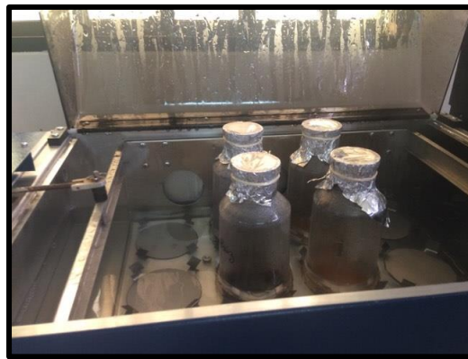
b) Adicionamos buffer fosfato de la enzima \alpha amilasa posteriormente incubamos en el baño maría con shaker
