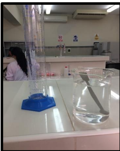
b) Mezclado de muestras con metanol y ácido clorhídrico al 1 %, luego se llevaron las muestras a un baño ultrasónico y posteriormente se centrifugó
