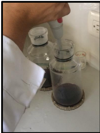
b) Adicionamos buffer fosfato de la enzima \alpha amilasa posteriormente incubamos en el baño maría con shaker
