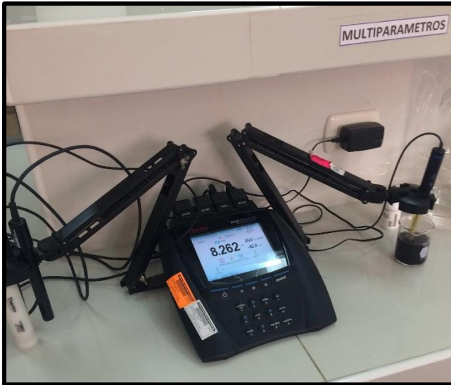
a) Determinamos el pH mediante el multiparámetro
