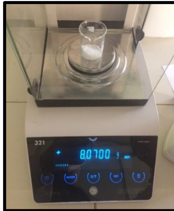
a) Pesado de muestras y reactivos para determinar la fibra dietética
