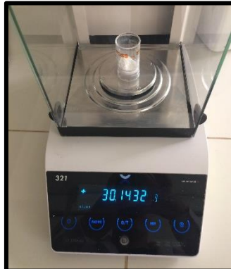
h) Seguidamente llevamos a la mufla y posteriormente pesamos la ceniza que quedo
