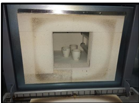
b) Muestras en la estufa y posterior pesado luego del secado
