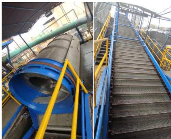
Figura 4. Desagüador rotativo y malla transportadora
