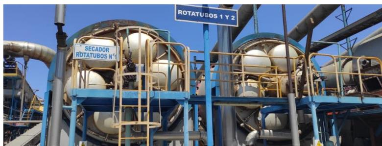
Figura 10. Etapa de presecado (secadores rotatubos). Copeinca Chimbote
