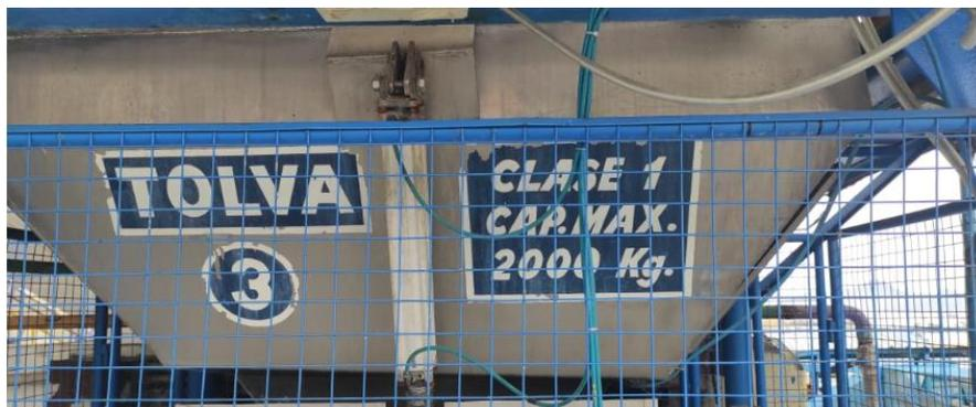
Figura 5. Tolva de pesaje 2000 kg. Copeinca Chimbote
