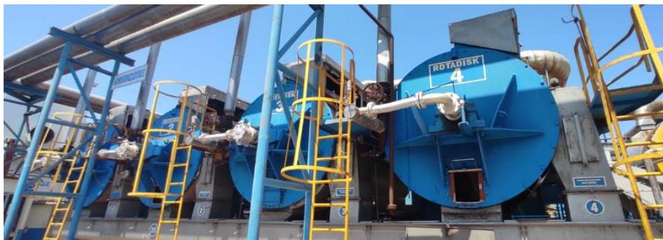
Figura 9. Etapa de homogenización (Secadores Rotadisk). Copeinca Chimbote
