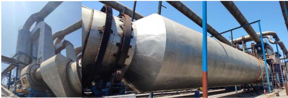
Figura 11. Etapa de secado final (Secadores de recirculación Intensiva). Copeinca Chimbote
