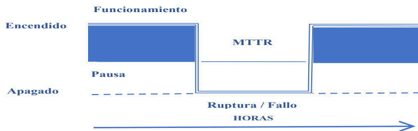
Figura 8. MTTR (tiempo medio para reparación)
