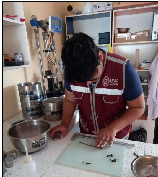
Foto N° 18 : Determinación del Límite Plástico para las distintas muestras de suelo
