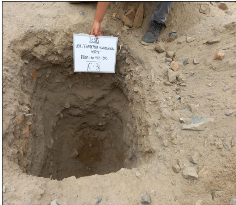
Foto N° 09 : Excavación para la C-3, h =1.50m (Referencia: Coishco )
