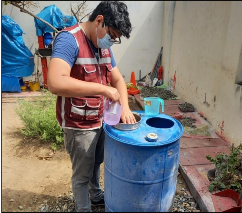
Foto N° 15 : Ensayo de análisis granulométrico por vía húmeda
