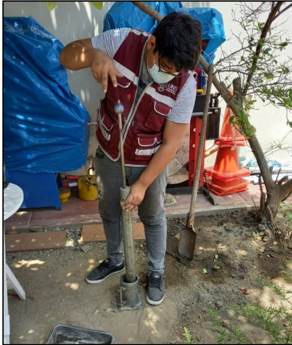
Foto N° 21 : Compactación de muestras en el molde de Proctor Modificado
