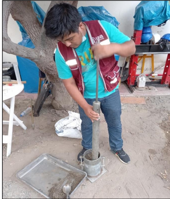
Foto N° 23 : Compactación de muestras para el ensayo de CBR
