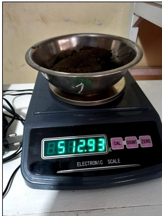
Foto N° 14 : Pesaje de muestra para determinación del contenido de humedad
