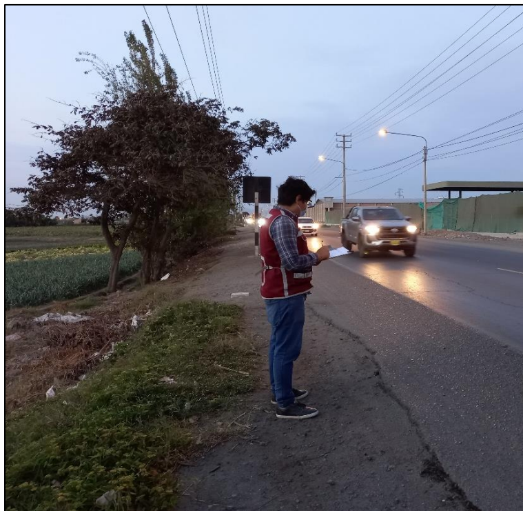
Foto N° 06: Conteo por tipo de vehículo realizado a diferentes horas
