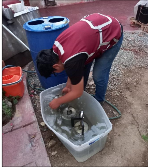
Foto N° 25 : Sumersión de los moldes CBR por un periodo de 96 horas.
