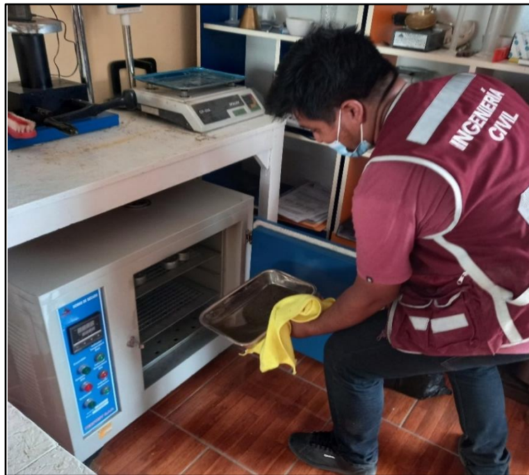
Foto N° 16 : Secado de la muestra para el análisis granulométrico por vía seca
