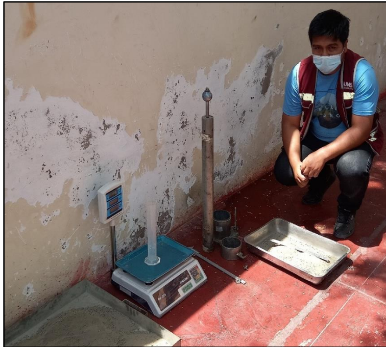
Foto N° 19 : Molde, equipos y herramientas para el ensayo Proctor Modificado
