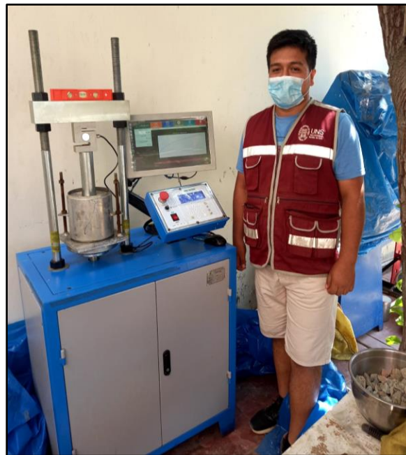
Foto N° 26: Maquina Multiusos Automática Computarizada para el ensayo de CBR
