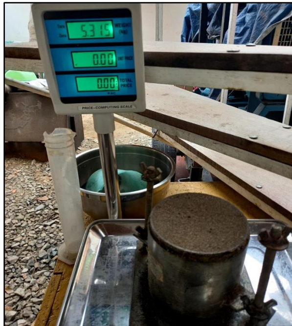
Foto N° 22 : Pesaje de molde y muestra compactada del ensayo proctor modificado
