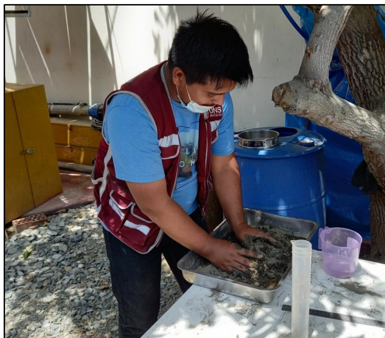
Foto N° 20 : Preparación de los especímenes a diferentes porcentajes de humedad
