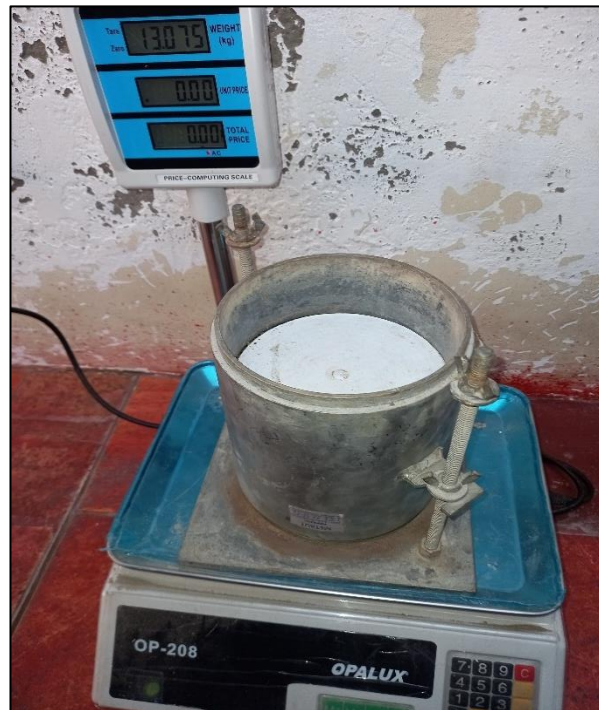
Foto N° 24 : Pesaje de molde y muestra compactada para el ensayo de CBR
