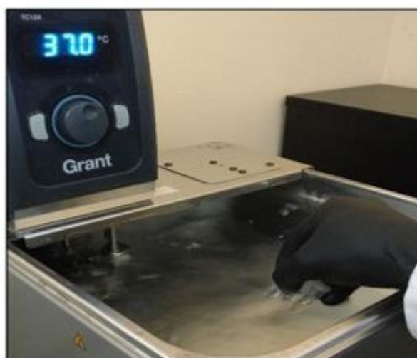
Figura 10. Muestras de hidrolizado de cachaza más kit enzimático sometidas a baño María a 37°C Fuente: elaboración propia.
