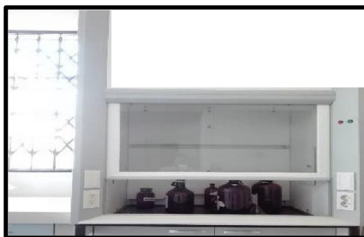
Cámara extractora de gases
