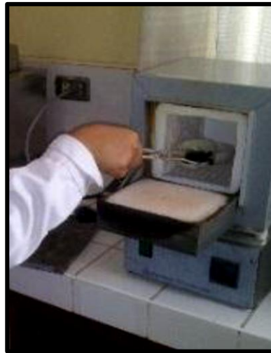
La muestra es puesta por 5 horas en la mufla
