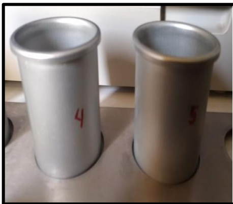
Pesar y rotular los vasos de aluminio; seguidamente agregar el éter de petróleo
