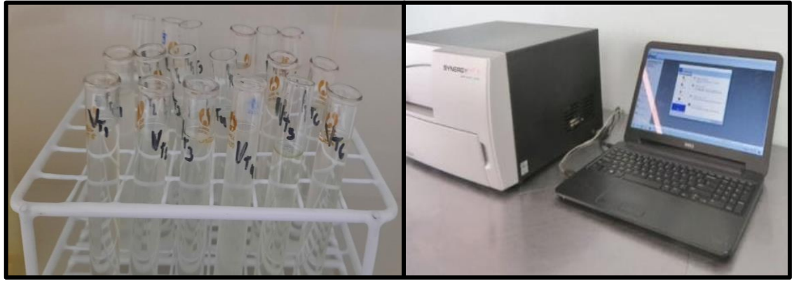
Figura 27. Determinación de polifenoles totales de las muestras mediante la lectura en el lector multi modal de microplacas utilizado en el laboratorio de IITA
