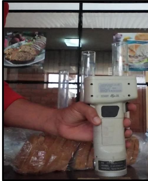
Figura 13. Medición del color de las galletas
