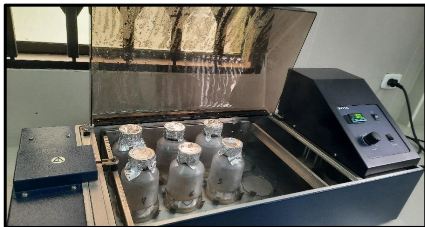
Figura 18. Muestras ingresando al baño maría para incubar a 95°C y evaluar la acción de la enzima amilasa
