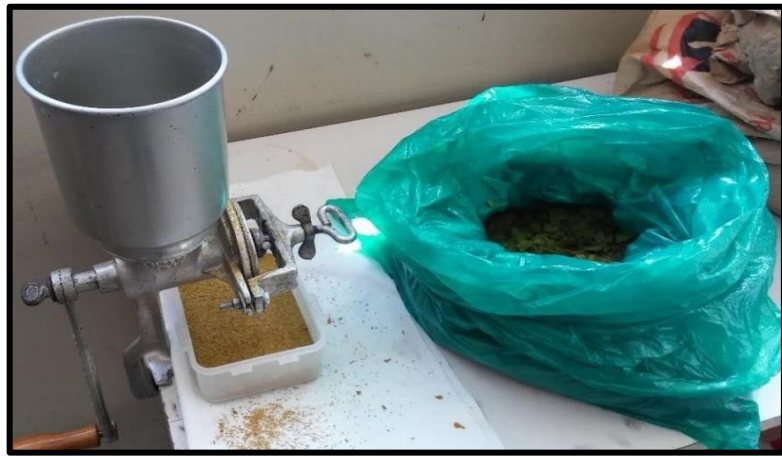
Molienda de la cascara de mango seco
