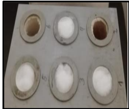
Colocar los capachos en la gradilla soporte de cartuchos
