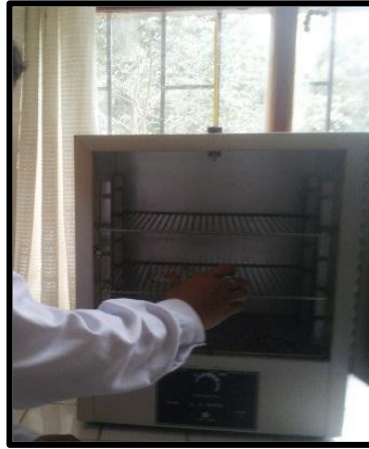
Determinación de humedad de la harina
