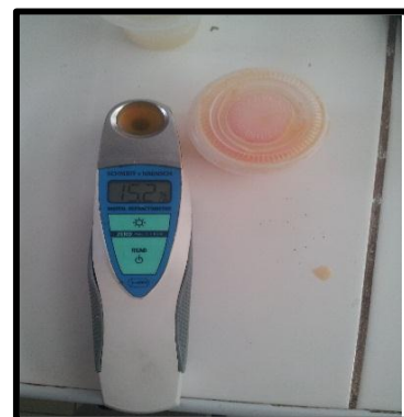
Determinación de °Brix de las muestras
