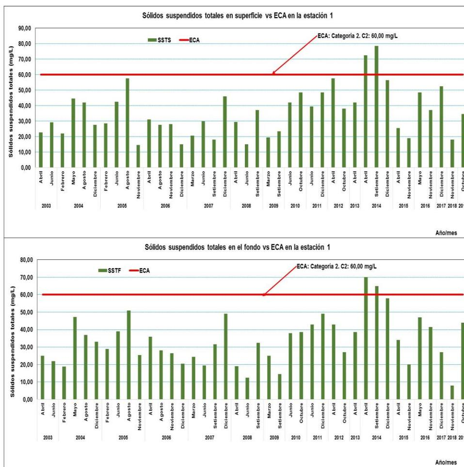
Figura 18. Variación temporal de sólidos suspendidos totales en superficie y fondo vs el ECA en la estación 1 en la bahía de Samanco. 2003 al 2019.
