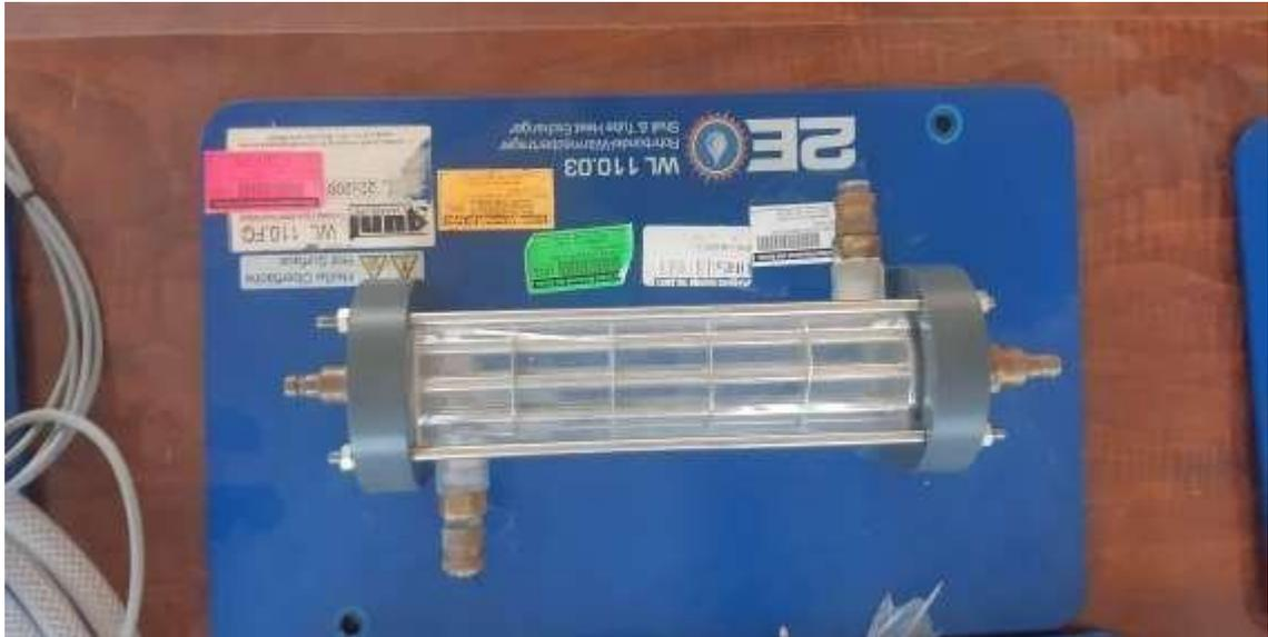
Imagen de intercambiador de calor de tubo y coraza
