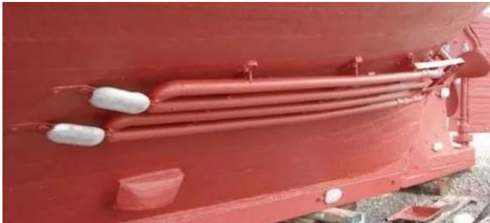
Figura 15 Enfriador de quilla
