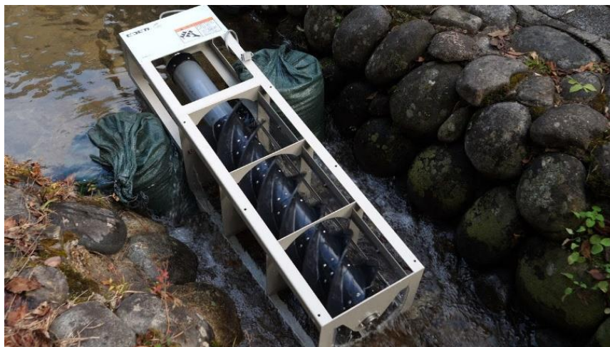
Figura 18. Turbina PicoPica de 10 W en funcionamiento.
