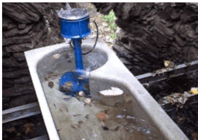
Figura 13. Turbina PowerPal LH en operación.
