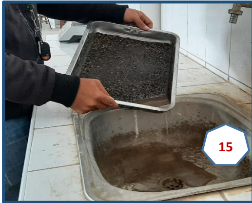
Fotografía N° 15: Se bota el agua de la arena, luego de hidratarse por 24 hrs.
