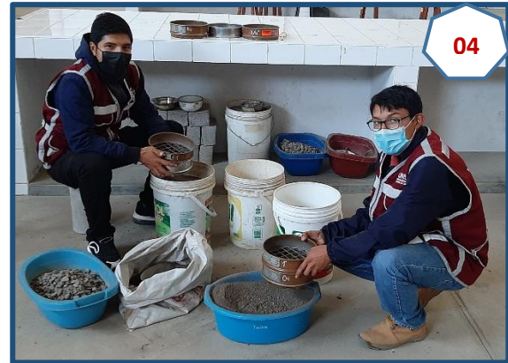
Fotografía N° 04: Separación por tamizado del agregado grueso y fino.
