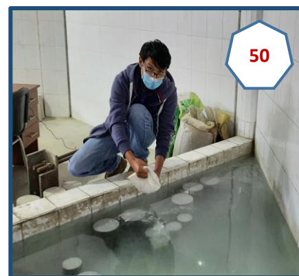
Fotografías N° 49 y 50: Probetas curadas a la edad de 28 días, listas para ensayo de rotura. El control de la temperatura de curado se realizó adicionando cal al agua.
