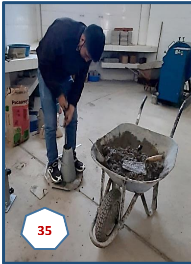
Fotografías N° 35, 36 y 37: Ensayo de Asentamiento del concreto llenando el cono en 3 capas y su respectivo varillado con varilla de 5/8", enrasado y medida del Slump.
