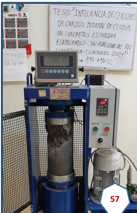
Fotografía N° 57: Ensayo de resistencia a la compresión MP+ 10% CCM f'c = 175 kg/cm 2 .
