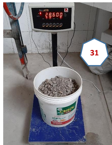
Fotografías N° 29, 30 y 31: Cemento, y pesado de agregados para mezcla de la tanda de concreto patrón, se procede de la misma manera para ambas resistencias f'c.
