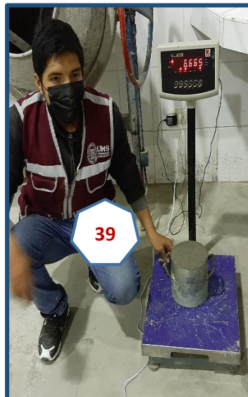
Fotografías N° 39 y 40: Peso del concreto compactado para ensayo de Densidad y Aire, y medición de la temperatura con 2 termómetros.
