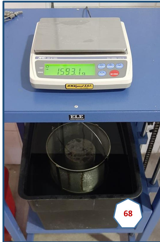
Fotografía N° 68: Peso sumergido de las muestras, peso "D".
