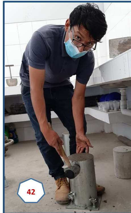
Fotografía N° 42: Se realizó el tapping con 15 a 25 golpes en los costados del molde. El acabado se dio con plancha.
