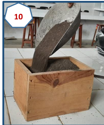
Fotografías N° 10 y 11: Realizando el ensayo de peso unitario del A. grueso y fino.
