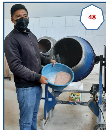
Fotografía N° 48: Ingreso de la ceniza a la mezcladora, luego que se echa el cemento.
