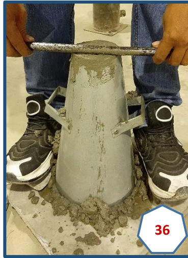
Fotografías N° 35, 36 y 37: Ensayo de Asentamiento del concreto llenando el cono en 3 capas y su respectivo varillado con varilla de 5/8", enrasado y medida del Slump.
