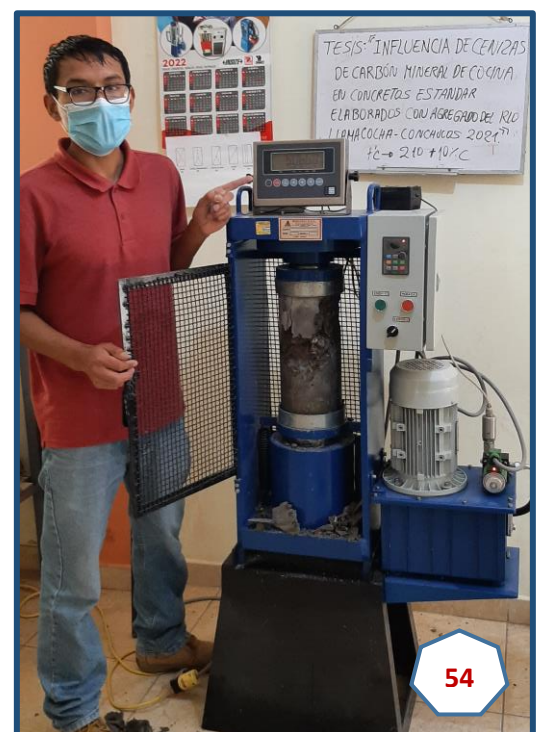
Fotografía N° 54: Ensayo de resistencia a la compresión MP+10% CCM f'c = 210 kg/cm 2 .
