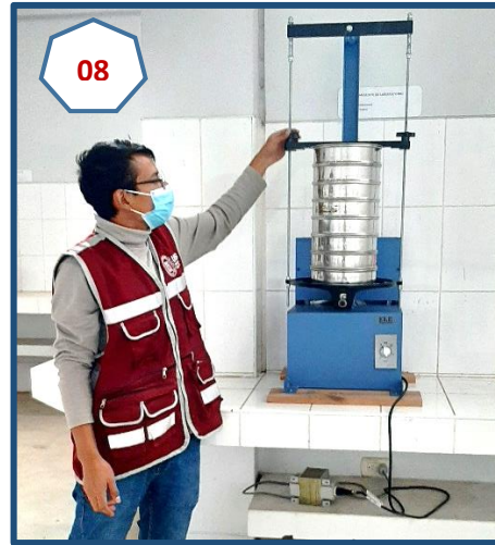
Fotografía N° 08: Tamizado de Arena Gruesa para análisis granulométrico.
