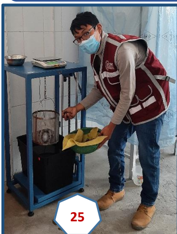
Fotografía N° 23: Se hidrató 24 hr la muestra de piedra para el Ensayo de P.E. y Absorción.
