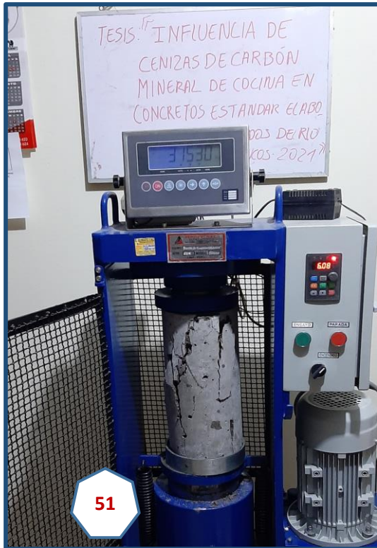
Fotografía N° 51: Ensayo de resistencia a la compresión Concreto Patrón 175 kg/cm 2 .(28d)
