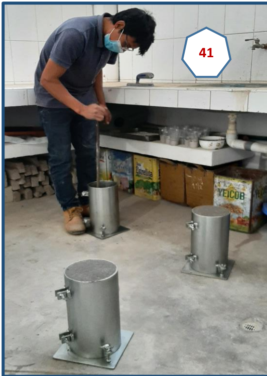
Fotografía N° 41: Elaboración de probetas 150 mm x 300 mm, en 3 capas y su varillado.
