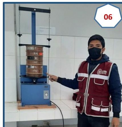
Fotografía N° 06: Tamizado del A. Grueso, para análisis granulométrico.
