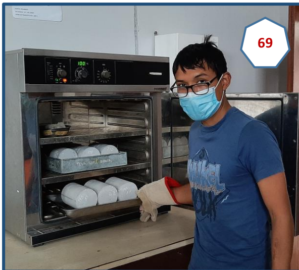
Fotografía N° 69: Secado de muestras del Ensayo de absorción a 110 \pm 5^\circ\text{C} .
