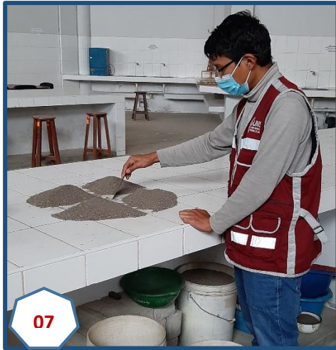
Fotografía N° 07: Cuarteo de Arena Gruesa, del mismo modo para la piedra.
