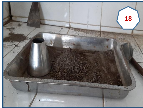
Fotografía N° 18: Muestra secado superficialmente, estado SSS. de A. fino.
