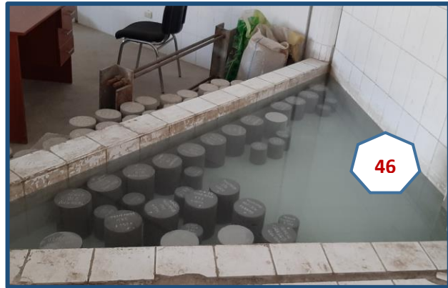
Fotografía N° 46: Se realizó el curado de los testigos, para cada edad específica.
