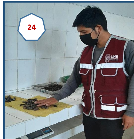
Fotografía N° 24: Obtención de la SSS del agregado grueso hidratado.
