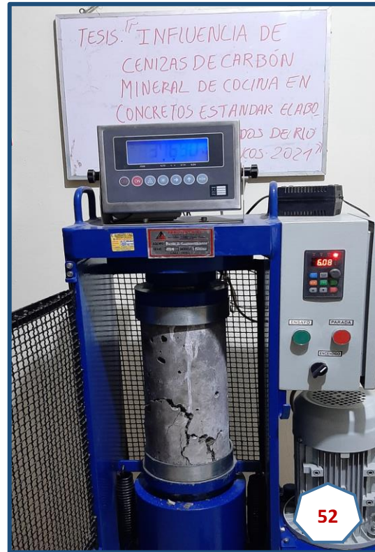
Fotografía N° 52: Ensayo de rotura del Concreto Patrón 210kg/cm 2 . (28días)
