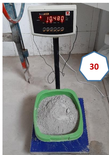
Fotografías N° 29, 30 y 31: Cemento, y pesado de agregados para mezcla de la tanda de concreto patrón, se procede de la misma manera para ambas resistencias f'c.
