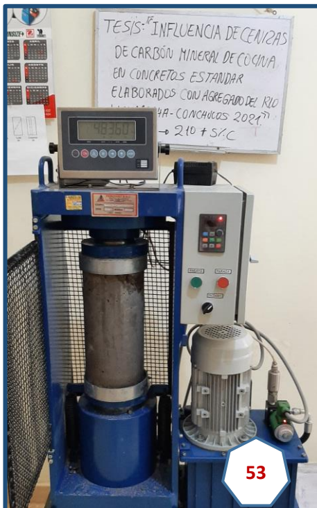
Fotografía N° 53: Ensayo de resistencia a la compresión MP + 5% CCM f'c = 210 kg/cm 2 .
