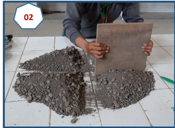
Fotografía N° 02: Cuarteo del agregado de río (global) en Laboratorio
