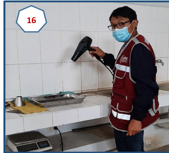
Fotografía N° 16: Secado de arena con aire caliente, Ensayo de Absorción.
