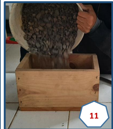
Fotografías N° 10 y 11: Realizando el ensayo de peso unitario del A. grueso y fino.
