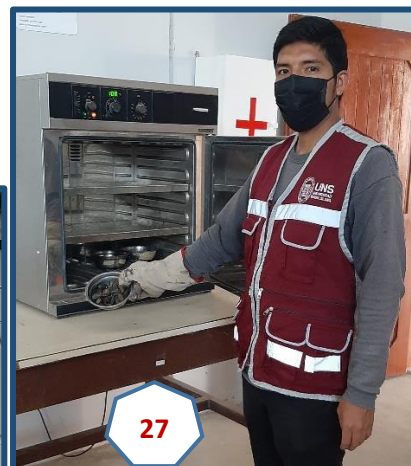
Fotografías N° 26 y 27: Secado de muestras de A. Grueso al horno a 110 \pm 5^\circ\text{C} .
