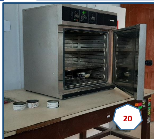
Fotografía N° 20: Se introdujo las muestras de A. Fino al horno.
