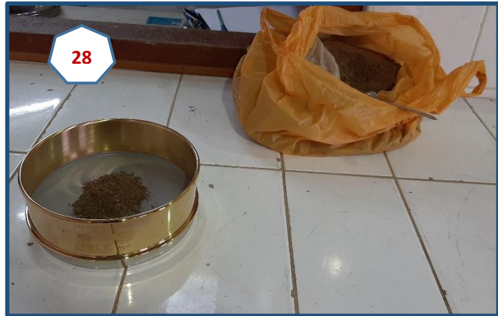
Fotografía N° 28: Se realizó el ensayo de finura de la ceniza tamiz N°325 por lavado.
