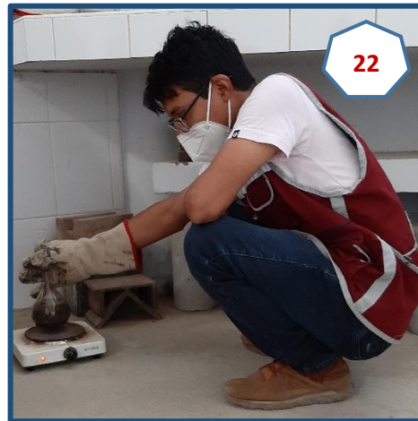
Fotografía N° 22: Se eliminó las burbujas de aire, para ensayo de Peso Específico.
