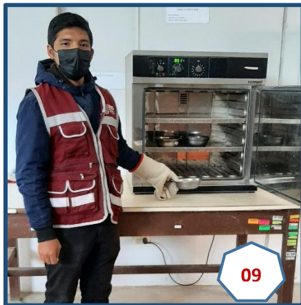
Fotografía N° 09: Secado del A. Grueso y Fino para C. humedad.
