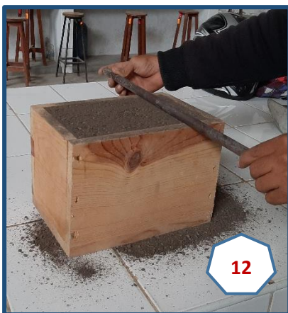
Fotografías N° 12, 13, 14: Realizando el enrasado, varillado y registro del peso obtenido para el cálculo del peso unitario de ambos agregados, en estado suelto y compactado.
