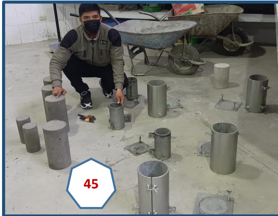
Fotografía N° 45: Desencofrado de las probetas tras 24 horas de su elaboración.
