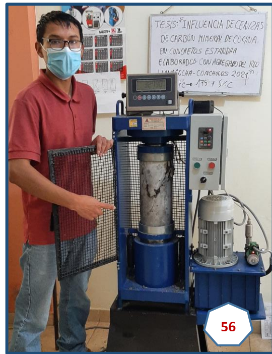
Fotografía N° 56: Ensayo de rotura del Concreto 175 kg/cm 2 MP+5% CCM (28días)
