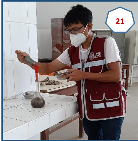
Fotografía N° 21: Llenado de 500gr de muestra al picnómetro.
