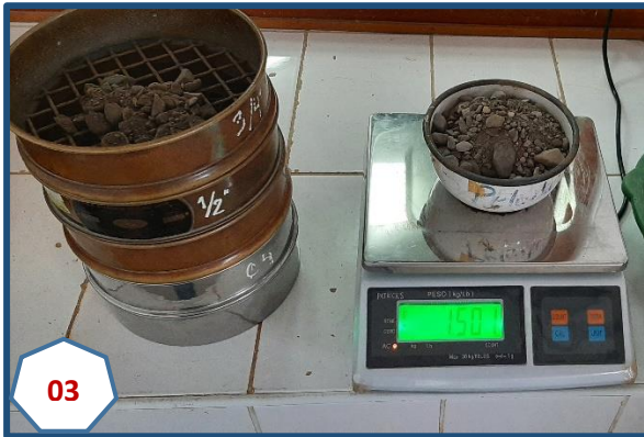
Fotografía N° 03: Peso y tamizado inicial del agregado de río.
