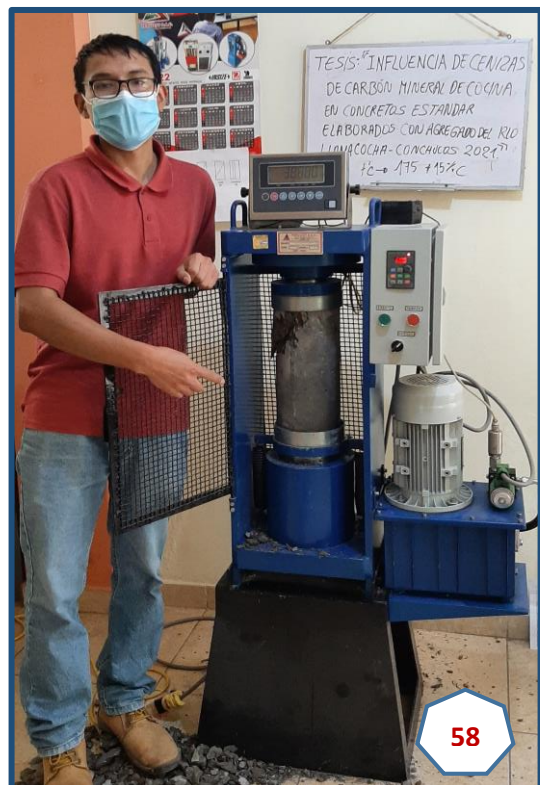
Fotografía N° 58: Ensayo de resistencia a la compresión MP+15% CCM f'c = 175 kg/cm 2 .
