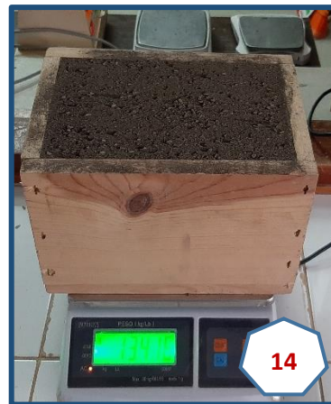
Fotografías N° 12, 13, 14: Realizando el enrasado, varillado y registro del peso obtenido para el cálculo del peso unitario de ambos agregados, en estado suelto y compactado.
