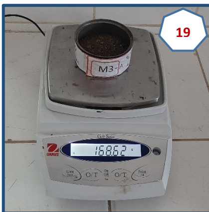
Fotografía N° 19: Toma de muestras de arena e estado SSS y se saca su peso.
