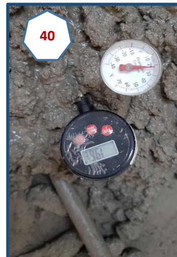
Fotografías N° 39 y 40: Peso del concreto compactado para ensayo de Densidad y Aire, y medición de la temperatura con 2 termómetros.
