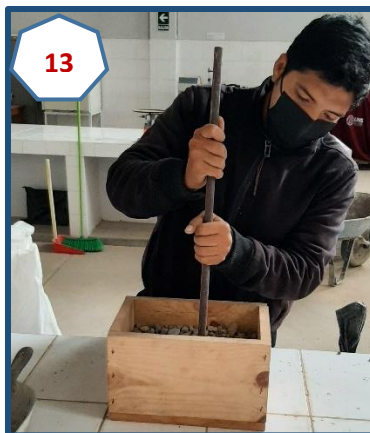
Fotografías N° 12, 13, 14: Realizando el enrasado, varillado y registro del peso obtenido para el cálculo del peso unitario de ambos agregados, en estado suelto y compactado.
