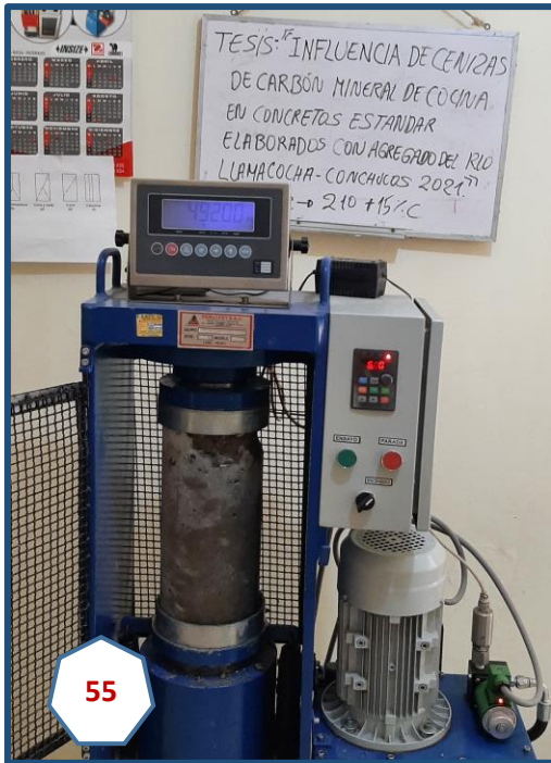
Fotografía N° 55: Ensayo de rotura del Concreto 210 kg/cm 2 MP+15% CCM. (28d)
