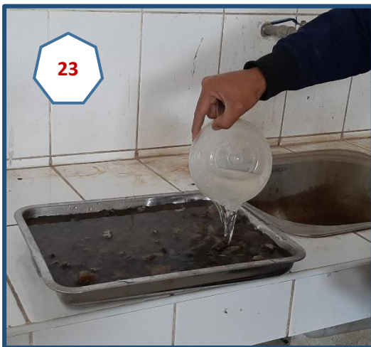
Fotografía N° 23: Se hidrató 24 hr la muestra de piedra para el Ensayo de P.E. y Absorción.
