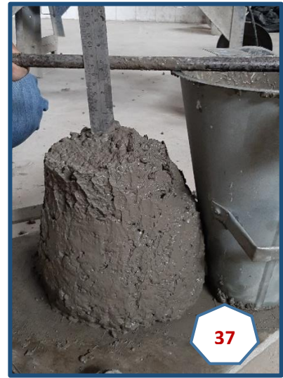
Fotografías N° 35, 36 y 37: Ensayo de Asentamiento del concreto llenando el cono en 3 capas y su respectivo varillado con varilla de 5/8", enrasado y medida del Slump.
