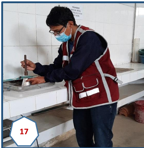
Fotografía N° 17: Procedimiento del llenado de cono con 25 golpes por capa.
