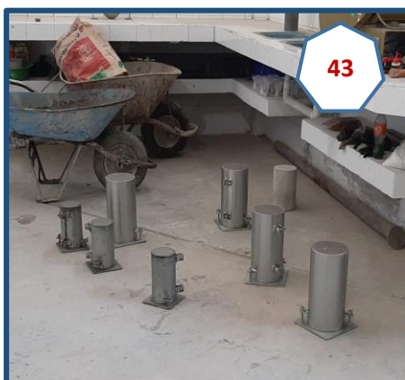
Fotografía N° 43: Tanda de elaboración de probetas 150 mm x 300 mm y 100mmx200mm para muestras patrón.
