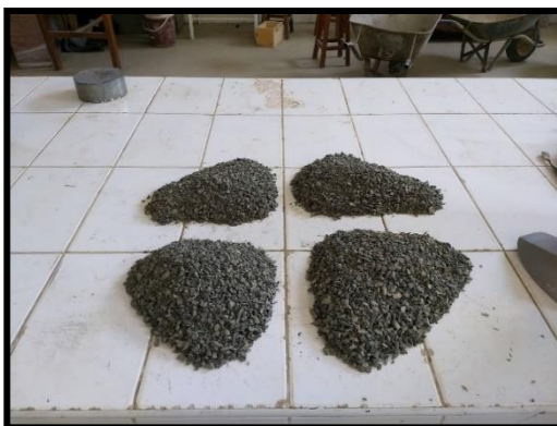
Foto 9. Ensayo de cuarteo del confitillo para ser tamizado.
