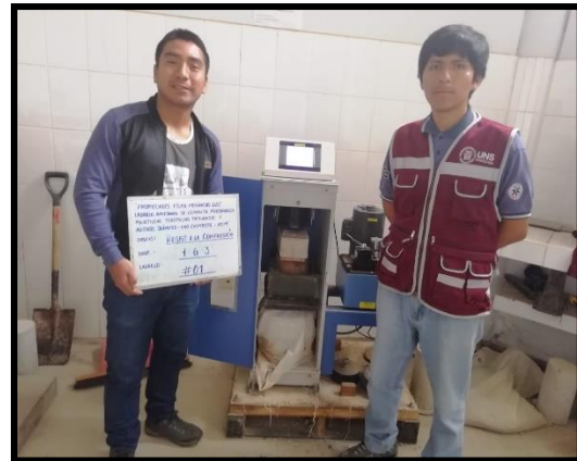
Foto 38. Ensayo de resistencia a la compresión de ladrillo artesanal de cemento (determinación de ladrillo patrón) en la dosificación 1:6:3.
