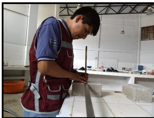
Foto 44. Toma de medidas de dimensiones de los ladrillos elaborados con regla metálica con aproximación a 1 mm.
