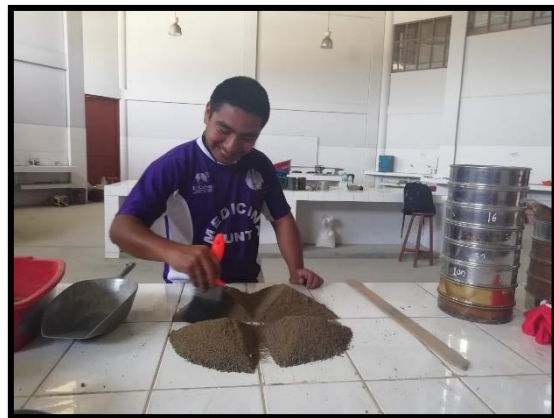
Foto 11. Selección de muestra representativa del agregado fino para el análisis granulométrico.
