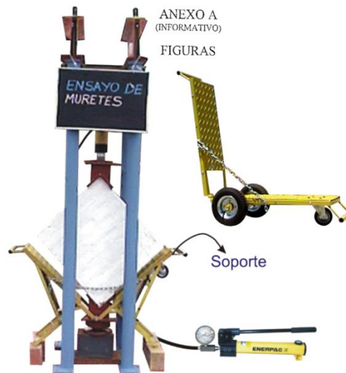
Figura 6 Equipo para ensayo de compresión diagonal en murete de albañilería.
