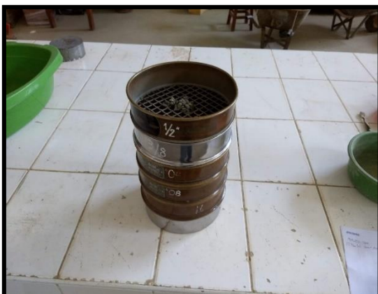
Foto 12. Tamices normalizados para el análisis granulométrico de los agregados.
