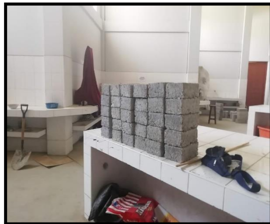
Foto 50. Apilamiento de ladrillos con PET y aditivo acelerante de fragua en distintas dosificaciones para ser ensayados en la máquina de resistencia a la compresión.
