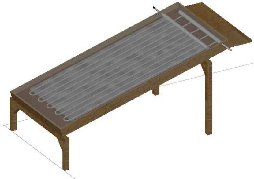
Figura 19: Colector solar de placa de doble paso diseñado por los tesisistas.
