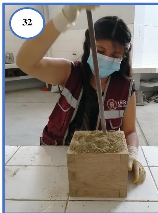
**Fotografía N°31 v N°32:** Apisonando con la varilla compactadora de 5/8" mediante 25 golpes distribuidos uniformemente en cada una de las tres capas.
