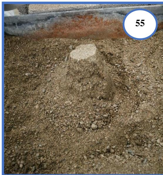
**Fotografía N°55:** Se retira el molde cónico, cuando la muestra de agregado fino se derrumba esto debe cuando la muestra se encuentra saturada superficialmente seca.
