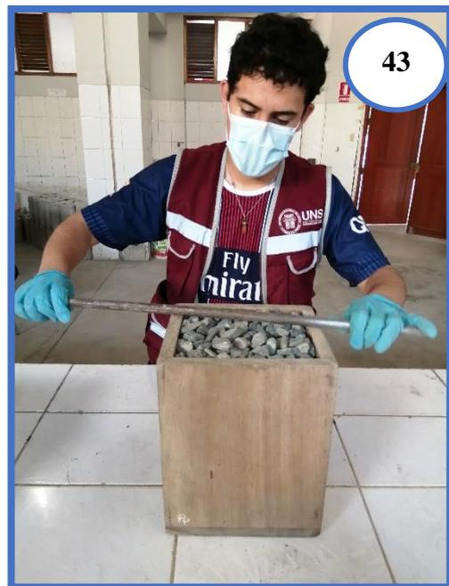
**Fotografía N°42 y N°43:** Enrasando con la ayuda de la varilla compactadora para calcular el peso unitario suelto del Agregado Grueso.
