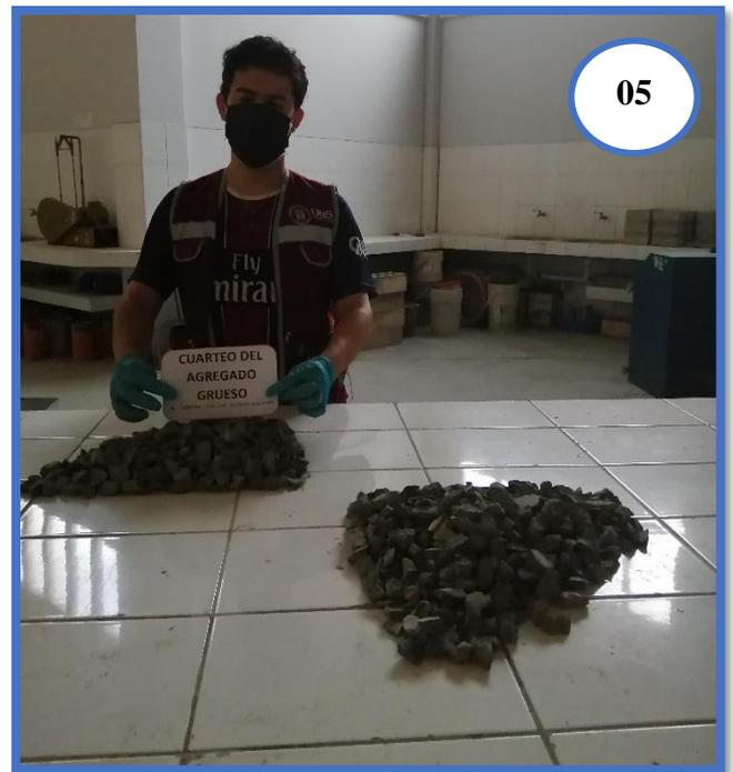
**Fotografía N°04 y N°05:** Realizando el cuarteo del Agregado Grueso.
