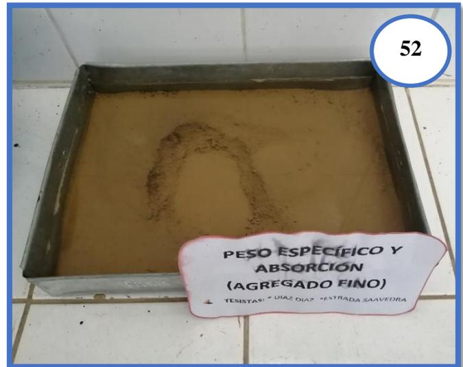
**Fotografía N°51 y N°52:** Recipiente metálico con muestra de Agregado Fino cubierta de agua, está se deja reposar durante 24 horas.
