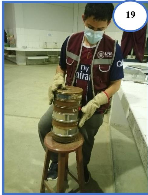
**Fotografía N°19:** Realizando el tamizado manual para luego calcular la granulometría del Agregado Grueso.
