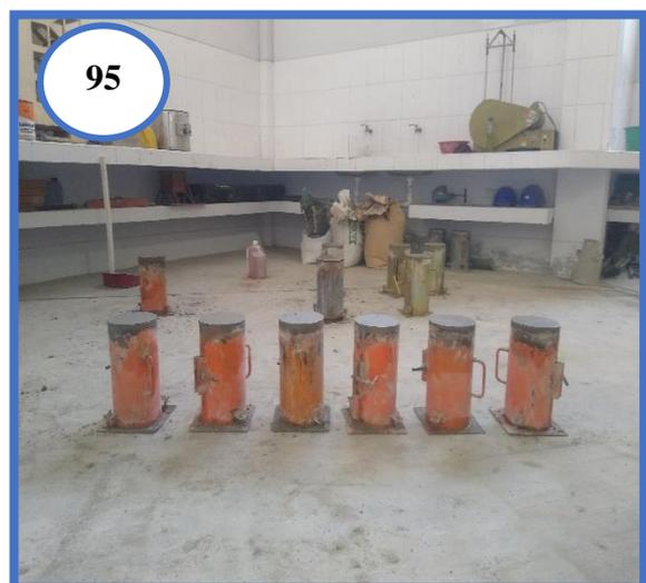
**Fotografía N°94 y N°95:** Fraguado del concreto por 24 horas.
