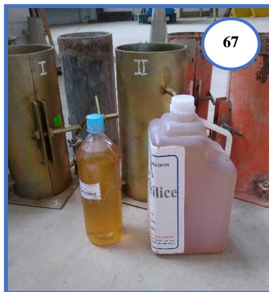
**Fotografía N°67:** Aditivo GAIA Microsílice a utilizar para el ensayo de resistencia a la compresión con sustituciones parciales al 0.3%, 0.8% y 1.3%.
