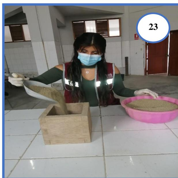
**Fotografía N°23:** Llenando el recipiente cúbico con Agregado Fino con ayuda de un cucharón metálico desde una altura no mayor de 50 mm por encima de la parte superior del recipiente.
