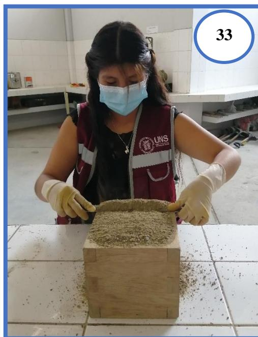
**Fotografía N°33:** Enrasando con la ayuda de una regla metálica para el ensayo de peso unitario compactado del Agregado Fino.
