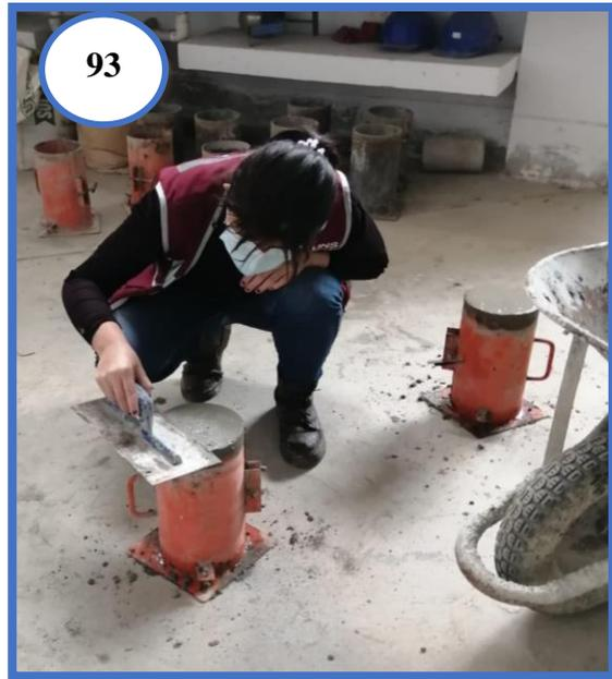
**Fotografía N°92 y N°93:** Enrasando las probetas de concreto.
