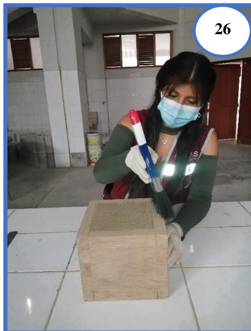
**Fotografía N°26:** Limpiando los bordes del recipiente cúbico para eliminar el exceso de material.
