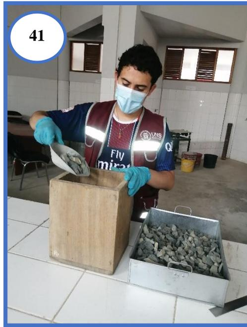
**Fotografía N°41:** Llenando el recipiente cúbico con Agregado Grueso utilizando un cucharón metálico desde una altura no mayor de 50 mm por encima de la parte superior del recipiente.
