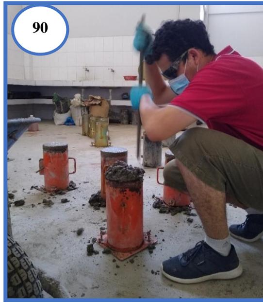
**Fotografía N°90:** Compactando el concreto con la varilla compactadora de 5/8 mediante 25 golpes distribuidos uniformemente en cada una de las 3 capas.
