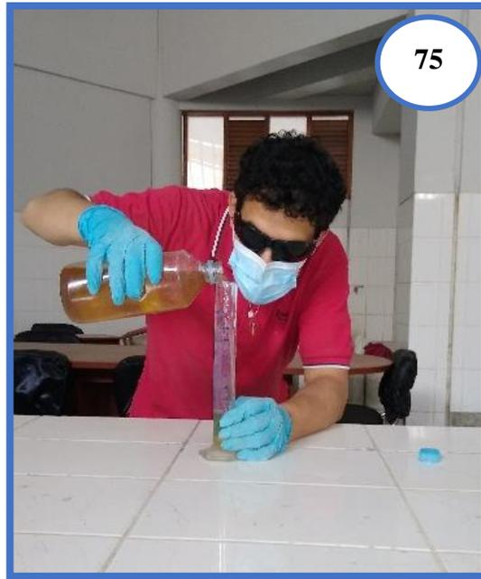
**Fotografía N°75:** Vertiendo la cantidad necesaria de aditivo nanosílice en la probeta graduada.
