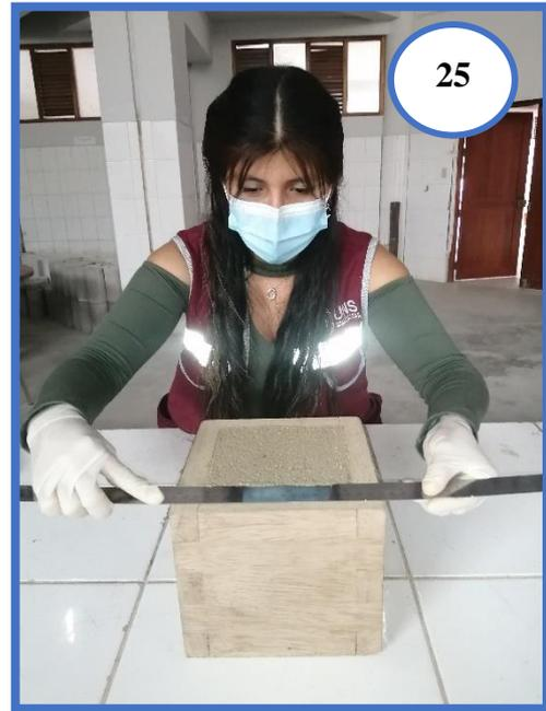
**Fotografía N°24 y N°25:** Enrasando con la ayuda de una regla metálica para calcular el peso unitario suelto del Agregado Fino.
