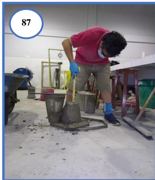
**Fotografía N°86 y N°87:** Midiendo el asentamiento (Slump).
