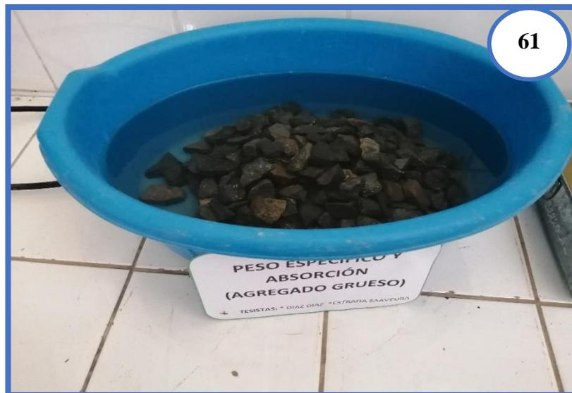
**Fotografía N°61:** Bandeja con muestra de Agregado Grueso cubierta de agua, se deja reposar durante 24 horas.
