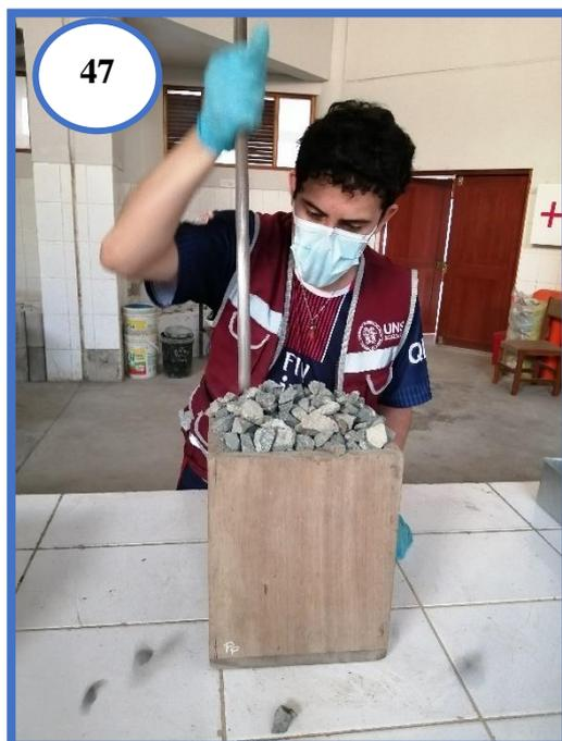
**Fotografía N°46 y N°47:** Apisonando con la varilla compactadora de 5/8" mediante 25 golpes distribuidos uniformemente en cada una de las tres capas.
