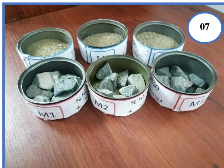
**Fotografía N°07:** Muestras de Agregado Fino y Agregado Grueso para el ensayo de contenido de humedad.
