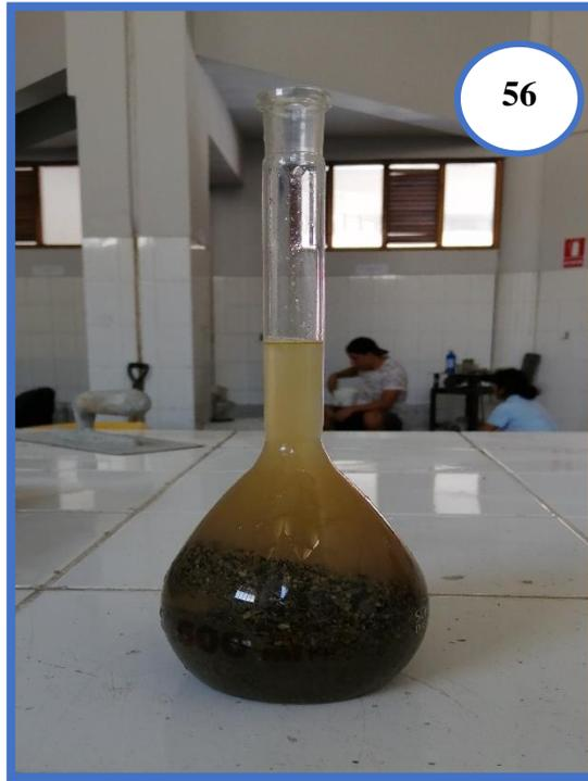
**Fotografía N°56:** Muestra de 500 g de material preparado dentro del frasco volumétrico llenada con agua destilada hasta la marca de enrase.
