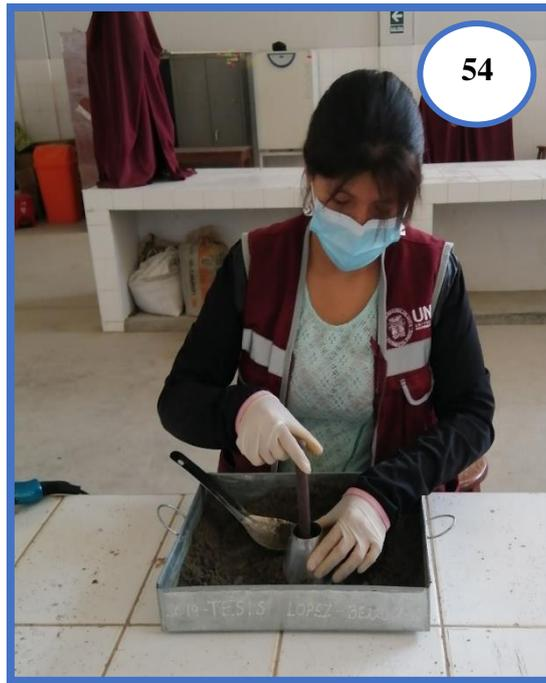
**Fotografía N°54:** La muestra se coloca en el molde cónico para poder apisonar la superficie con 25 golpes distribuidos uniformemente utilizando la varilla compactadora.
