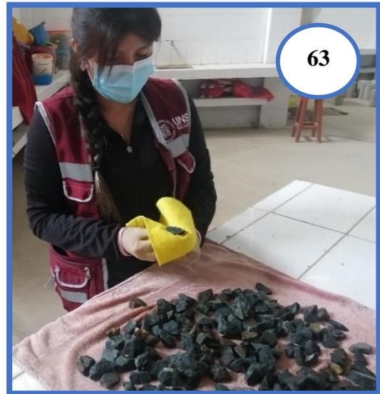
**Fotografía N°62 y N°63:** Se retiró la muestra del agua y se hace rodar sobre una toalla grande y absorbente, se seca separadamente los fragmentos más grandes. Luego se obtiene el peso de la muestra saturada con superficie seca.
