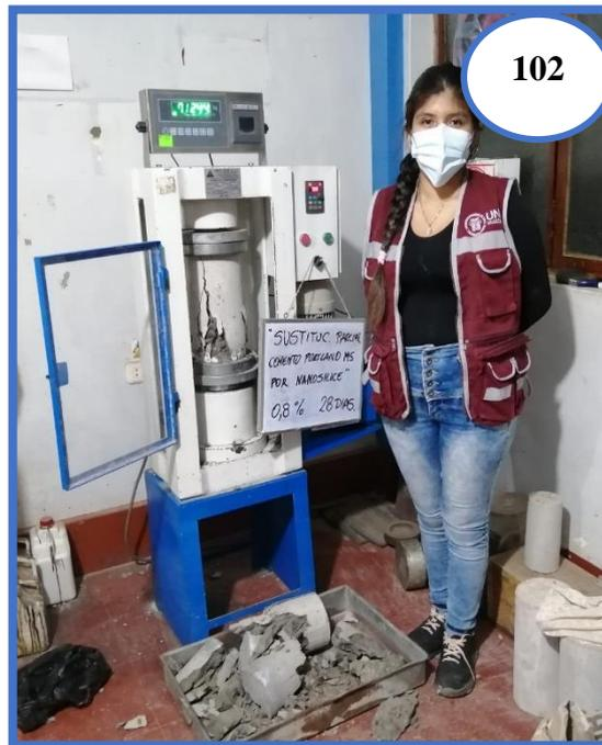
**Fotografía N°102:** Ensayo de resistencia a la compresión de los testigos de concreto (0.8% Nanosílice – 28 días).
