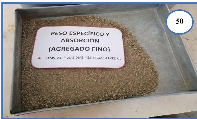
**Fotografía N°50:** Muestra a utilizar para el ensayo de absorción y peso específico del Agregado Fino.
