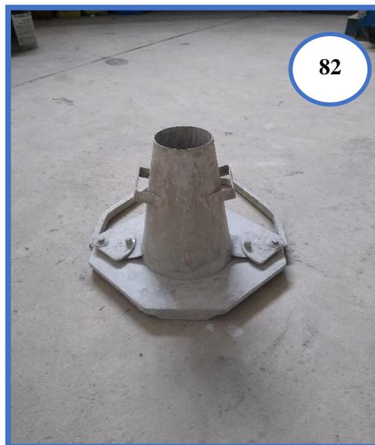
**Fotografía N°82:** Cono de Abrams a utilizar para el ensayo de asentamiento (Slump).
