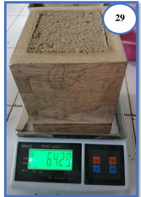
**Fotografía N°27, N°28 y N°29:** Pesando el recipiente cúbico más la muestra suelta para el ensayo de peso unitario suelto del Agregado Fino, se realizó tres veces el ensayo.
