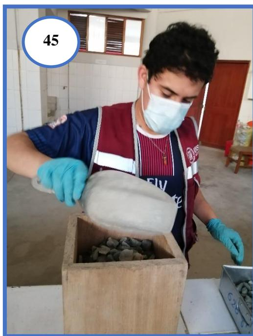
**Fotografía N°45:** Llenando el recipiente cúbico con Agregado Grueso para el ensayo de peso unitario compactado.
