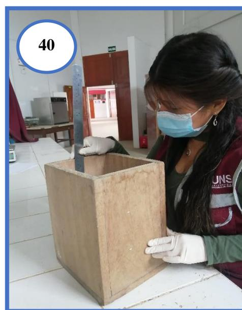
**Fotografía N°39 y N°40:** Realizando las mediciones respectivas para calcular el volumen del recipiente cúbico para el ensayo de peso unitario suelto y compactado del Agregado Grueso.
