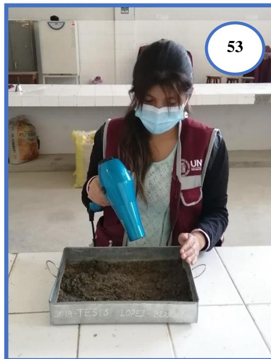
**Fotografía N°53:** Agregado fino extendido sobre un recipiente plano expuesta a una corriente de aire tibio para el secado uniforme.
