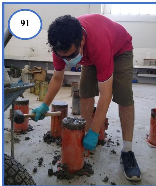
**Fotografía N°91:** Vibrado del concreto utilizando el martillo de goma.
