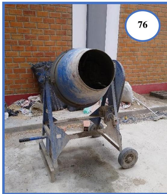
**Fotografía N°76:** Mezcladora de concreto lista para utilizarse.
