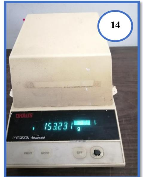
**Fotografía N°12, N°13 y N°14:** Pesando las taras más muestras de suelo para el ensayo de contenido de humedad del agregado grueso.
