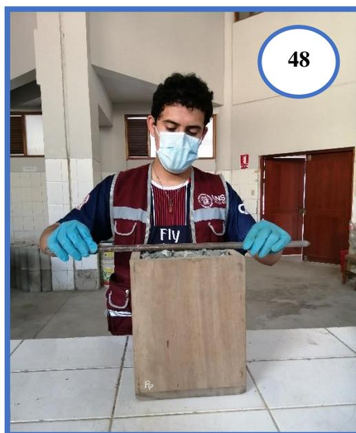
**Fotografía N°48:** Nivelando con la ayuda de la varilla compactadora para el ensayo de peso unitario compactado del Agregado Grueso.
