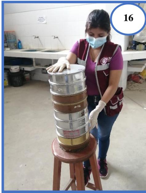
**Fotografía N°16:** Realizando el tamizado manual para luego calcular la granulometría del Agregado Fino.
