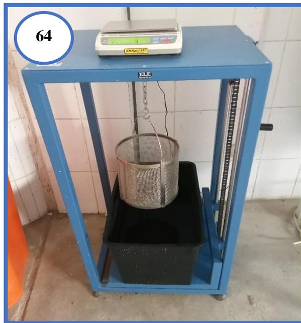
**Fotografía N°64:** Canastilla metálica a utilizar para el ensayo de peso específico y absorción.
