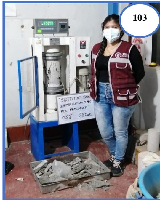
**Fotografía N°103:** Ensayo de resistencia a la compresión de los testigos de concreto (1.3% Nanosílice – 28 días).
