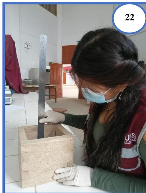
**Fotografía N°21 y N°22:** Realizando las mediciones respectivas para calcular el volumen del recipiente cúbico para el ensayo de peso unitario suelto y compactado del Agregado Fino.
