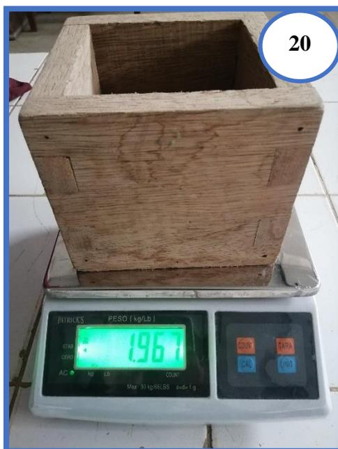
**Fotografía N°20:** Pesando el recipiente cúbico para realizar el ensayo de peso unitario suelto y compactado del Agregado Fino.
