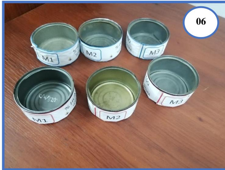
**Fotografía N°06:** Taras limpias que se utilizarán para el ensayo de contenido de humedad.
