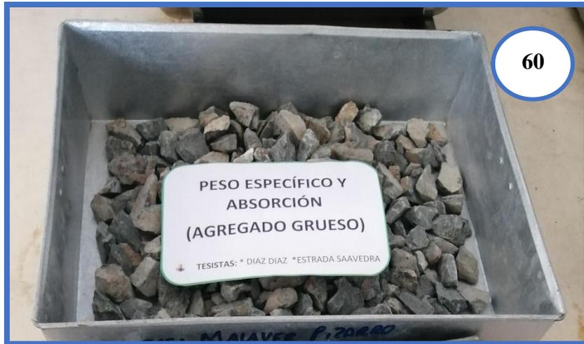
**Fotografía N°60:** Muestra a utilizar para el ensayo de absorción y peso específico del Agregado Grueso.
