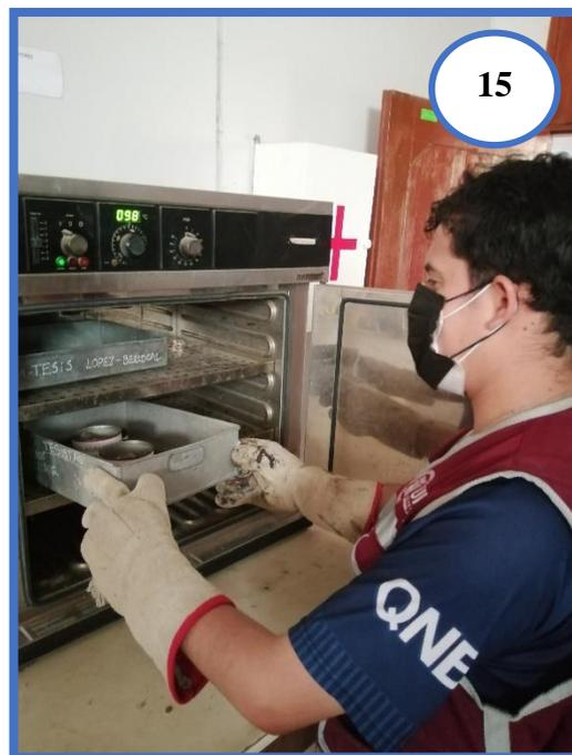
**Fotografía N°15:** Poniendo al horno las muestras de suelo de Agregado Grueso para el ensayo de contenido de humedad.
