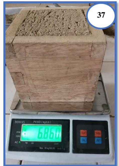
**Fotografía N°35, N°36 y N°37:** Pesando el recipiente cúbico más la muestra compactada para el ensayo de peso unitario compactado del Agregado Fino, se realizó tres veces el ensayo.
