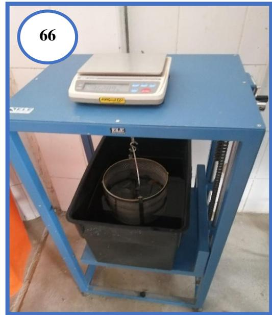
**Fotografía N°65 y N°66:** Se coloca la muestra al interior de la canastilla metálica y se determina su peso sumergido en el agua, se seca la muestra a una temperatura entre  $100^{\circ}\text{C} \pm 5^{\circ}\text{C}$  y se deja enfriar a temperatura ambiente, durante 2 horas luego se procede a pesar.
