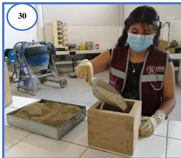
**Fotografía N°30:** Llenando el recipiente cúbico con Agregado Fino para el ensayo de peso unitario compactado.
