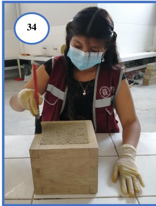
**Fotografía N°34:** Limpiando los bordes del recipiente cúbico para eliminar el exceso de material.
