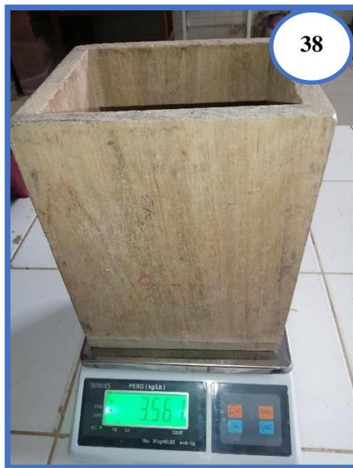
**Fotografía N°38:** Pesando el recipiente cúbico para realizar el ensayo de peso unitario suelto y compactado del Agregado Grueso.
