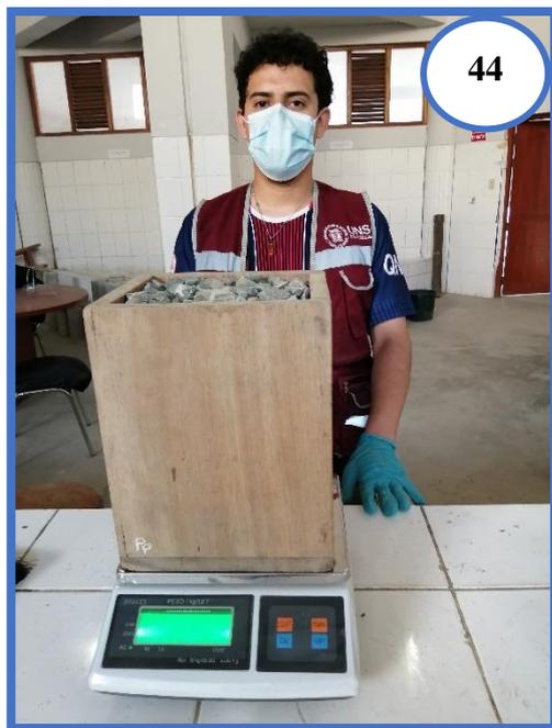
**Fotografía N°44:** Pesando el recipiente cúbico más la muestra suelta para el ensayo de peso unitario suelto del Agregado Grueso.
