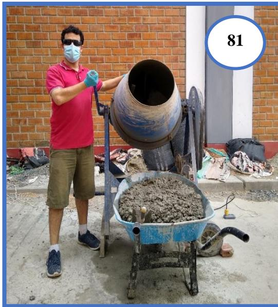
**Fotografía N°81:** Mezcla de concreto lista para ser vaciada a las probetas cilíndricas.
