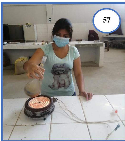
**Fotografía N°57:** Eliminando las burbujas de aire haciendo uso de una cocina eléctrica.
