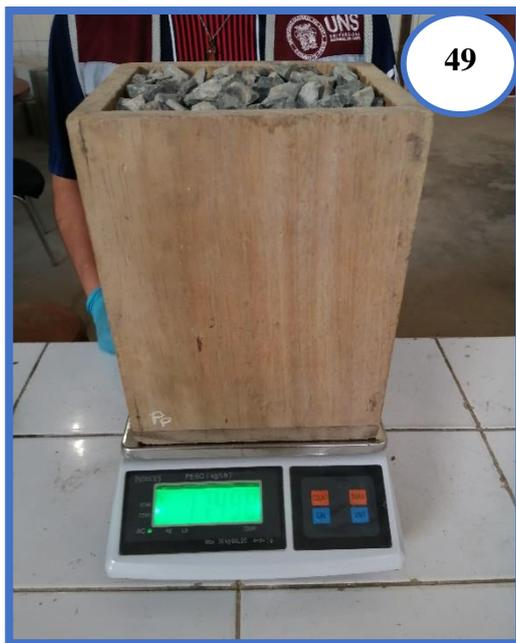
**Fotografía N°49:** Pesando el recipiente cúbico más la muestra compactada para el ensayo de peso unitario compactado.
