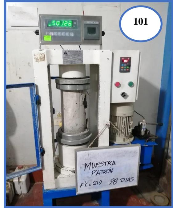
**Fotografía N°100 y N°101:** Ensayo de resistencia a la compresión de los testigos de concreto (muestra patrón – 28 días).
