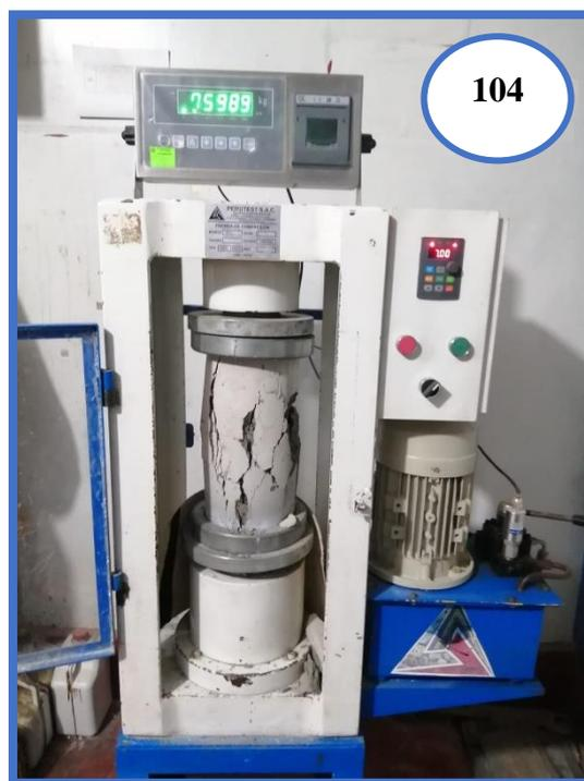
**Fotografía N°104:** Ensayo de resistencia a la compresión de los testigos de concreto (0.8% porcentaje óptimo de nanosílice– 28 días).
