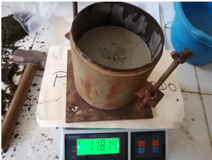
Foto 04.- Pesado de Molde CBR.
