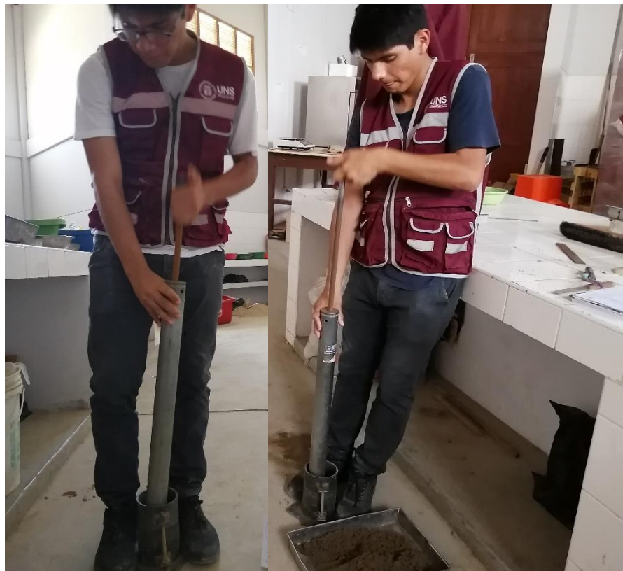
Figura 20. Ensayo para determinar el grado de compactación
