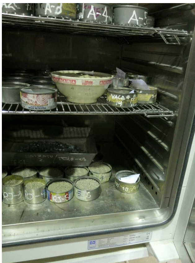
Figura 15. Iniciación del proceso de secado de la muestra de suelo
