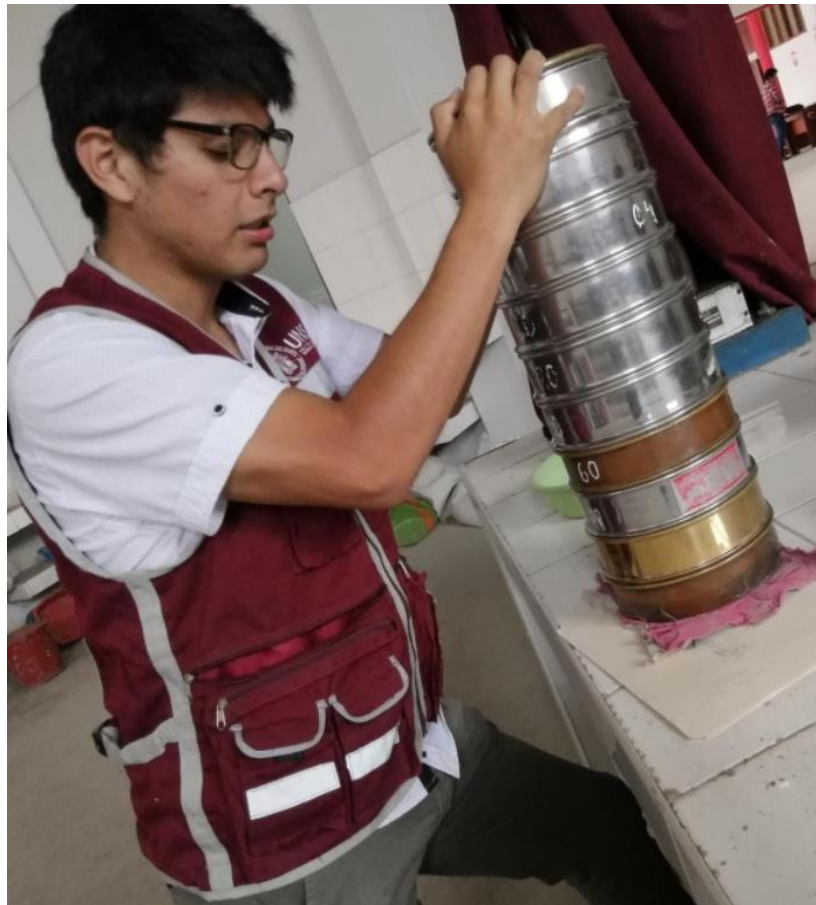
Figura 16. Proceso de tamizado de la muestra de suelo
