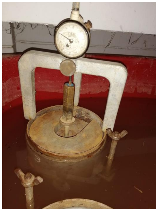
Foto 10.- Dial para medir la expansión de la muestra de suelo.
