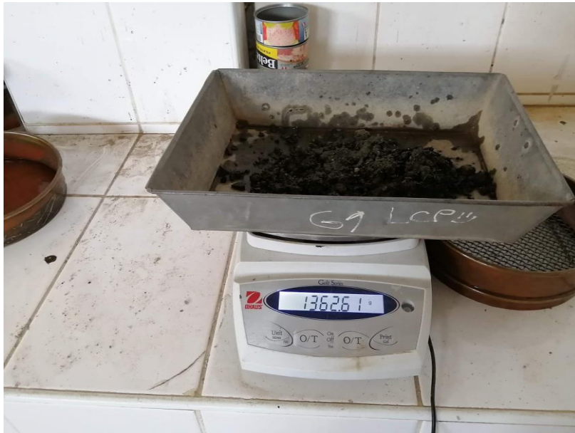
Foto 07.- Pesado de muestras para determinar la curva granulométrica
