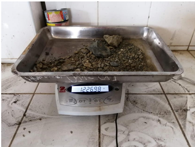
Foto 08.- Pesado de muestras para determinar la curva granulométrica
