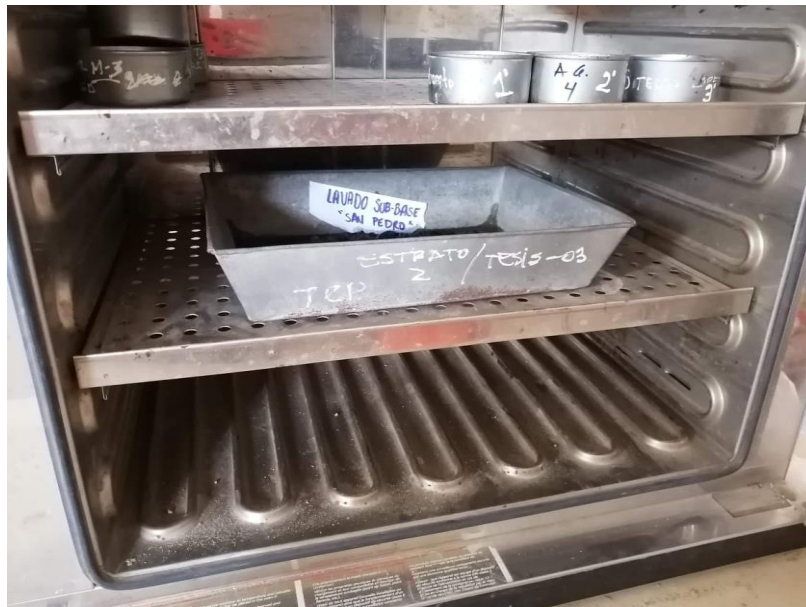
Foto 06.- Secado de muestras para determinar el contenido de Humedad
