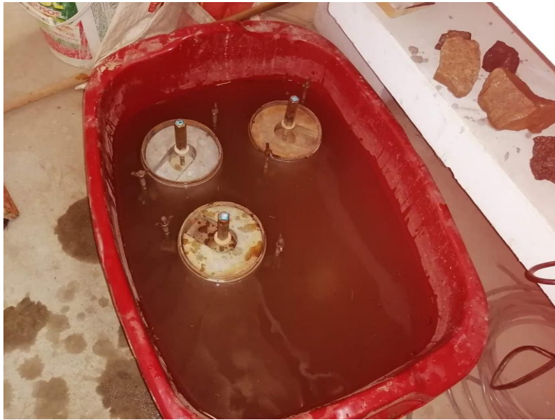
Foto 09.- Moldes CBRs Sumergido en agua por 72 horas para su posterior ensayo
