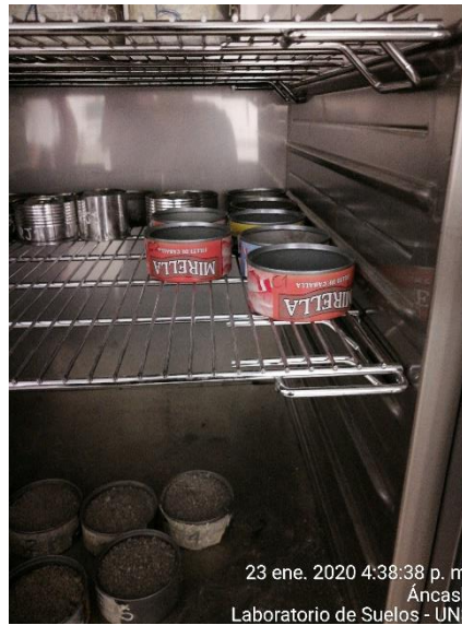
Figura 6. Horno para determinar el contenido de humedad de la muestra
