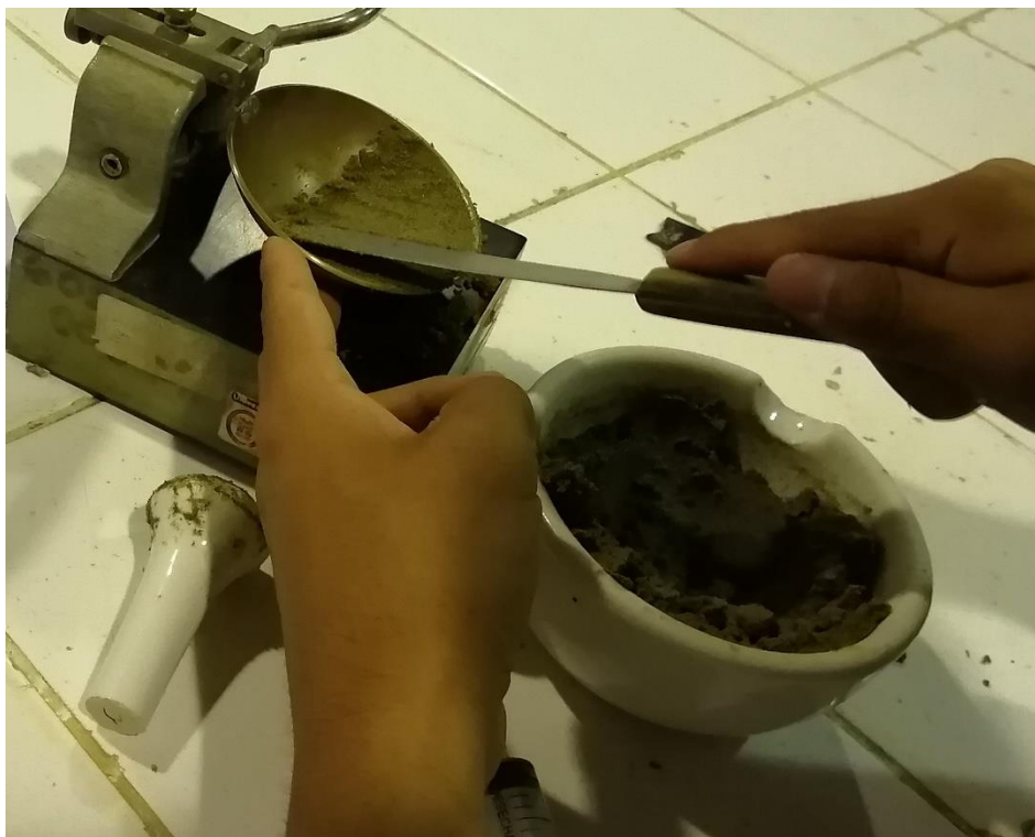
Figura 11. Equipo para determina la consistencia de una muestra de suelo - Copa Casagrande
