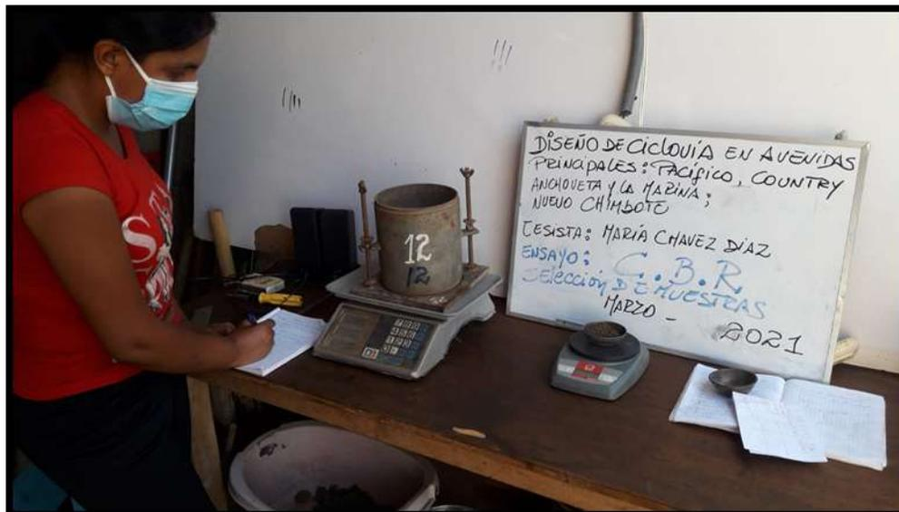
**Foto N°36:** Pesaje de molde para realizar el CBR.
