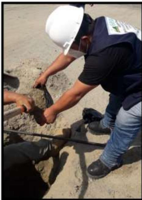
**Foto N°25:** Toma de muestra de uno de los estratos de la calicata C-01.
