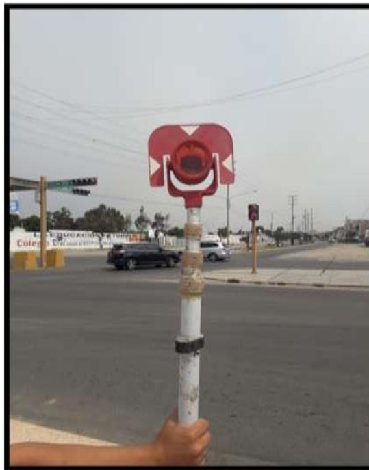
**Foto N°16 y Foto N°17:** En la Foto N° 16 muestra el trípode para la Estación Total. En la Foto N°17 se observa el prisma utilizado para el Levantamiento Topográfico.
