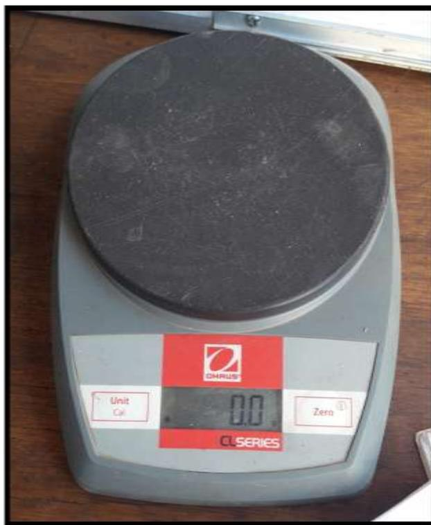
**Foto N°31:** Balanza Gramera para el pesaje de las taras.
