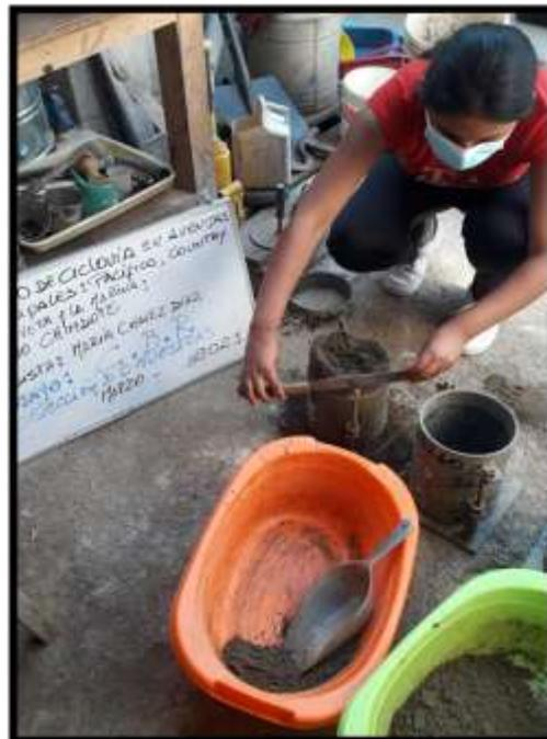
**Foto N°40:** Se muestra el rasado de la muestra en uno de los moldes.
