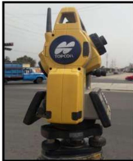
**Foto N°18 y Foto N°19:** En las fotos N°06 y N°07 se muestra a la Estación Total TOPCON – ES 105 utilizada para el Levantamiento Topográfico.
