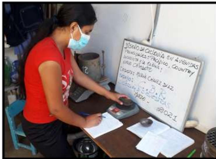
**Foto N°42:** Pesaje de la tara más muestra para el contenido de humedad del CBR.
