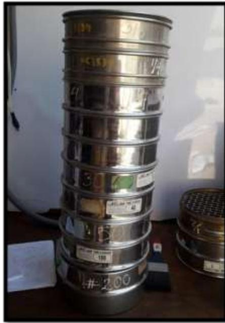
**Foto N°29:** Tamices para el Análisis Granulométrico.
