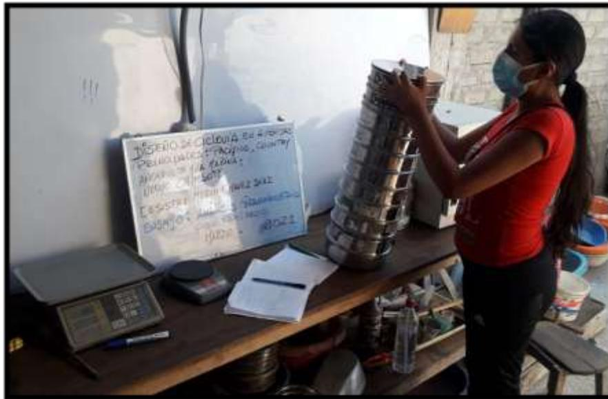
**Foto N°34:** Tamizaje de la muestra de suelo de cada calicata para el Análisis Granulométrico.
