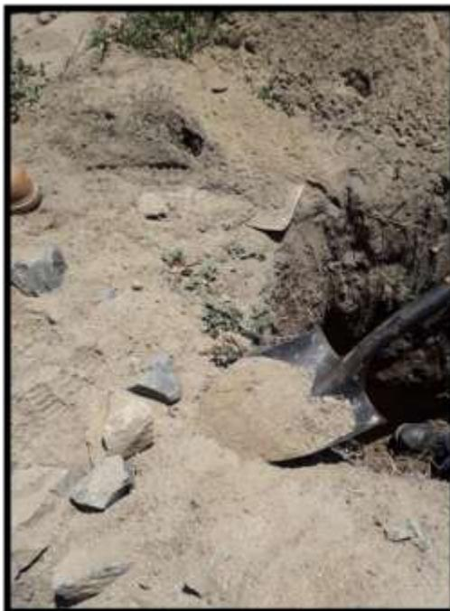
**Foto N°28:** Durante la excavación de la calicata C-04 se encontró piedra angulosa de 2”-4” alistada.
