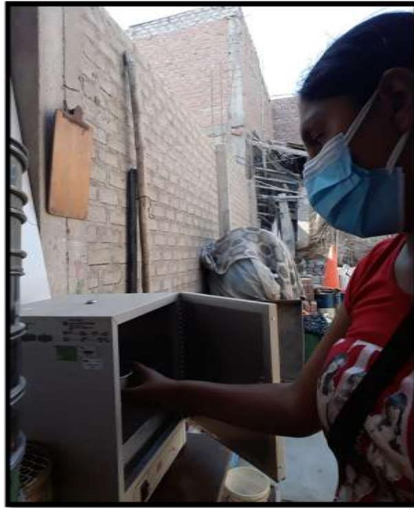
**Foto N°33:** Colocación de taras con muestras para la obtener el Contenido de Humedad.
