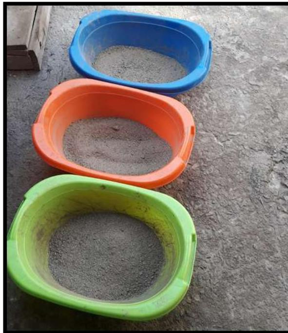
**Foto N°35:** Separación en partes iguales de la muestra obtenida en la Avenida Country para CBR.
