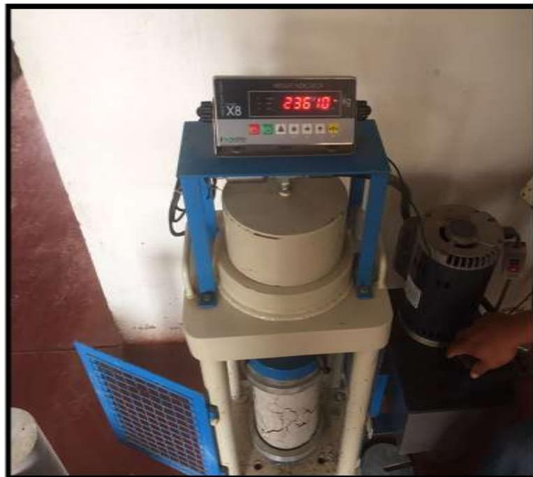
**Foto N°50 y Foto N° 51:** Se muestra una lectura después de rotura de una Probeta.
