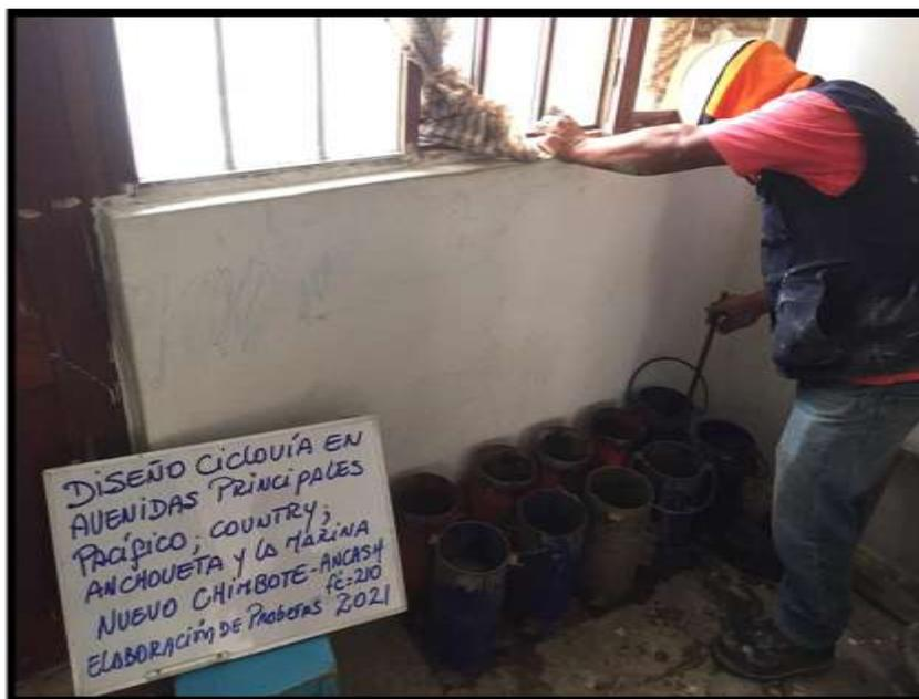
**Foto N°48:** Varillado del concreto con  $F'c=210$  en los moldes para Probetas.
