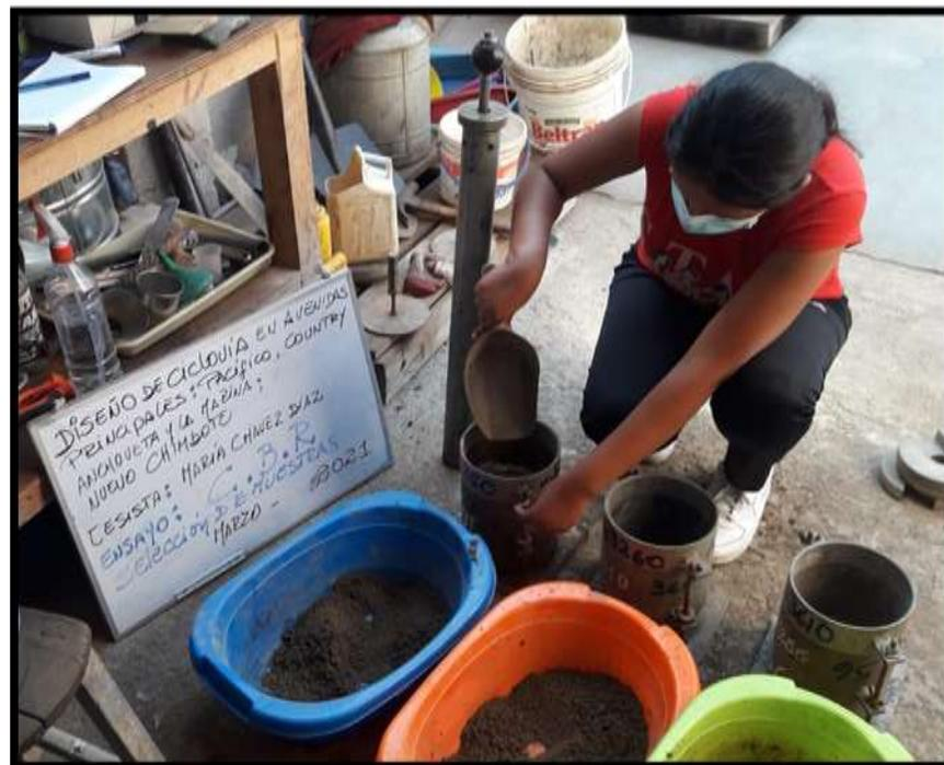
**Foto N°38:** Se muestra como se hecho en los moldes las muestras saturadas.
