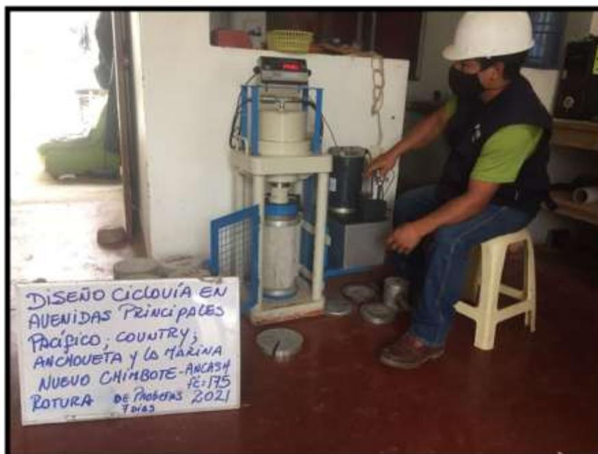
**Foto N°49:** Rotura de una Probeta con concreto de  $F'c = 175$  kg/cm<sup>2</sup>.
