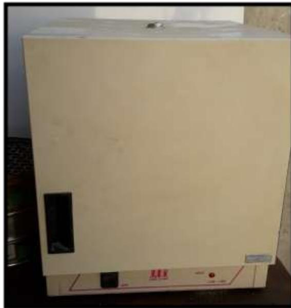
**Foto N°30:** Horno usado para obtener el Contenido de Humedad.
