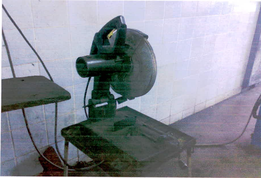
Foto 7: Cortadora de mangueras hidráulicas – Área Hidráulica
