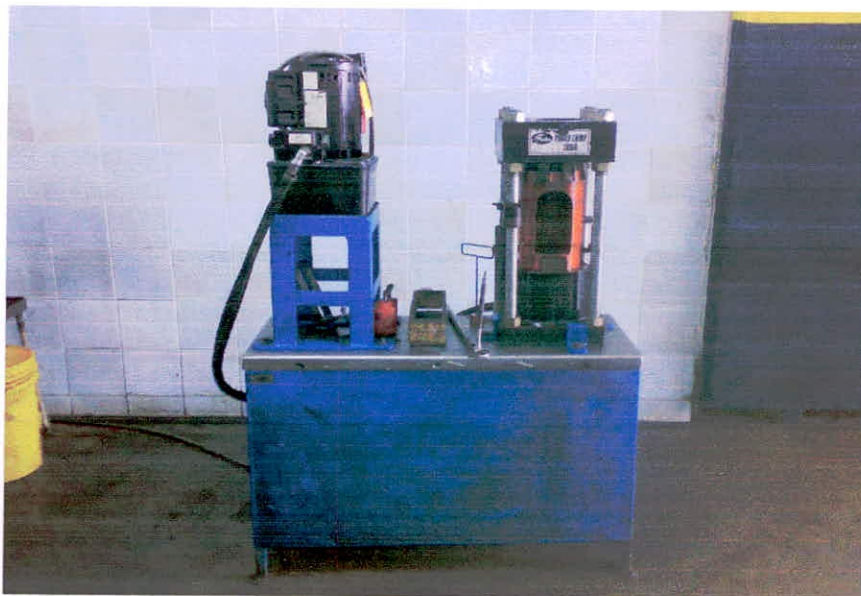
Foto 8: Prensadora de mangueras hidráulicas –Área Hidráulica
