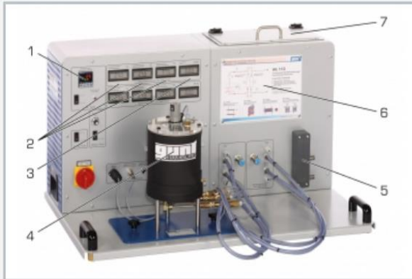
1 regulador de temperatura, 2 indicadores de temperatura, 3 indicadores de caudal, 4 depósito de agitación con doble camisa y serpentín WL 110.04, 5 tomas del circuito de agua fría, 6 esquema de proceso, 7 depósito para agua caliente
