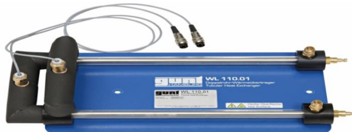
Figura 14. Intercambiador de calor de tubos concéntricos WL. 110.01.
