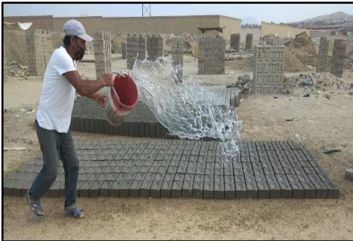
**FOTOGRAFIA N°04:** Posteriormente se realiza el moldeado de los ladrillos, y se prosigue con el tendido de las unidades, para luego curarlas con agua.
