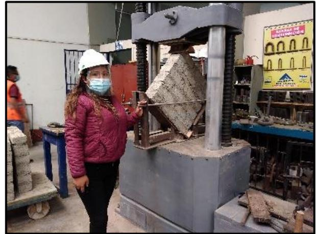
**FOTOGRAFIA N°49:** Se visualiza la falla en el murete correspondiente con los ladrillos de adición de limalla al 25%, con respecto al volumen del agregado preparado.
