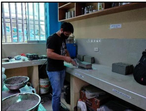
**FOTOGRAFIA N°40:** Se realizó el ensayo de resistencia a la compresión axial (pilas), de 28 días de su elaboración de las unidades.
