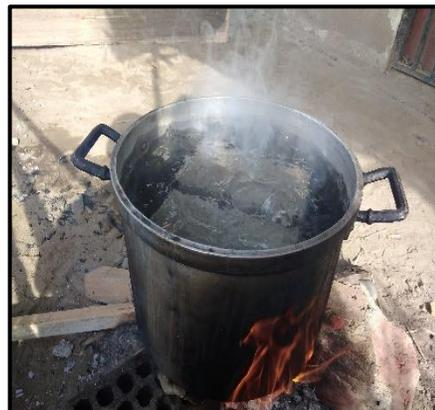
**FOTOGRAFIA N°39:** Se realizó el ensayo de absorción y absorción máxima, de 28 días de su elaboración de las unidades.
