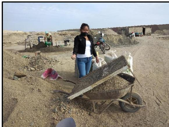
**FOTOGRAFIA N°22:** Se recogió los agregados de la ladrillera: "Asociación de ladrilleros de San Luis", provenientes de la cantera Vesique. el agregado global se pasó por una malla de 3/8.
