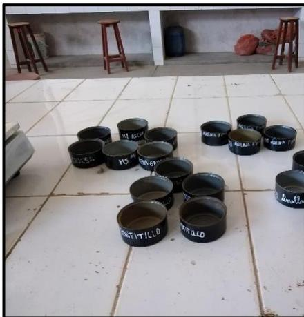
**FOTOGRAFIA N°08:** se realizó el ensayo de contenido humedad del: agregado global, arena fina, confitto y limalla.
