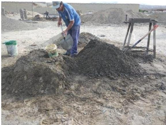
**Figura 08.** *Mezclado de los componentes del ladrillo en húmedo.*
