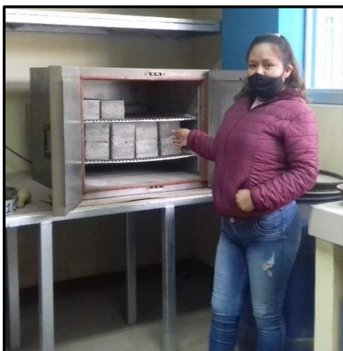
**FOTOGRAFIA N°36:** Se llevaron las unidades de albañilería al horno para su secado.
