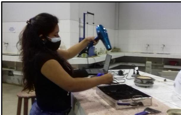
**FOTOGRAFIA N°17:** Previamente se pesaron las muestras en una balanza, para luego hidratarlos, y proceder a secar a una consistencia adecuada.
