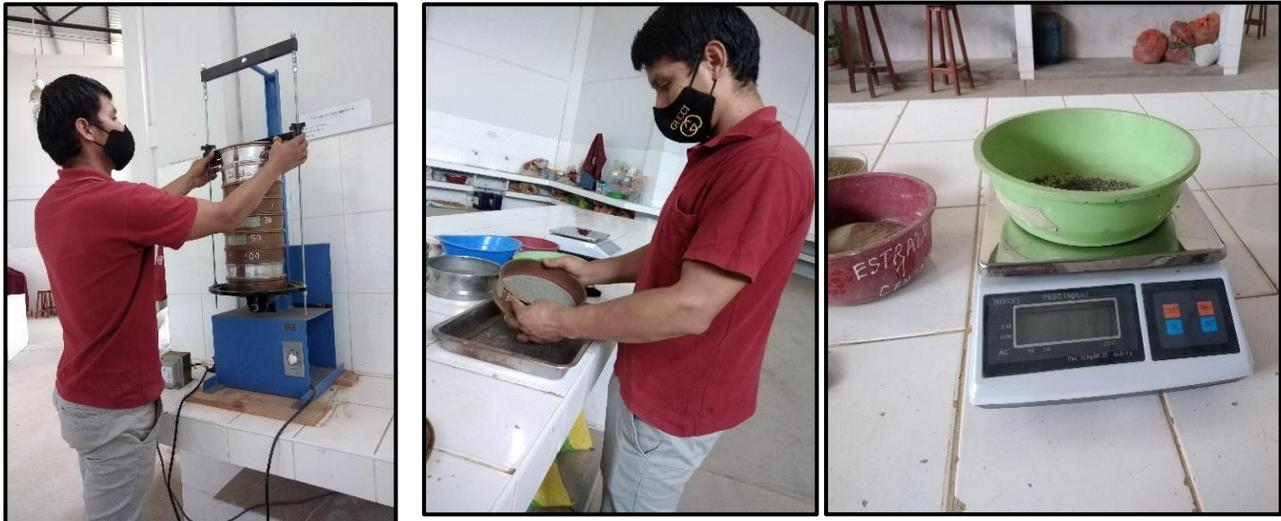
**FOTOGRAFIA N°15:** Se realizó el ensayo de granulometría de agregado global, arena fina, confitillo y limalla.
