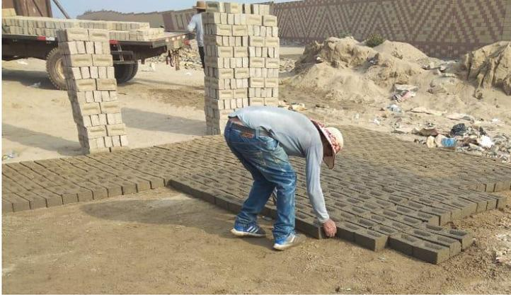
**Figura 11.** *Tendido de los ladrillos*
