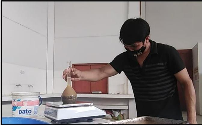
**FOTOGRAFIA N°20:** Se incorporó la muestra en la fiola con agua destilada y se procedió a pesarlo.
