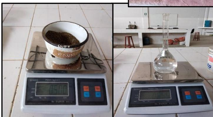
**FOTOGRAFIA N°19:** Se pesaron las muestras de los agregados y también el agua destilada en la fiola.
