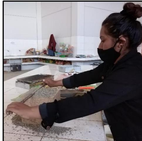
**FOTOGRAFIA N°14:** Se realizó el ensayo de peso unitario compacto del agregado global, arena fina, confitillo y limalla.
