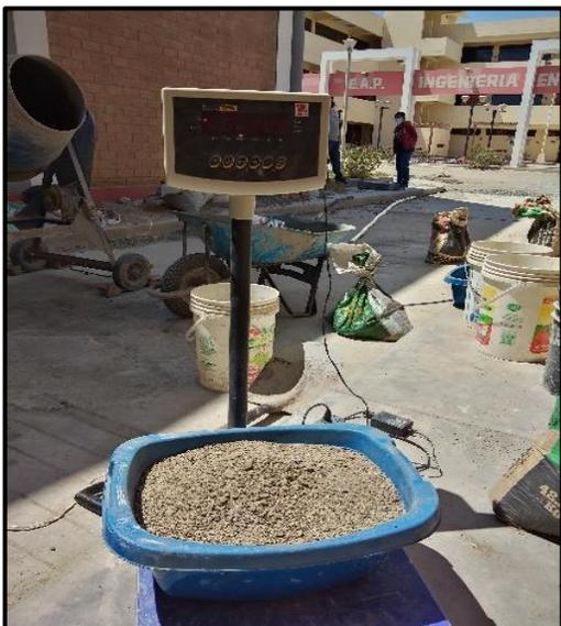
**FOTOGRAFIA N°23:** Se dosifico el concreto, por kilogramo, para elaborar las unidades.
