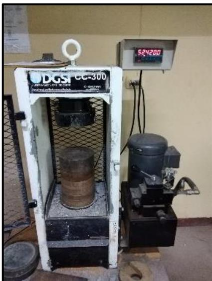
**FOTOGRAFIA N°42:** Se realizó el ensayo de resistencia a la compresión axial (pilas), de 28 días de su elaboración de las unidades.
