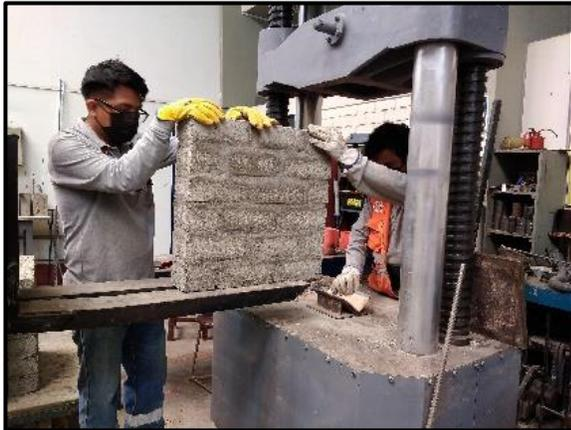
**FOTOGRAFIA N°45:** Se acomodaron los muretes en la maquina con cuidado por los técnicos del laboratorio.
