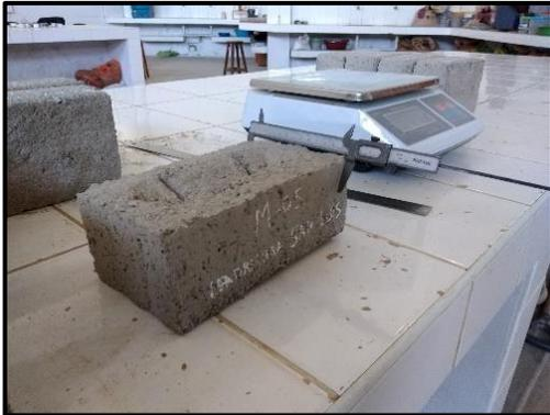
**FOTOGRAFIA N°30:** Se realizó el ensayo de variación dimensional después de 28 días de su elaboración de las unidades
