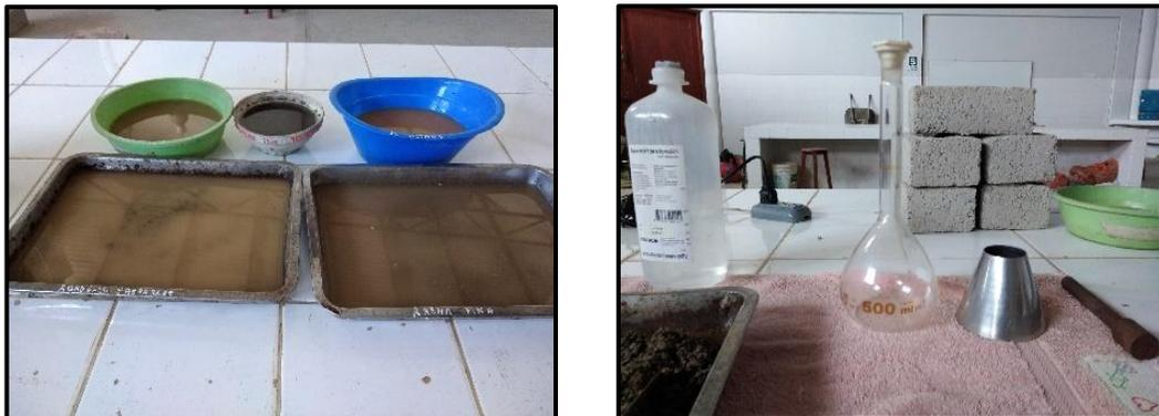
**FOTOGRAFIA N°16:** Se realizó el ensayo de peso específico de agregado global, arena fina, confitillo y limalla.
