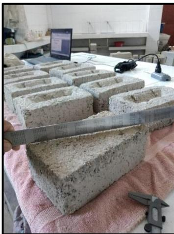
**FOTOGRAFIA N°32:** Se realizó el ensayo de alabeo después de 28 días de su elaboración de las unidades.
