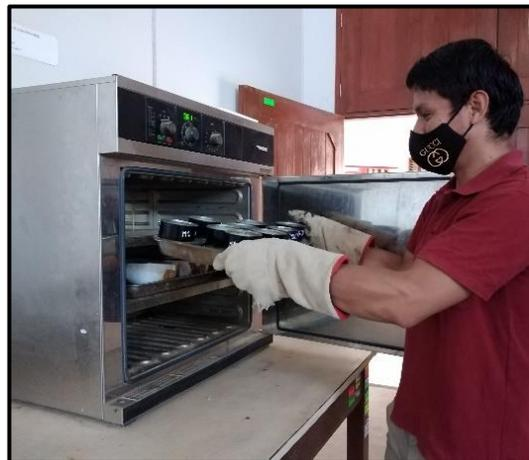
**FOTOGRAFIA N°10:** Luego de sacar las muestras del horno se procedió a pesar las muestras en la balanza.
