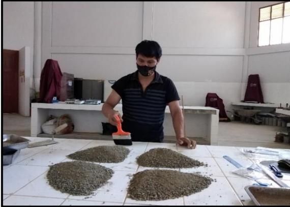
**FOTOGRAFIA N°06:** Se realizó el cuarteo respectivo a los agregados (agregado global, arena fina, confitto), y limalla.
