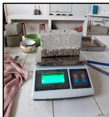
**FOTOGRAFIA N°38:** Se realizó el ensayo succión después de 28 días de su elaboración de las unidades.
