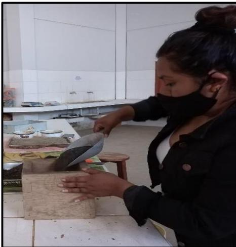
**FOTOGRAFIA N°13:** Se prosiguió al llenado del material suelto en el molde, luego se pesó en la balanza.
