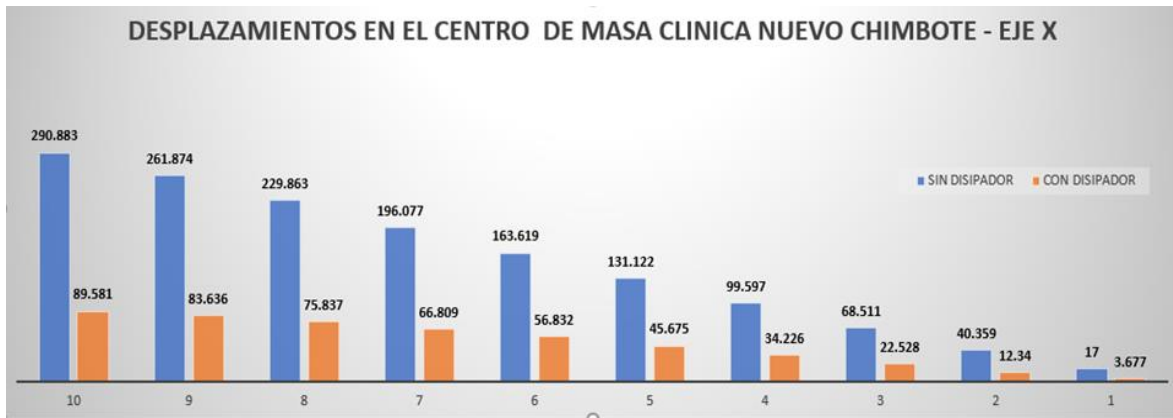
Figura 23. Desplazamientos en el centro de masa del edificio sin disipadores vs edificio con disipadores en el eje X
